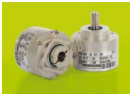
Die Drehgeber sind zugelassen für eine maximale Drehzahl von 12.000 Umdrehungen pro Minute. Die maximale zulässige Belastbarkeit der Welle liegt axial bei 100 N und radial am Wellenende bei 125 N bei Vollwellengeräten bzw. 140 N bei Varianten mit Hohlwelle. Am Gehäuse erfüllt der Drehgeber die Schutz-
