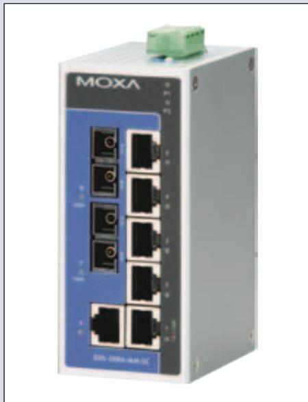
Der unmanaged Ethernet Switch EDS-208-M-SC wurde für raue industrielle Umgebungen entwickelt und ist für Hutschienenmontage vorgesehen. Die sieben RJ45 Ports unterstützen 10/100M Voll-/Halbduplex und automatische MDI/MDI-X-Erkennung. Ein zusätzlicher 100BaseFX
