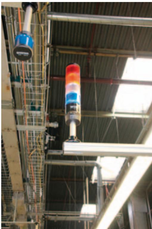
Die Firma TRW Automotive setzt auf Signalgeräte von Werma. Zur Visualisierung von Maschinendaten hat der Automobilkonzern Großbildschirme an unterschiedlichen Stationen im Unternehmen anbringen lassen (Bild links). Im rechten Bild: Die Werma-Signalsäule zur Maschinendatenüberwachung in der TRW-Niederlassung Blumberg.
