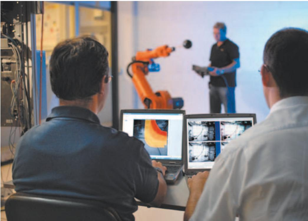
**Bild 2: Aktuelle elektronische Sensorsysteme, wie das sichere Kamerasystem SafetyEYE von Pilz, sind wesentlich leistungsfähiger und stellen deutlich mehr Informationen zur Verfügung als ein rein binäres Schaltsignal. (Pilz GmbH & Co. KG)**
