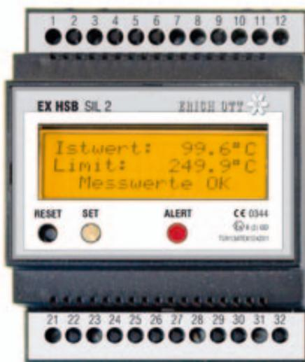
Der neue Sicherheitstemperaturbegrenzer EX HS STB der Erich Ott e.K. für die Hutschieneinstallation in Messwarten und Schaltanlagen bietet sichere Temperaturbegren-
