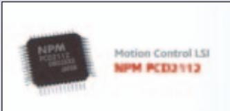
Die PCD2112 Serie für Schritt- oder Servomotoren umfasst einen 4-adrigen seriellen Bus und erweiterte Funktionen in einem Minigehäuse und ermöglicht damit kompaktere Baumaße der Steuerplatine. Der Impulsgeber kann durch Anschluss an ein externes EEPROM auch ohne eine CPU im Standalone-Modus betrieben werden. Der Speicher umfasst bis zu 32 Bedienmuster. Diese Merkmale machen diese Schaltung zur ultimativen tragbaren Bewegungssteuerung
