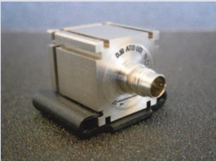
Der AT/13 ist ein piezoelektrischer dreiaxiger Miniaturbeschleunigungsaufnehmer mit integrierter Elektronik (IEPE) zur Befestigung mittels Klebstoff oder Montage-Clip und einer Masse von 29 Gramm.
