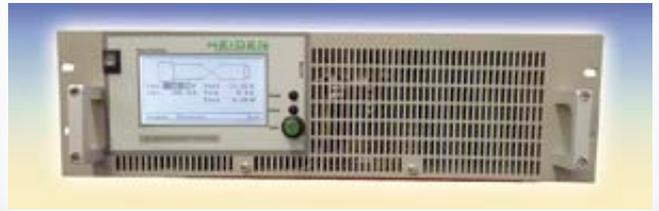
Das von Heiden entwickelte und produzierte Hochleistungs Akku Stütz- und Ladegerät 1155 mit 1200 Watt wurde komplett überarbeitet und für einen speziellen Anwendungsfall neu angepasst. Entgegen der üblichen 230 VAC Versorgung ist dieses Gerät für eine Eingangsspannung von 560 VDC ausgelegt worden. Die Ausgangsspannung beträgt 12 VDC und kann bis 15,5 V programmiert werden. Das mit intelligentem Ladecomputer und LCD-Anzeige ausgestattete Ladegerät kann sowohl als Bordnetz-Nachbildung, als
