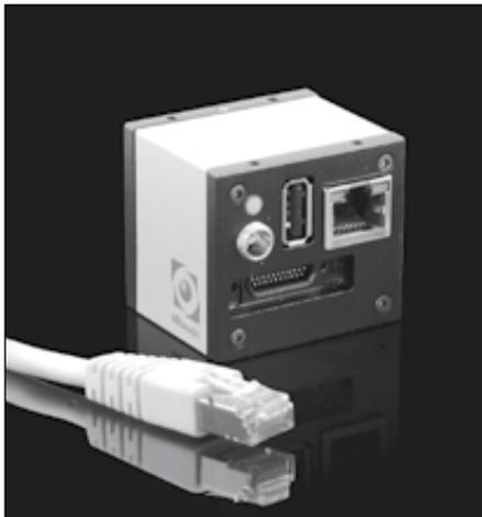
Die intelligenten, Linux-basierten Kameras und Analog-Video-Konverter von VRmagic können nun auch bearbeitete Bilddaten komfortabel über Ethernet übertragen. Möglich ist dies durch die Integration eines Plug-Ins für die Open-Source-Bibliothek GStreamer in das VRmagic Software-Development-Kit. GStreamer ist eine plattformübergreifende Programmierschnittstelle für Multimedia-Applikationen und implementiert verschiedene Protokolle für IP-Streaming (TCP, UDP, RTP, RTCP und RTSP).
