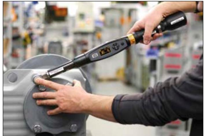
**Einmal pro Schicht kontrolliert SEW-Eurodrive in der Getriebemotorenmontage den korrekten Anzug aller Verschraubungen. Zusammen mit allen weiteren verfügbaren Datenquellen werden diese Informationen mit der Atlas-Copco-Software QS-Loop ausgewertet – was einen umfassenden Blick auf die Montageprozesse und damit die Steuerung der Qualität ermöglicht. (Bilder: Atlas Copco Tools)**
