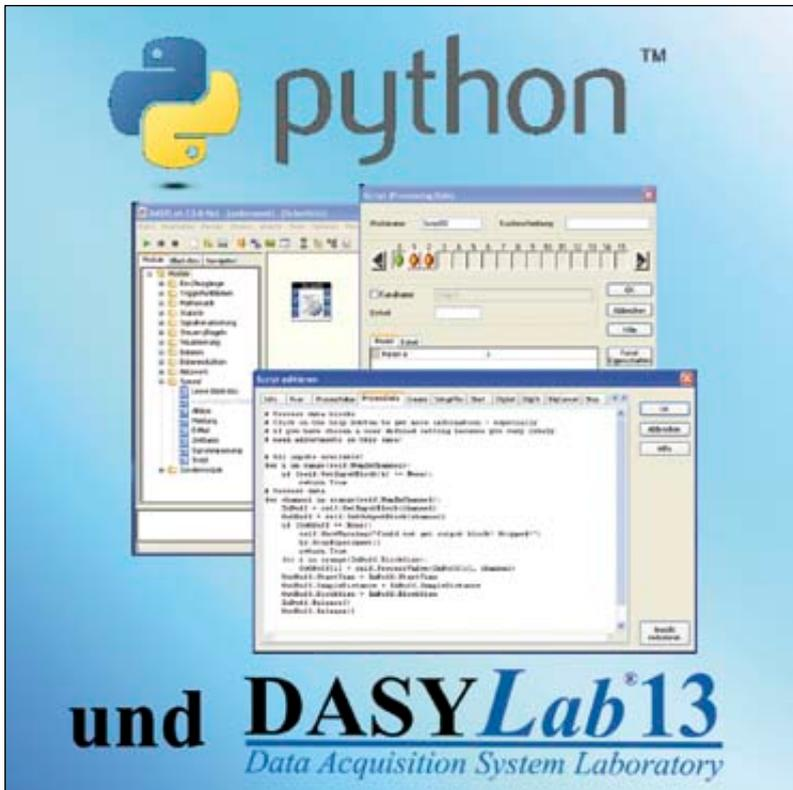
Die wichtigste Neuerung ist, dass die bereits in DASYLab 12 integrierte Python-Script-Engine, auf deren Basis z.B. der Treiber für die IVI-Schnittstelle (Interchangeable Virtual Instrument) entwickelt wurde, nun in Version 13 jedem Anwender zugänglich ist. Er kann nun über eigene Skripte seine individuellen DASYLab-Module erstellen und so die Funktionalität „seines“ DASYLabs erweitern. Die verwendete Skript-Sprache Python ist leicht zu erlernen und anzuwenden. Obwohl
