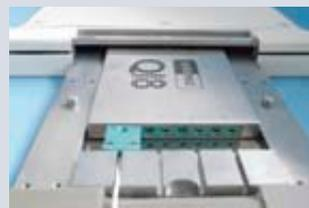
Von Datapaq kommt das laut Hersteller weltweit erste spezialisierte Temperaturüberwachungssystem für Vorspannöfen. Es setzt Thermoelemente ein, die während des Prozessdurchlaufs Temperaturwerte von der Glasscheibe aufnehmen.
