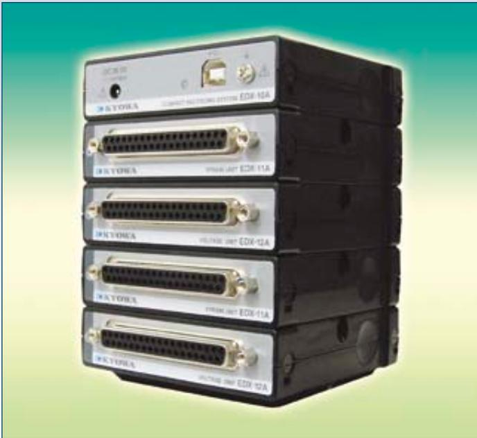
Die Module der EDX-10A-Serie sind preisgünstige DC-Messverstärker/ 24 Bit A/D-Wandler mit USB-Interface. An der Steuereinheit EDX-10A können bis zu vier Messmodule betrieben werden. Jedes Messmodul hat vier Eingänge für analoge Sensoren, je einen Messverstärker und einen 24 Bit A/D-Wandler. Die max. 16 Eingangskanäle werden synchron erfasst und vom Controller zum PC weiter geleitet. Zwei Arten von Messmodulen stehen zur Auswahl: Das
