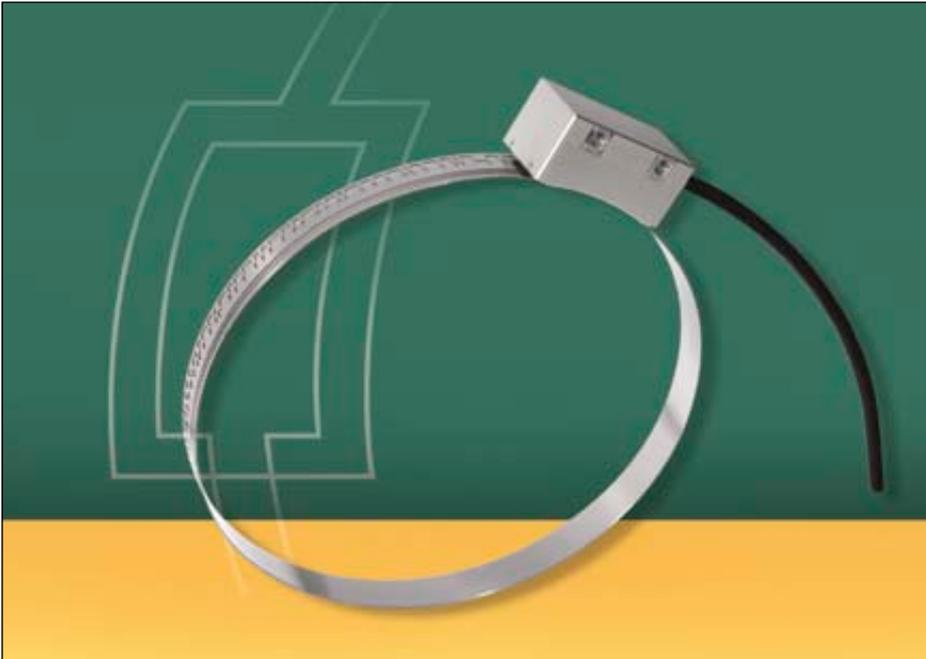
ringdurchmesser ebenfalls zunimmt, werden die Auflösung und Genauigkeit des Gerätes in Bogenlänge angegeben. Die höchste Auflösung beträgt derzeit 1 oder 0,25  $\mu\text{m}$  und die Genauigkeit bis zu  $\pm 3 \mu\text{m}/\text{Umfang}$ .
