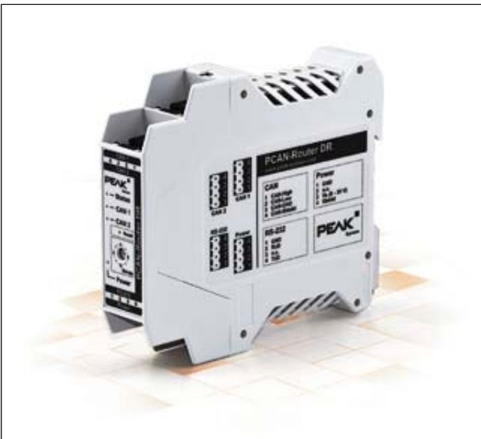
Der PCAN-Router DR von PEAK-System ist ein universeller CAN-Umsetzer, der den CAN-Nachrichtenverkehr 1-zu-1 bidirektional weiterleitet. Er verfügt über zwei High-Speed-CAN-Kanäle mit einer Übertragungsrate von bis zu 1 Mbit/s. Durch den erweiterten Betriebstemperaturbereich von -40 bis 85 °C
