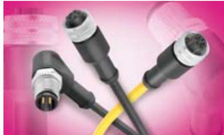
Ergänzend zu den M12 frei konfektionierbaren Steckverbindern mit US-Kodierung bietet Binder ganz neu auch umspritzte Kabelsätze in dieser Kodierung an. Es gibt 3- und 4-polige Ausführungen mit M12 x 1 oder 1/2" UNF Verschraubung. Die Artikel sind standardmäßig mit 2 m und 5 m PUR-Kabeln lieferbar. Auf Anfrage sind PVC-Kabel selbstverständlich ebenfalls machbar. Alle Kabel haben die UL-Zulassung.
