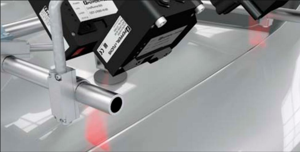
**Applikationsbeispiel aus der Automobilindustrie für den Laserlichtschnitt-Sensor LineRunner: Spaltkontrolle zur optimalen Einpassung einer Kofferraumklappe bei der Montage.**
