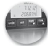
Bereits Ströme ab 1 mA werden registriert: Selbst kleinste Leistungen werden erfasst, beispielsweise von Geräten im Stand-by-Modus.
