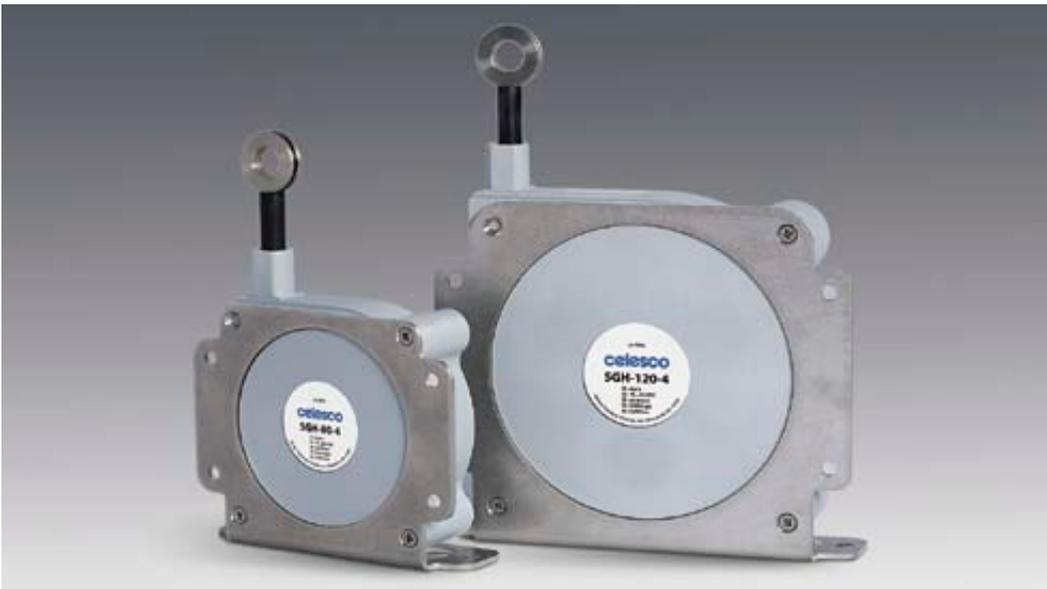
Mit 12 bit Auflösung arbeiten die neuen Seilzug-Wegaufnehmer vom Typ SGH des US-Herstellers CeleSCO und erweitern jetzt die breite Palette an Positionssensoren von Variohm EuroSensor um weitere Ausführungen mit CANopen-Ausgang. Messwege von 2.032 mm oder 3.048 mm werden absolut mit einer Genauigkeit von 0,5% erfasst.
