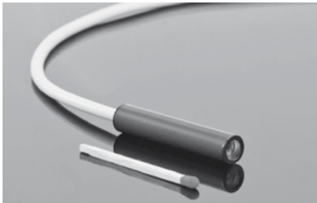
So kurz wie ein Streichholz und dünner als ein Kugelschreiber: Das ist der Flexpoint MV femto, der kleinste Linienlaser für die industrielle Bildverarbeitung von Laser Components. Das neue Lasermodul misst 8 mm im Durchmesser und ist nur 40 mm lang; damit passt es auch in kleine 3D-Lasersensoren. Laser Components beachtet auch die Einbauumgebung beim Kunden. Ab Werk ist das Modul auf den kundenspezifischen Abstand fokussiert. Dadurch wird die beste Linienqualität erzielt; das heißt so
