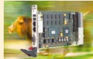
im Transportwesen oder generell für anspruchsvolle Grafikapplikationen zum Einsatz kommen. Alternativ können weitere CPUs der i7-Serie bestückt werden. An der Front der Karte sind Grafik über VGA, zweimal Gigabit Ethernet und 2x USB 2.0 verfügbar. Durch den Einsatz von Erweiterungskarten können außerdem zusätzliche Funktionen genutzt werden. Das robuste Design des 3-HE-CompactPCI-PlusIO-Rechners eignet sich für extreme Umgebungsbedingungen.
