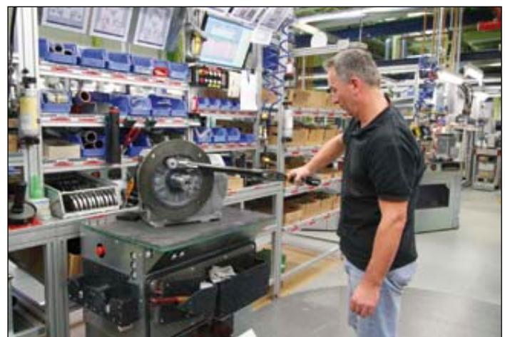
**Im Werk Gaben-Neudorf hat SEW-Eurodrive begonnen, die klassischen mechanischen Drehmomentschlüssel durch intelligente elektronische des Typs ST-Wrench von Atlas Copco zu ersetzen. Die genaueren Daten ermöglichen im Zusammenspiel mit der Software QS-Loop eine noch präzisere Analyse der Schraubprozesse und bei Abweichungen genauere Aussagen zu möglichen Ursachen.**
