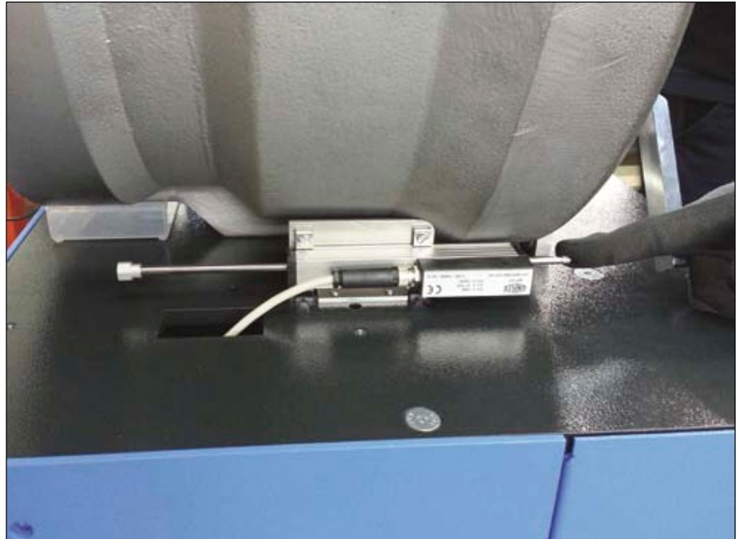
**Bild 2: Die Maschinen sind auf zuverlässige Wegaufnehmer angewiesen, denn der Pressweg muss sich gemäß der von der Steuerung vorgegebenen Werte an die jeweilige Schlauchform und -größe anpassen lassen (Foto: Uniflex).**
