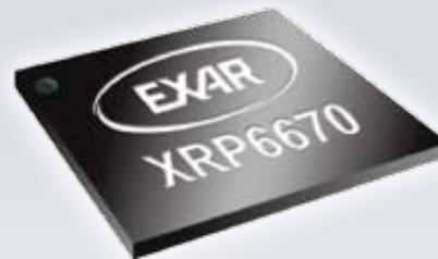
Der kompakte und hocheffiziente DC/DC Synchron-Abwärtsregler mit einer extern programmierbaren Schaltfrequenz von maximal 2,5 MHz liefert Ausgangsströme bis zu 3 A. Der XRP6670 erzeugt Ausgangsspannungen ab 0,8 V aus z.B. 3,3 V oder 5 V Standardspannungen, darüber hinaus bietet er Funktionen wie Enable, Soft-Start und Power Good.
