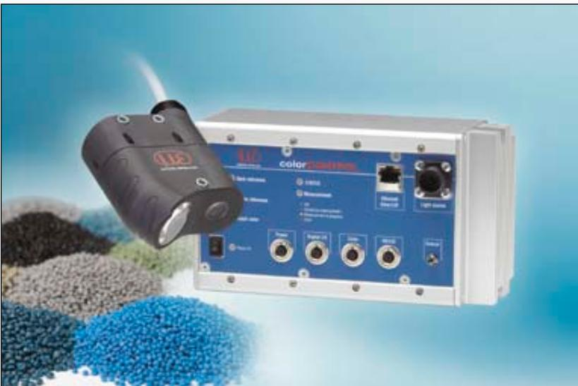
Für die kontinuierliche Farbkontrolle in der Linie wurde ein Inline-Farbmesssystem entwickelt. Das neue System erkennt nicht nur die gespeicherten Farben nach dem Ja-Nein-Prinzip, sondern bestimmt den Farbton der Werkteile spektral-photometrisch. Mit der Genauigkeit, die das menschliche Auge übertrifft, und der Messrate von 2000 Hz wird es bereits vielseitig in der Kunst-
