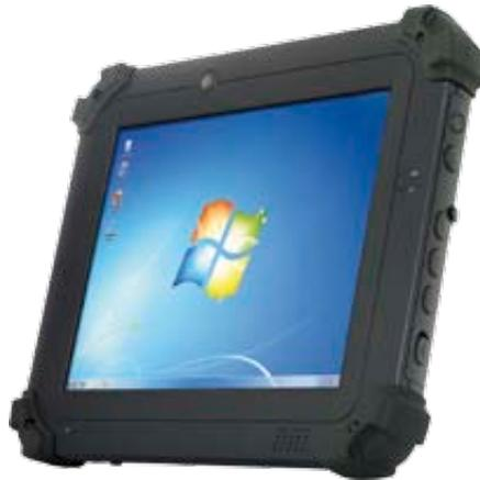
mal 2x 2,8 GHz, aus der sparsamen Ultrabook Serie. Dank der „Ivy Bridge“ Architektur verbraucht der DT398 nur maximal 17 Watt. Die Intel HD4000 Grafik sorgt zudem für eine beeindruckende Leistung bei niedrigem Energieverbrauch und erhöht somit Akkuleistung und Lebensdauer.
