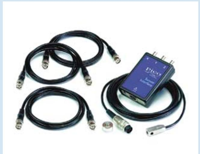
Dieses neue Accelerometer von Pico Technology hat einen Sensor für alle drei Richtungsachsen. Es wird zur Messung von Vibrationen, Beschleunigung oder der Richtung in drei Dimensionen eingesetzt. Damit können Beschleunigungen bis  $\pm 5 \text{g}$  und Vibrationsfrequenzen von DC bis 350 Hz gemessen werden.
