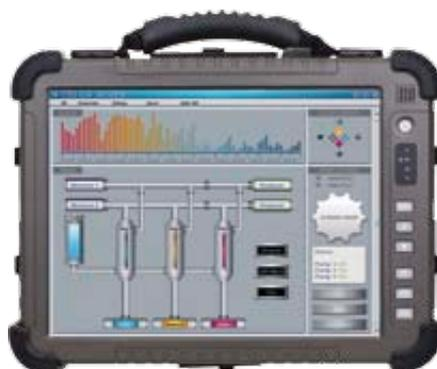
satz, 2 GB DDR Speicher, 32 GB SSD, Gigabit-LAN, WLAN, 3G, GPS, SD-Card-Slot, RS-232, 2x USB 2.0, 2x PS/2, VESA Anschlussmöglichkeit und Windows 7 Embedded Standard steht dieser Tablet-PC für Mobilität, Konnektivität und intuitive Bedienung. Dank seiner vielseitigen Ausstattung findet er seinen Einsatz beispielsweise bei widrigen Bedingungen im Bauwesen oder der Lagerlogistik. Der Industrial Tablet-PC ist im Online-Shop der ICO – Innovative Computer GmbH erhältlich.
