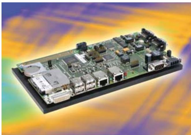
lierte CAN-Schnittstellen. Außerdem gehören vier serielle Schnittstellen, eine DVI-D-, eine SATA- und eine CFast-Schnittstelle zum Standardlayout. Optional lassen sich die Boards um eine Ether-
