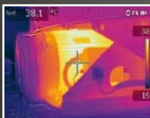
Schnelle Überprüfung von elektrischen Motoren
