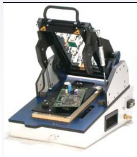
**S&K entwickelt und fertigt Prüfgeräte wie diesen pneumatischen Nadelbettadapter mit Wechselkassette (Bild Prüftechnik Schneider & Koch).**
