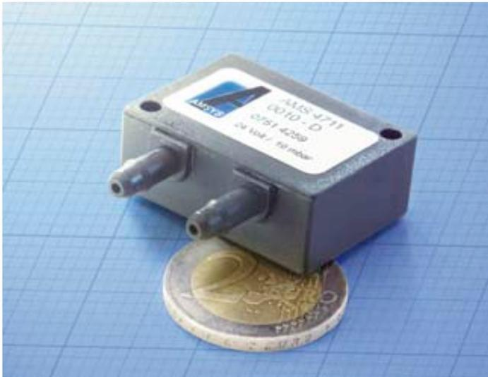
Die Ready-to-use Drucksensoren der Baureihe AMS 4711 kombinieren Mikrostrukturierung von Siliziumelementen mit Mikroelektronik zu einem hochgenauen, kalibrierten und Temperatur kompensierten Drucksensor im Miniformat 35 x 25 x 13,5 mm. Die AMS 4711 sind ohne weitere Komponenten für die Innen- und Außenmontage betriebsbereit.
