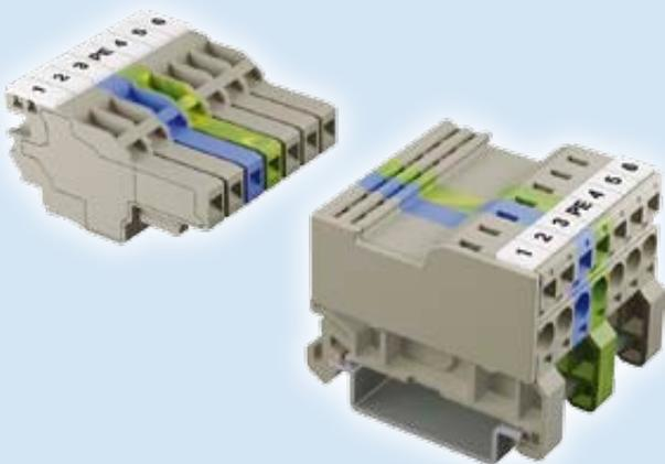
Conta-Clip stellt ein neues Anschlusssystem für ein berührungssicheres Trennen und Anschließen vor. Die Stecker ZSTS 2,5 und die Kupplungen ZSTK 2,5 eignen sich für Bemessungsströme bis 24 A und Bemessungsspannungen bis 500 V.
