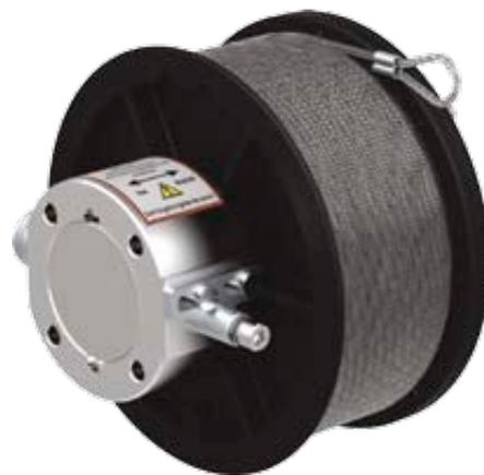
Die neuen robusten Heavy-Duty-Längensensoren von FSG funktionieren nach dem Seilzugmessprinzip und eignen sich für Positionieraufgaben in anspruchsvollen Umgebungen, wie z.B. staubigen oder feuchten Atmosphären. Sie sind mit einem kunststoffummantelten Edelstahlmesseil mit einem Durchmesser von 3 mm ausgestattet und verfügen über
