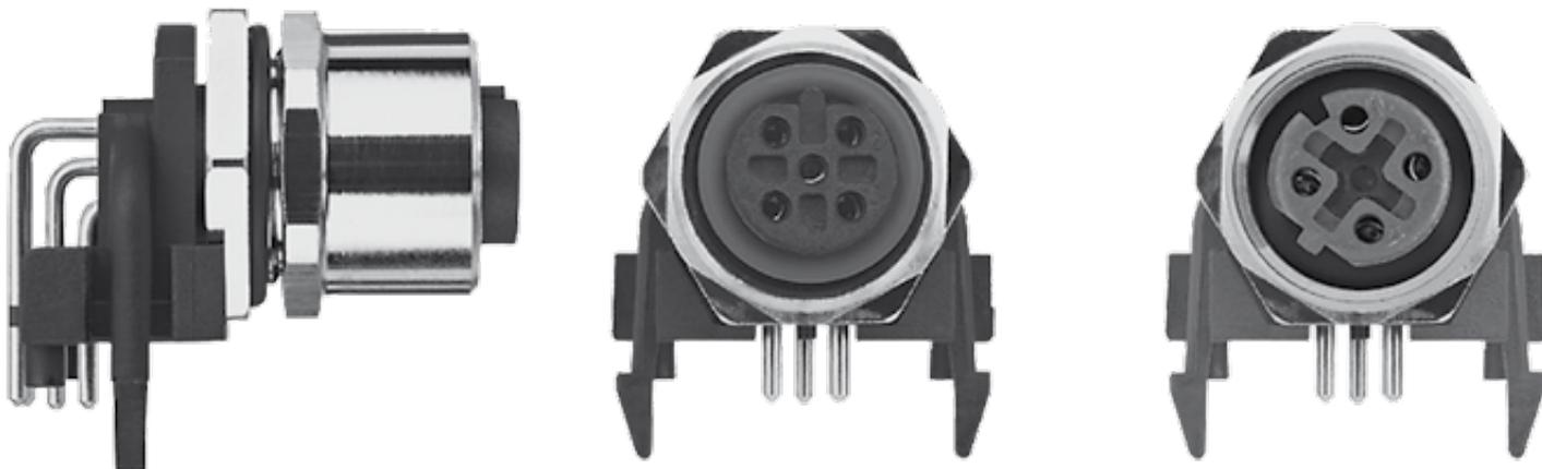
Escha bietet ab sofort neue M12x1 Einbaustecker mit gewinkelten Kontakten für die Leiterplattenmontage an. Diese sind in unterschiedlichen Codierungen und Poligkeiten erhältlich und erfüllen im verschraubten Zustand die Anforderungen der Schutzklasse IP67.
