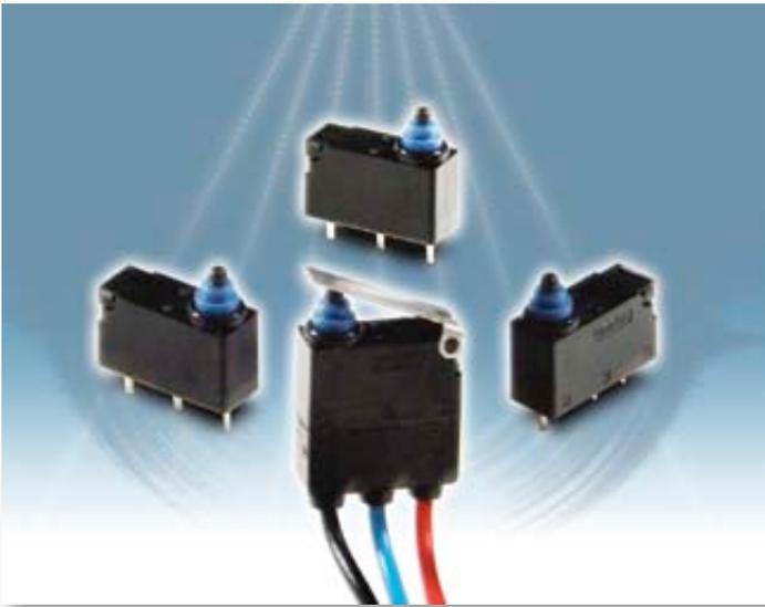
Der laut Hersteller weltweit kleinste gekapselte Schnappschalter kommt von Omron Electronic Components B.V. Er verfügt über einen besonders langen Betätigungsweg mit einem Überhub von 1,4 mm, der ohne zusätzlichen internen Mechanismus realisiert wurde und für einen zuverlässigen und gleichmäßigen Ein/Aus-Betrieb sorgt.
