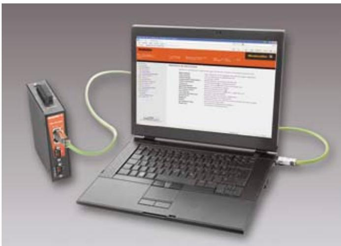
**Bild 2:** Über das integrierte Web-Interface lassen sich alle Funktionen des Konverters besonders benutzerfreundlich konfigurieren.
