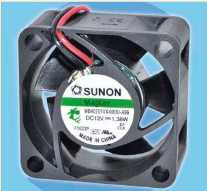
Der MB40201VX-A99 ist die leistungsstarke Ausführung der Sunon MB-Lüfterserie mit einem Kantenmaß von 40 x 20 mm. Er realisiert einen maximalen Volumenstrom. Die Geschwindigkeit ‚X‘ in der Produktbezeichnung weist im Vergleich zur Geschwindigkeit ‚1‘ des nächsten Typs in gleicher Baugröße eine um 21% höhere Luftleistung auf (Geschw. X = 18,3 m<sup>3</sup>/h vgl. Geschw. 1 = 15,1 m<sup>3</sup>/h). Trotz der hohen Volumenstromleistung ist seine Lebensdauer hoch.
