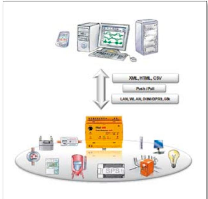
Steuerungsfunktionen werden entweder autonom im Gateway/Konzentrator wahrgenommen oder übergeordnet im Head-End ausgeführt. Neben den lokalen Kommunikationsschnittstellen stehen dazu digitale Ausgänge oder Relaisausgänge im Datengateway zur Verfügung.
