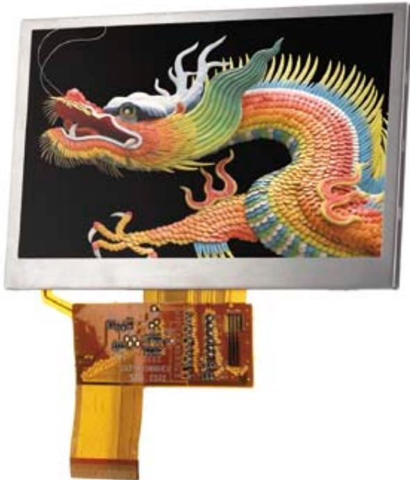
Die neue „DET“ TFT-Linie von Densitron ist eine gute Wahl für Entwickler, die Displays mit einem speziell auf ihre Belange angepassten Interface und einem hohen Helligkeitsniveau suchen. Es sind Varianten mit den Diagonalen 10,9 cm (4,3"), 14,48 cm (5,7"), 17,78 cm (7") und 25,65 cm (10,1") erhältlich. Auch integrierte Touch-Sensoren werden optional angeboten.
