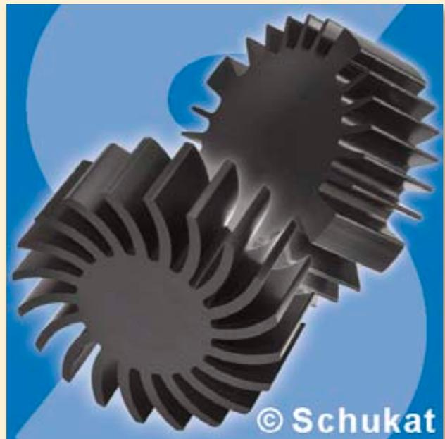
Die neuen Kühlkörper der Serie SK5 von Fischer Elektronik eignen sich ideal für LEDs in Anzeige- und Beleuchtungselementen. Es handelt sich um speziell auf die LED-Beleuchtung abgestimmte Hochleistungs-Kühlkörper mit einem Wärmewiderstand von 2,0 bis 1,4 K/W für LED-Module mit hoher Leistung. Das sichert die notwendige Entwärmung für eine einwandfreie und langlebige Funktion der LEDs.
