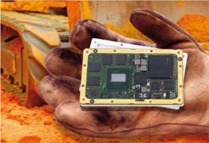
Robust, platzsparend und dabei auch leistungsstärker als der Intel-Atom der ersten Generation: Das neue ESMINI-Modul von MEN ist bestückt mit einem Intel-Atom-Prozessor aus der E600-Serie und eignet sich hervorragend für anspruchsvolle
