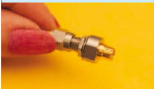
**2.** Aus Ihrem Standard-Kabel ist jetzt ein SMA-Buchse-Schnellverbindungs-Kabel geworden.
