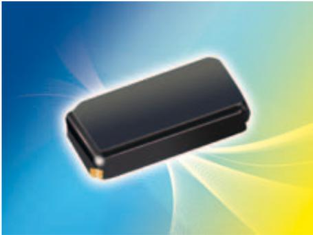
Petermann bietet im 3,2 x 1,5 x 0,8 mm messenden Mini-SMD-Keramikgehäuse der Serie M3215 hochgenaue 32,768-kHz-Quarze mit der Frequenztoleranz von 10ppm an.
