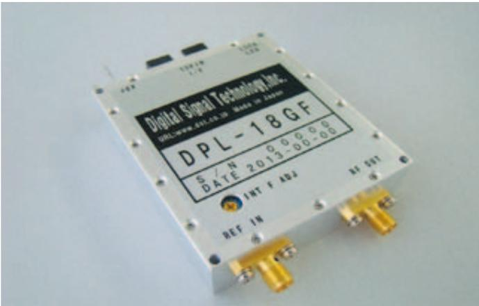
Tech-Inter GmbH stellte die neuen, von 1 bis 18 GHz programmierbaren Breitband-Synthesizer DPL-18GF und DPL-18GFH von Digital Signal Technology (DST) aus Japan vor, die sich durch ein niedriges Phasenrauschen auszeichnen. Bei einer gewählten Frequenz von z.B. 10 GHz liegt das Phasenrauschen, bei 100 Hz Offset vom Träger unter -73 dBc/Hz. Bei 1 MHz Offset sinkt diese Wert sogar unter -111 dBc/Hz. Die typische Ausgangsleistung ist größer als +10 dBm. Der modulare Auf-
