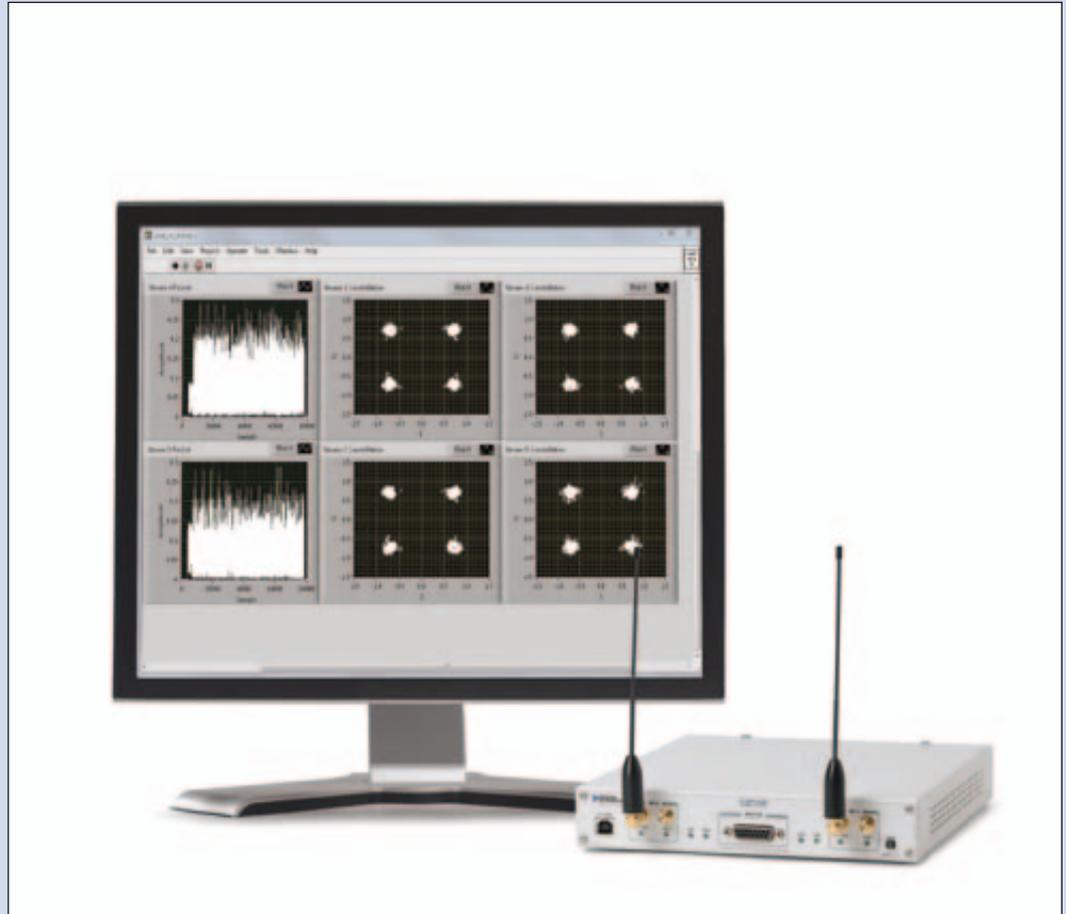
National Instruments stellt eine integrierte SDR-Lösung (Software-Defined Radio) für die schnelle Prototypenerstellung von leistungsstarken Wireless-Kommunikationssystemen mit mehreren Kanälen vor. Die Plattform NI USRP RIO basiert auf der NI LabVIEW RIO Architecture und kombiniert einen performanten 2x2-MIMO-RF-Transceiver (Multiple Input, Multiple Output) mit einer offenen FPGA-Architektur, die mit NI LabVIEW programmierbar ist. Das Gerät kann Signale von 50 MHz bis 6 GHz senden und empfangen.
