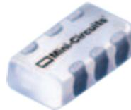
Der NCS4-102+ von Mini-Circuits ist ein HF-Trafo im keramischen Gehäuse. Es misst nur 0,079x0,049x0,033 inch. Seine J-Konfiguration mit vier identischen Wicklungen kann vielseitig eingesetzt werden, z.B. als Balun. Zwei Wicklungen sind intern in Reihe geschaltet und so zugänglich, während ein Anschluss der anderen beiden Wicklungen an Masse liegt.
