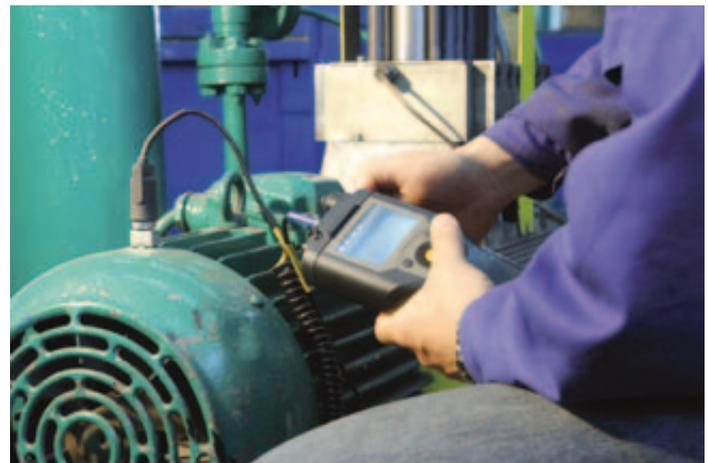
**Bild 2. Vorhandene Methoden zur Erfassung von Vibrationen mit manuellen Messaufnehmern bieten Nachteile hinsichtlich Wiederholbarkeit und Zuverlässigkeit.**
