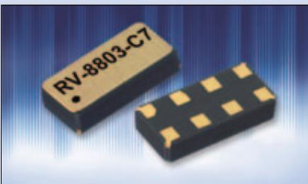
Die ultrakleine RV-8803-C7 bietet die aktuell beste Ganggenauigkeit von nur 3ppm über den Temperaturbereich von -40 bis +85 °C. Das entspricht 0,26 s/Tag) bei einem Stromverbrauch von lediglich 250 nA. **48**
