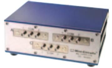
Mit der USB/Ethernet RF Switch Matrix RC-3SPDT-A18 hat Mini-Circuits ein Produkt vorgestellt, das 100 Millionen Schaltzyklen garantiert. Diese Matrix in 50-Ohm-Technik ist von DC bis 18 GHz einsetzbar, entweder für USB oder Ethernet-TCP/IP.
