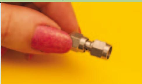
**2.** Aus Ihrem Standard-Kabel ist jetzt ein SMA-Stecker-Schnellverbindungs-Kabel geworden.
