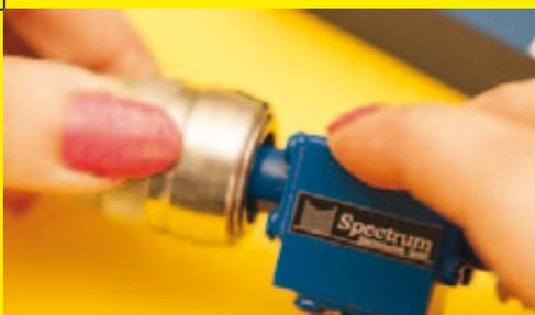
**5.** Zum Lösen der Verbindung bewegen Sie die Schiebemutter nach vorne. Um zu verhindern, dass die Mutter wieder zurückrutscht, setzen Sie Ihre Finger dabei auf der Feststellmutter auf.
