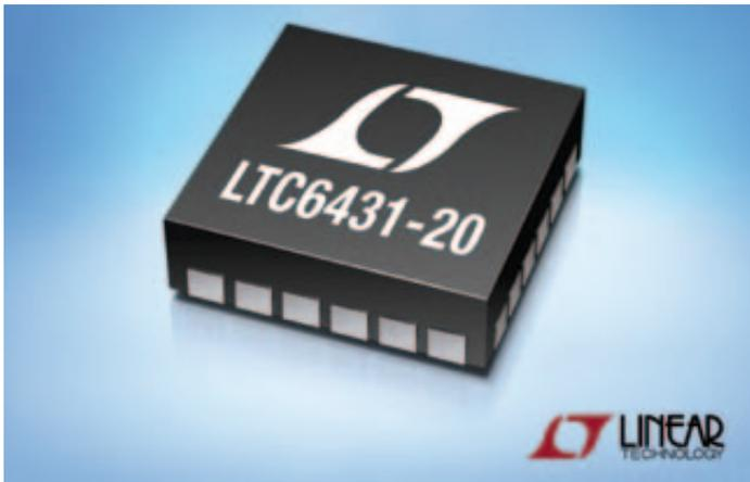
Linear Technology präsentiert den LTC6431-20, einen Verstärker für den Frequenzbereich von 20 MHz bis 2 GHz mit unsymmetrischen Ein- und Ausgängen und festem Verstärkungsfaktor, der sich durch einen ungewöhnlich hohen OIP3 (Output Third Order Intercept) von 46,2 dBm und ein Rauschmaß von nur 2,6 dB auszeichnet.
