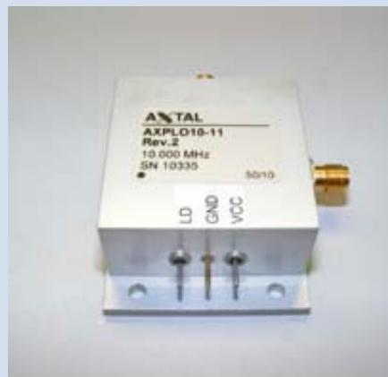
Wird in einen OCXO eine PLL als rauscharme und stabile Referenzquelle integriert, spricht man von einem PLOCXO. Mit den PLOCXO-Serien AXPLO10 und
