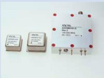
Ultra-rauscharme Quarzoszillatoren sind das Spezialgebiet von Axtal. Durch die hohe Fachkompetenz mit 80 Jahren Erfahrung wurde Axtal nun offiziell – als einziger Hersteller in Deutschland – für die Fertigung von Präzisionsquarzoszillatoren (OCXOs) für den Einsatz im Weltraum qualifiziert.
