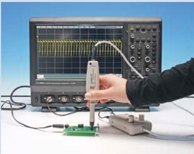
Der I-Prober 520 ist ein kompakter, tragbarer Messkopf, welcher in Verbindung mit Oszilloskopen verwendet wird. Wenn man die isolierte Prüfspitze auf eine Leiterbahn setzt, können Ströme bei einer Toleranz von 5% galvanisch getrennt gemessen werden, ohne den Stromkreis unterbrechen zu müssen.
