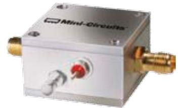
Der koaxiale Breitbandverstärker ZFL-2000G+ von Mini-Circuits hat 50-Ohm-Anschlüsse und ist im Frequenzbereich 10 MHz bis 2 GHz einsetzbar. Er arbeitet in Klasse A.
