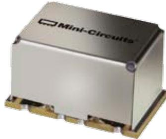
Bei dem Richtkoppler SYDC-19-52HP+ von Mini-Circuits handelt es sich um eine SMT-Baugruppe mit nominell 20 dB Koppelfaktor. Der zweiseitige Koppler ist in einem Frequenzbereich von 30 bis 512 MHz einsetzbar. Ausgangsangepasst bis zu einem SWR 2 ist im Bereich 100 bis 450 MHz eine Durchgangsleistung bis 50 W möglich, bei offenem oder kurzgeschlossenem Ausgang sind es 20 W.
