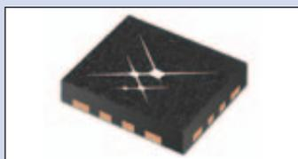
Skyworks Solutions, Inc. stellte mit dem SKY65535-11 ein hochintegriertes 5-GHz-Front-end-Modul (FEM) für drahtlose Verbindungen, Bluetooth und mobile Anwendungen vor, die hinsichtlich der Anforderungen über die von 802.11n-Systemen hinausgehen. **44**
