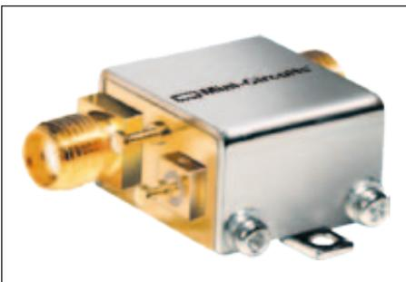
Der rauscharme Breitbandverstärker ZX60-P103LN+ von Mini Circuits hat ein typisches Rauschmaß von 0,5 dB bei 1 GHz. Dies wurde mit E-PHEMT-Technologie erreicht. Der Verstärker ist zwischen 50 MHz und 3 GHz einsetzbar. Geringes Rauschen und Breitbandigkeit schließen einen hohen Dynamikbereich bei relativ geringer DC-Leistungsaufnahme nicht aus.
