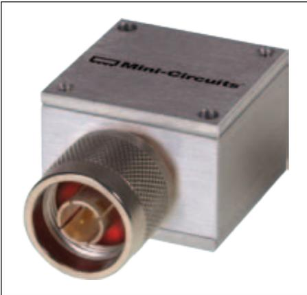
Der 50-Ohm-Slope Equalizer ZWQ-3-222N+ von Mini Circuits ist für den Frequenzbereich 950 bis 2.150 MHz (L Band) vorgesehen. Man kann ihn sich als Attenuator mit integriertem Filter vorstellen. Die Abweichung zwischen den Dämpfungen beträgt maximal 0,4 dB. Das Gehäuse ist mit koaxialen Anschlüssen versehen (N-M/F).
