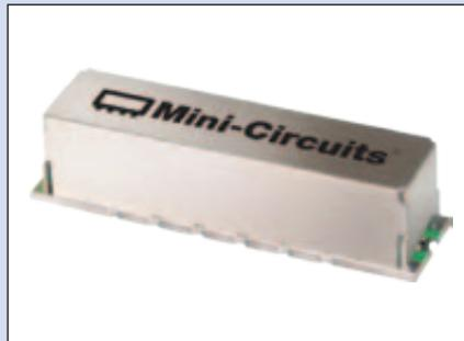
Das Bandpassfilter BPF-A1140+ von Mini-Circuits ist ein 50-Ohm-Baustein für die Oberflächenmontage in einem schirmenden kleinen Gehäuse der Länge 34,54 mm und der Höhe 8,89 mm. Es wurde mit verlustarmen Kondensatoren und Luftspulen realisiert. Der vorrangige Einsatzbereich sind Array-Teleskope für die Radioastronomie.
