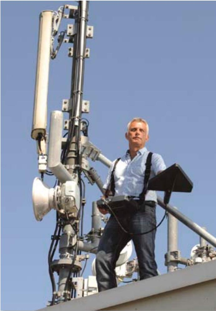
Narda Safety Test Solutions hat seinen Interference and Direction Analyzer IDA-3106 mit weiteren Funktionen ausgestattet, um Interferenzen und unbekannte Signalquellen schneller und sicherer lokalisieren zu können. Bei der Richtungserkennung mit einem horizontalen Scan lassen sich jetzt auch gepulste oder sporadisch auftretende Signale lokalisieren – eine Eigenschaft, die weltweit erstmals in einem Handgerät realisiert wurde.
