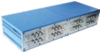
Mini-Circuit's USB-8SPDT-A18 ist eine universelle, USB-gesteuerte HF-Schaltermatrix, die acht absorbierende, elektromechanische SPDT-Failsafe-HF-Schalter enthält. Sie arbeiten in einer „Break-before-make“-Konfiguration und werden mit +24 VDC betrieben. Die typische Schaltzeit beträgt 25 ns. Die acht Schalter können wie folgt betrieben werden werden:
