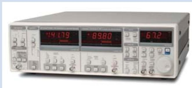
(-127 dBm) und 1 V (13 dBm). Der Verstärkungsfehler ist max. 2%. Das Eingangsrauschen wird mit typisch 2 nV/Hz angegeben. Der Lock-in hat einen Frequenzbereich von 25 kHz
