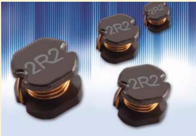
Die magnetisch ungeschirmten Low-Cost-Leistungsinduktivitäten der PCD-Serie des Herstellers Viking Tech Corp. sind besonders geeignet für Anwendungen wie DC/DC-Wandler, Schaltregler oder mobile Kommunikationsgeräte, Laptops oder LCD-TV.
