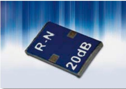
Der US Hersteller RES-NET Microwave (Vertrieb: WDI AG) stellte eine neue Serie von Dämpfungsgliedern vor. Die Serie RPCA150N besteht aus vier SMD-Versionen für jeweils 150 W. Je zwei Modelle kommen mit und ohne Tab und einer Dämpfung von 20 dB oder 30 dB. Grundmaterial der RoHS-konformen Bauteile ist Aluminiumnitrid. Die Impe-
