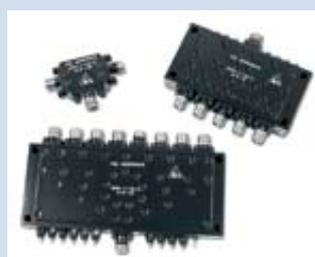
SPDT, 3weg-Schalter SP3T bis zu 7weg-Schalter SP7T mit Schaltzeiten von 10 MHz -1 GHz: 250 ns max., in allen anderen Frequenzbereichen: 100 ns max. Neben den hier angeführten, reflektiv arbeitenden Standardmodellen können auch absorptive Ausführungen oder Modelle nach Kundenwunsch angeboten werden.
