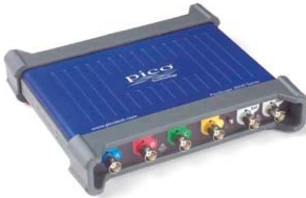
Die Oszilloskope mit USB-Stromversorgung von Pico sind darüber hinaus kompakt, leicht und portabel. Sie passen problemlos in eine Laptop-Tasche und eignen sich somit ideal für Techniker im Außendienst. FlexiPower bietet die Möglichkeit, das Oszilloskop über zwei USB-Anschlüsse zu betreiben.
