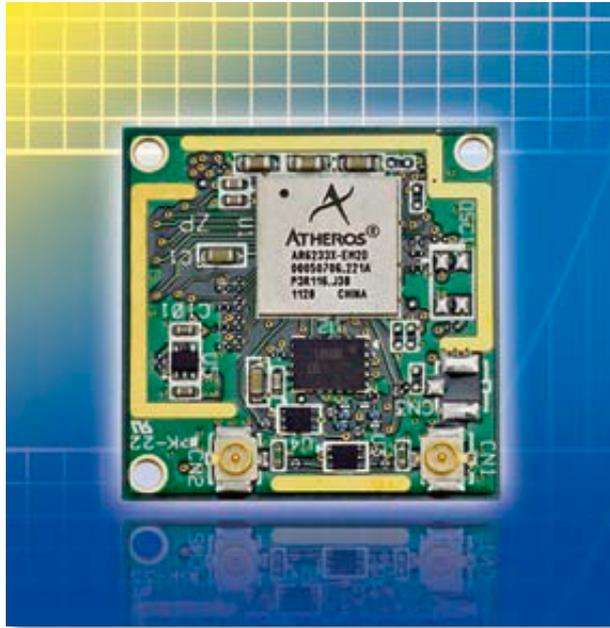
von 19x22x2,2 mm<sup>3</sup>. Es ist in einem Temperaturbereich von -10 bis +70 °C einsetzbar.
