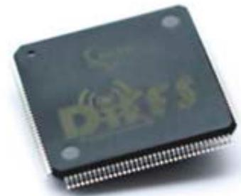
Bild 3: Der DIFFS-Chip (digital frontend for spectrum sensing) verfügt über flexible Synchronisations- und Spektrumerkennungs-Fähigkeiten.
