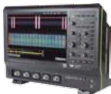
Mit der HDO-4000-Serie stellt Teledyne LeCroy neue Oszilloskope mit 12 Bit Vertikalaufklärung vor. Diese bieten mit 4096 Quantisierungsstufen eine erheblich bessere Amplitudenaufklärung als herkömmliche 8-Bit-Geräte. 42
