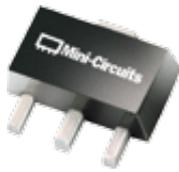
Durch einen flachen Verstärkungsverlauf und einen hohen dynamischen Bereich zeichnet sich der monolithisch aufgebaute Verstärker PGA-106W-75+ besonders aus. Daneben bietet er hohe Intercept-Punkte und geringes Rauschen. Er verstärkt Signale im Bereich 0,95 bis 2,15 GHz. Der hochwertige Breitbandverstärker in E-PHEMT-Technologie ist RoHS-kompatibel und hat ein SOT-89-Gehäuse für besonders gutes thermisches Verhalten.
