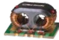
im Bereich 1,5 bis 30 MHz einsetzbar und verträgt 50 W durchlaufende Leistung. Der Koppelfaktor beträgt 20 dB, die Richtschärfe typisch 33 dB.
