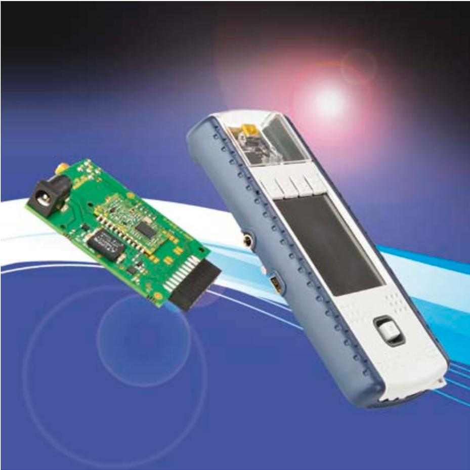
Die neuen Starterkits von Adeunis (Vertrieb: MC-Technologies) wurden entwickelt, um möglichen Anwendern den Einstieg in die Vielfalt der verschiedenen Funkmodule deutlich zu erleichtern. Das Kit setzt sich zusammen aus zwei „Handhelds“, basierend
