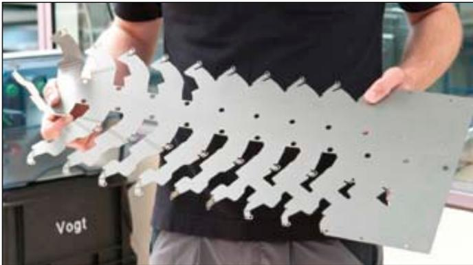
**Bild 1: Durch Mikrowasserstrahlschneiden hergestellter Prototyp, durch den zeit- und kostenintensive Nacharbeiten an den Stanzwerkzeugen minimiert werden konnten.**
