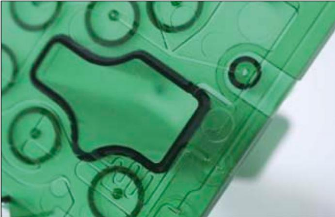
**Mit der LPKF PrecisionWeld lassen sich Lab-on-a-Chip-Kartuschen schweißen, mittels ClearJoining-Technologie sogar Klar-Klar-Verbindungen.**
