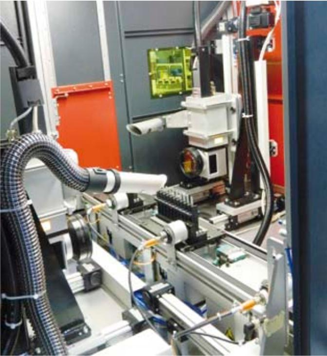
**Die Laserbeschriftung des medizinischen Bestecks erfolgt nach einer automatischen Teilvermessung an zwei Stationen. Das erhöht die Taktzahl. (Quelle: trotec)**
