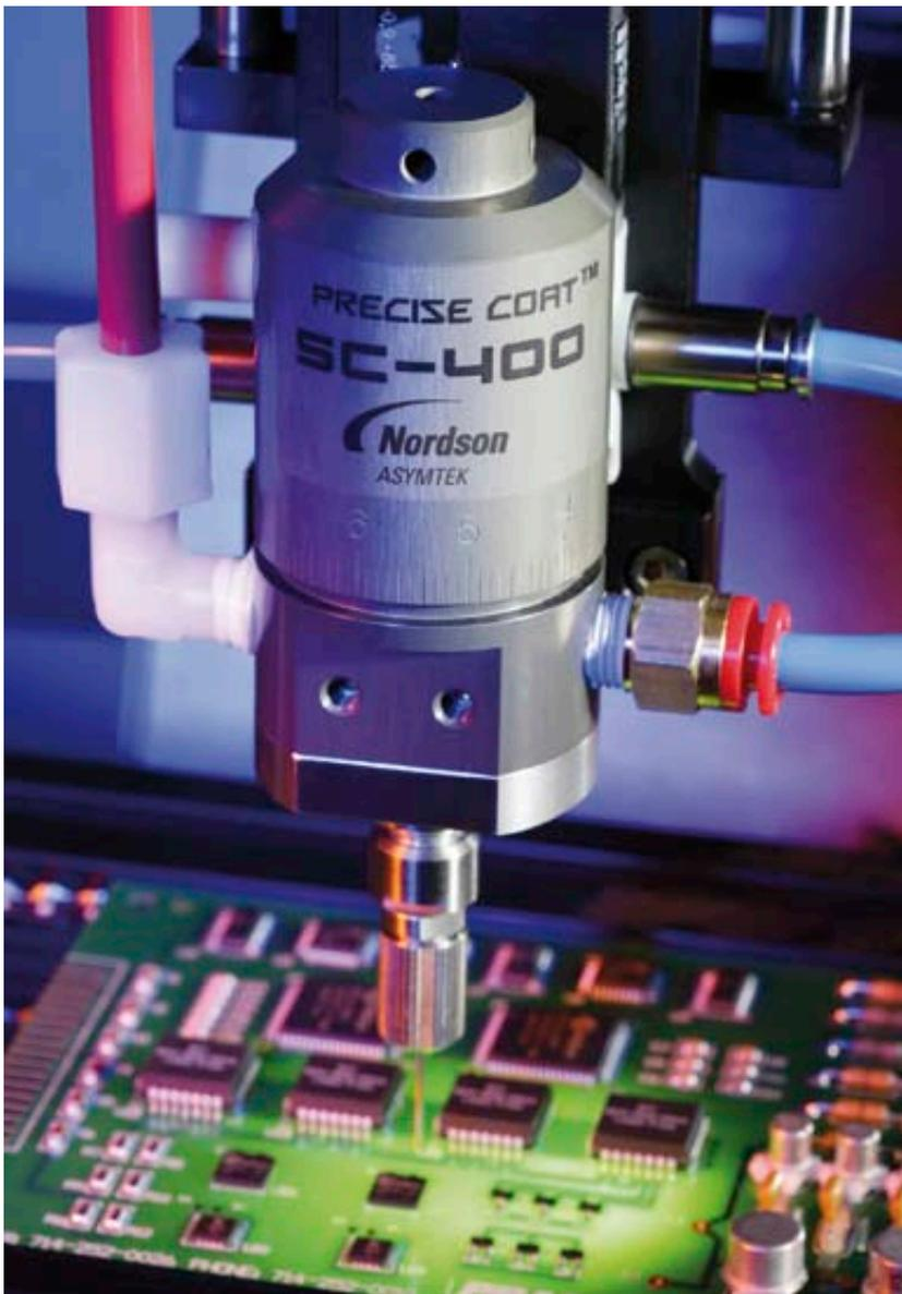
**Bild 1: SC-400 Beschichtungsventil mit Pulsweitenmodulation**
