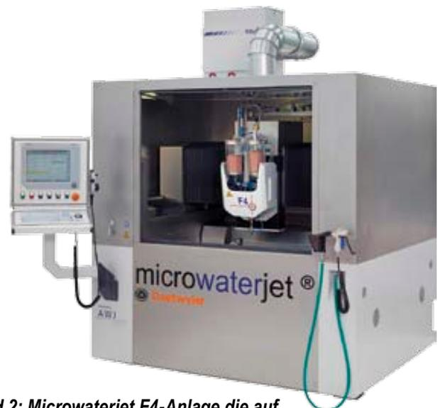
**Bild 2: Microwaterjet F4-Anlage die auf einer Aufspannfläche von 1000 x 600 mm mit einem minimalen Schneidstrahldurchmesser von 0,2 mm Bauteile in einer Toleranz- und Wiederholgenauigkeit von 0,01 mm fertigt.**
