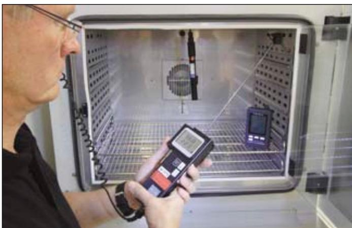
**Bild 2: Atlas Copco „kann“ nicht nur Schraubtechnik: Zu den zertifizierten Messgrößen gehören auch Temperatur, Feuchte oder pH-Wert. Damit können Industriebetriebe beispielsweise auch Messgeräte von Klimakammern bei Atlas Copco kalibrieren lassen.**
