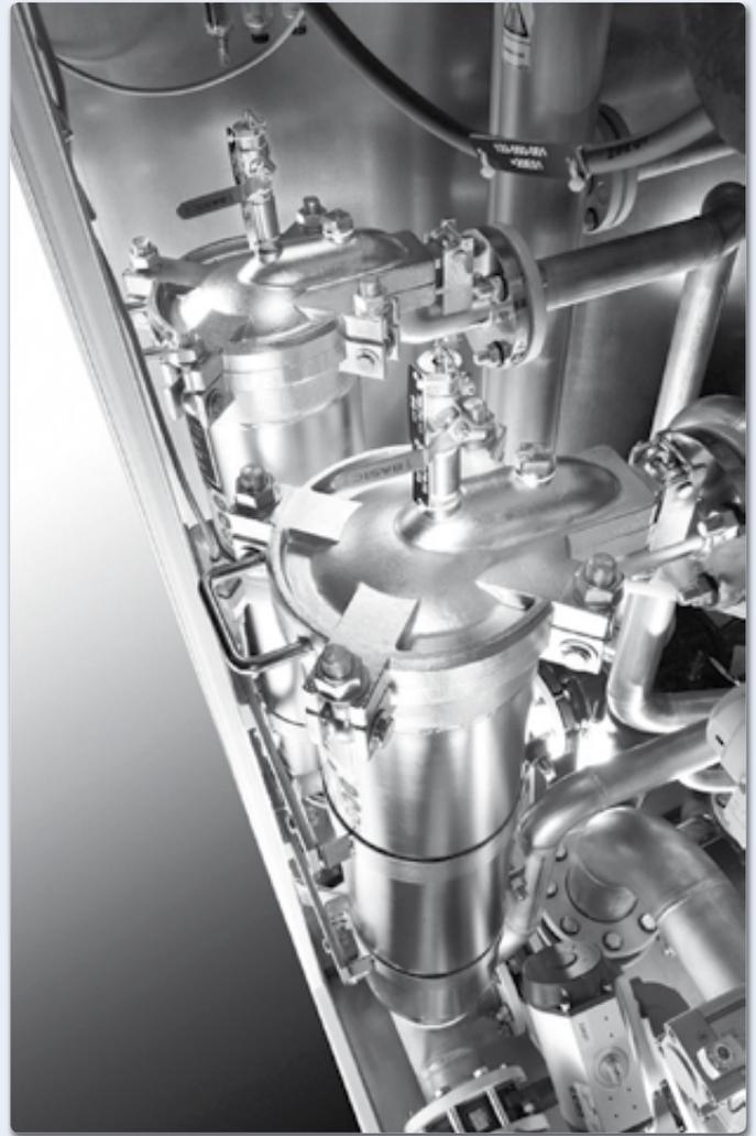
**Eine hohe Vakuumleistung, starke Pumpen und große Leitungsquerschnitte ermöglichen ein schnelles Füllen und Entleeren der Arbeitskammer und Tanks sowie eine optimale Lösemittelinbringung in den Warenkorb.**
