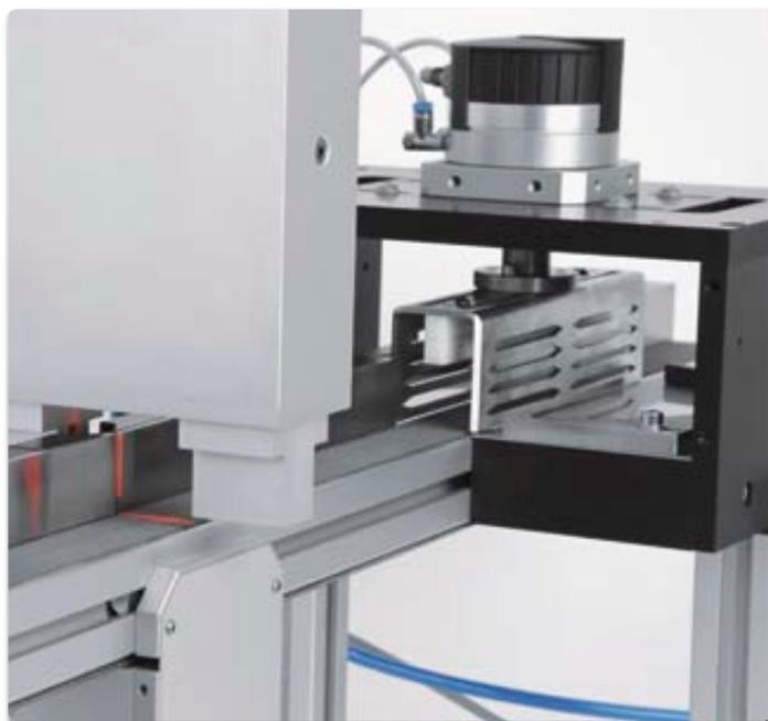
**Zentraler Bestandteil der Zuführeinheit: die Checkbox von Festo. Die integrierte Materialflusststeuerung der Zeilenkamera ermöglicht, Auswurfimpulse proportional zur Bauteillänge zu generieren und damit kurze oder lange Fehlteile sicher aus dem Prozess auszuschleusen. (Foto: IFC)**
