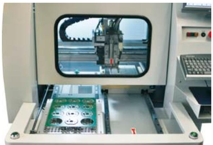
**Ein Schlitten kann be- bzw. entladen werden, während am anderen Schlitten weitergefräst wird**
