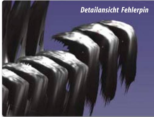
Die Koplanarität von SMDs hat entscheidenden Einfluss auf den Lötprozess und das Lötresultat. Das 3D-Messsystem Pulsar der SAC Sirius Advanced Cybernetics GmbH trägt maßgeblich dazu bei, diese zu gewährleisten: Es erlaubt die Bauteilvermessung auf optischem Wege in allen drei Raumkoordinaten ohne den Einsatz von Spiegeln oder mechanischen Verfahrenseinheiten. Die Koplanaritätsprüfung erfolgt nach standardisierten Normen (z.B. JEDEC) oder kundenspezifisch.
