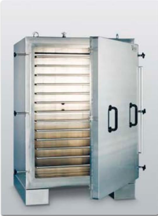
Mit Vakuumtrockenschränken von Vötsch lassen sich Produkte aus nahezu allen Industriezweigen trocknen. Hierzu zählen Komponenten von Lithium-Ionen-Energiespeichern genauso wie Platinen, Leiterplatten, elektronische Bauteile, Kunststoffe, Keramik, optische Gläser und vieles mehr.
