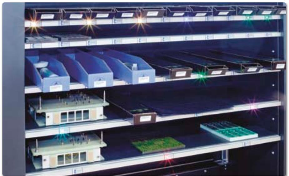
**Bild 2: Pick2Light Regal – „Kommissionieren nach Licht“ unterstützt den Mitarbeiter schnell und sicher beim Ein- und Auslagern.**
