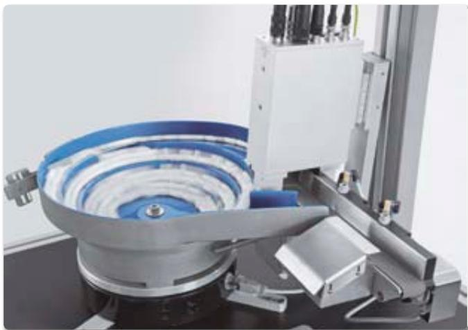
**50% weniger Energie, 50% weniger Lärm durch den Fördertopf: Die IFC Kamera-Band-Einheit ist aber auch so flexibel, dass sie per Knopfdruck auf verschiedene Teiletypen umgerüstet werden kann. (Foto: IFC)**
