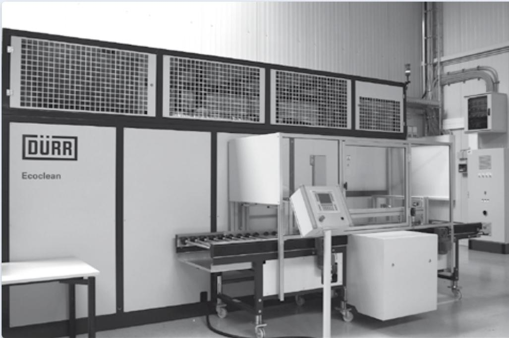
**Die Reinigungssysteme zeichnen sich durch eine umfangreiche Serienausstattung, beispielsweise Wärmerückgewinnung, Bypassfiltration und Injektionsflutwaschen (IFW), hohe Vakuumleistung, Einrichtungen zur Reduzierung von Energieverbrauch und Emissionen, aus.**
