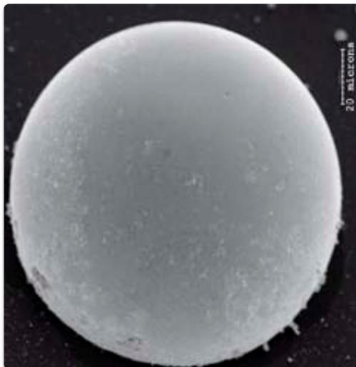
**Bild 5:** Vergleich der Bumps im REM, links: Bump aufgeschmolzen unter N<sub>2</sub>-Atmosphäre, rechts: Bump umgeschmolzen mit Plasmaunterstützung
