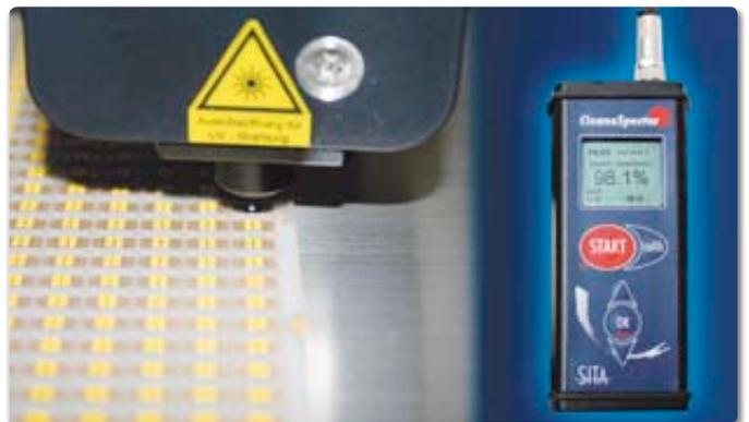
**Das kompakte, inline-fähige Fluoreszenzmessgerät CleanoSpector eignet sich u.a. zur Kontrolle von Bondpads auf organische Verunreinigungen (Bildquelle: SITA Messtechnik)**
