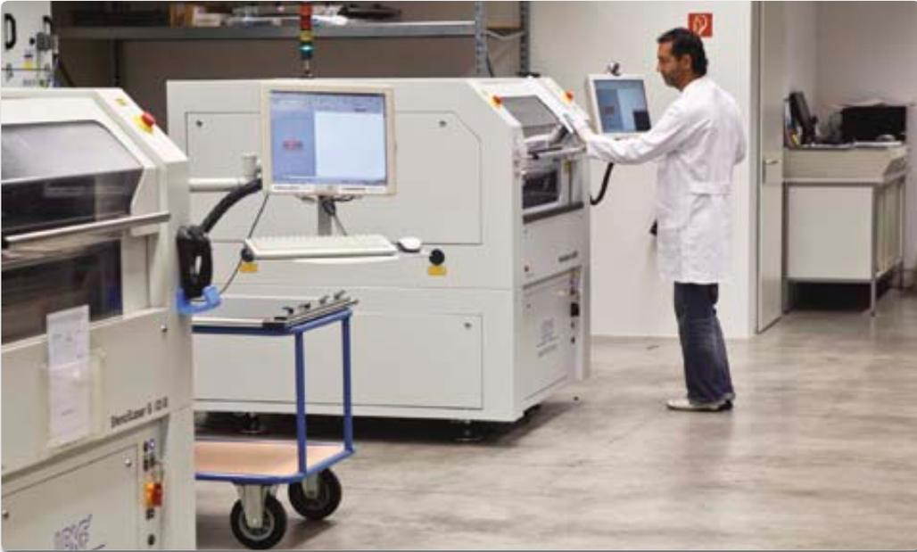
**Für seine SMD-Schablonen setzt photocad auf die neueste Laserschneidtechnik und hat 300.000 Euro in ein High-Speed-System von LPKF investiert. Die Anlage wurde eigens entwickelt, um hochpräzise Öffnungen zu erzeugen und dabei den Arbeitsprozess noch zu beschleunigen. Quelle: photocad GmbH & Co. KG**
