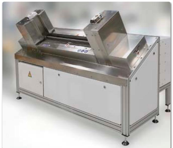
**Die Backrails werden über einen Schiebemechanismus dem Montageprozess einzeln zugeführt.**
