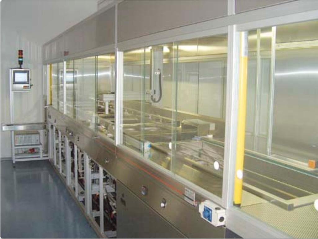
**Die Reinigung polierter Glaswafer vor dem Aufdampfen der leitenden Schichten erfolgt in einer Ultraschallreinigungsanlage mit mehreren Tauch- und Spülbädern. Als Medien sind hochalkalische bis neutrale Reiniger im Einsatz (Bildquelle: UCM)**
