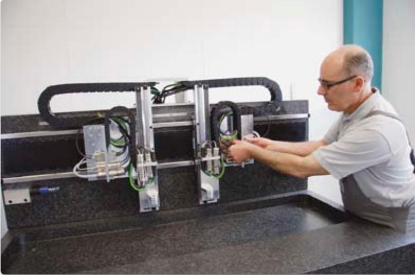
**Montage eines mehrachsigen Positionier- und Bewegungssystems einer hochdynamischen Pick & Place-Applikation**
