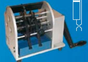
**Drahtstärke min. 0,35 mm max. 1,2 mm**
