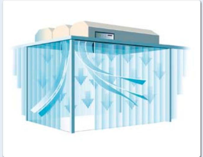
bel bestimmt werden. Selbst Fertigungsstraßen oder Fließbänder können in die Reinraumzelle integriert werden.
