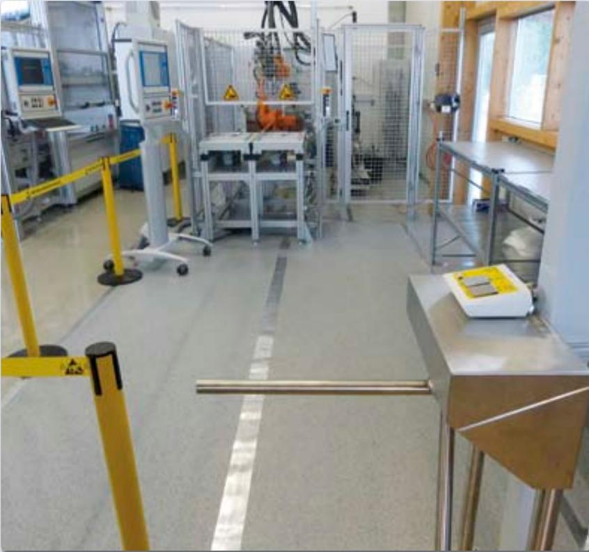
Die Sonderhoff Polymer-Services Austria GmbH (PSA) in Dornbirn/Vorarlberg erweitert ihr Lohnfertigungsspektrum für das Dichtungsschäumen, Kleben und Vergießen unterschiedlichster industrieller Bauteilanwendungen um den Bereich einer ESD-konformen Fertigung, in der sensible Bauelemente vor allem aus der Elektronikindustrie ohne elektrostatische Aufladungen verarbeitet werden können.
