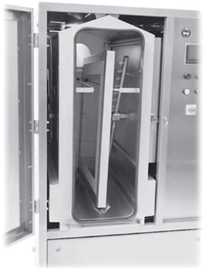
**Bild 2: Komplett getrennte Kreisläufe ermöglichen den Einsatz verschiedener Reinigungsmedien.**
