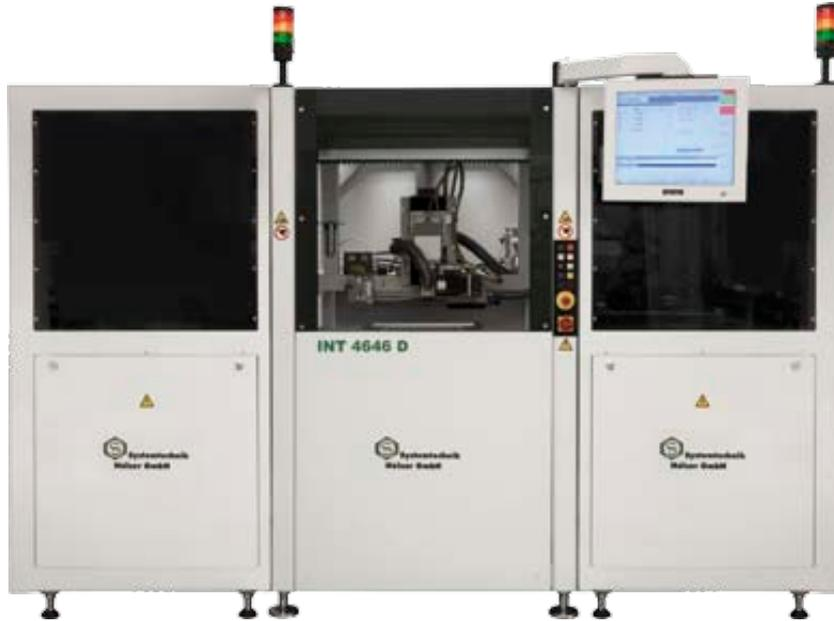
**INT 4646D mit Scheibenwerkzeug-Modul, LP-Greiferhandling, Vision-Modul sowie LP-Mehrfachnutzeneinzug und Tray-Loader TL-5133 zur Einzelnutzenablage in Trays, WTs oder Band.**
