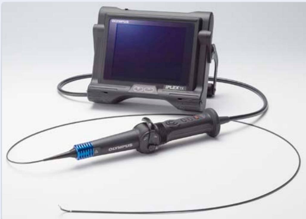
**Mit der Kombination aus detailgetreuen Bildern und ausgezeichneter Widerstandsfähigkeit ist das IPLEX TX ein ideales Videoskop für Routineinspektionen.**
