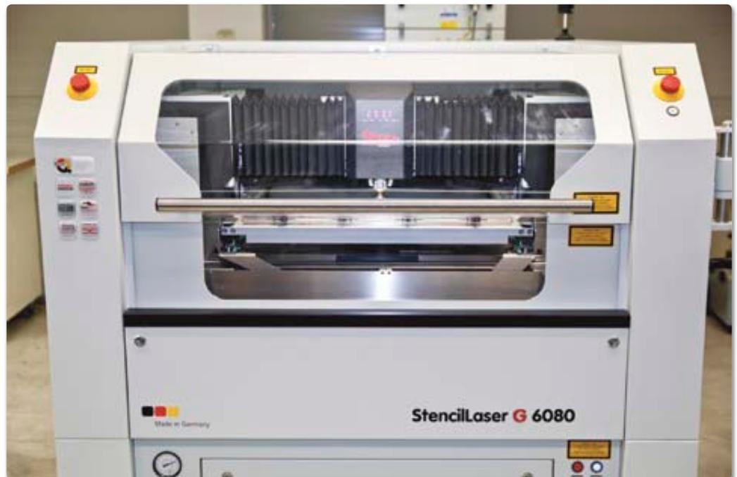
**Die neue Laserschneidanlage ist mit einem speziellen Kontrollsystem ausgestattet, das die Schablonenöffnungen in Echtzeit scannt und die Parameter gegebenenfalls ändert – ohne Stillstand.**
