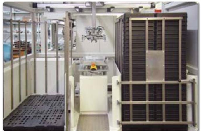
**Das Be- und Entladen erfolgt mittels eines eigens entwickelten Schnellwechselgreifers.**
