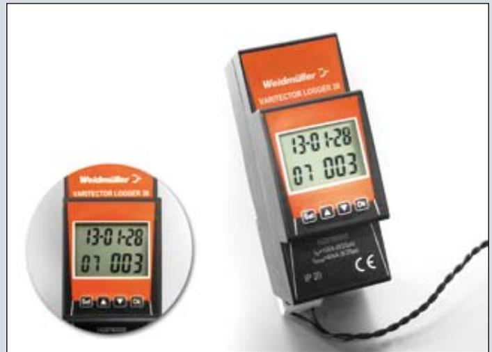
**Das Gerät misst den Blitz- und Überspannungsschutz und dokumentiert die Belastung von Anlagen. Detail: Die Messung wird mit einem stundengenauen Zeitstempel versehen. (Bilder: Weidmüller)**
