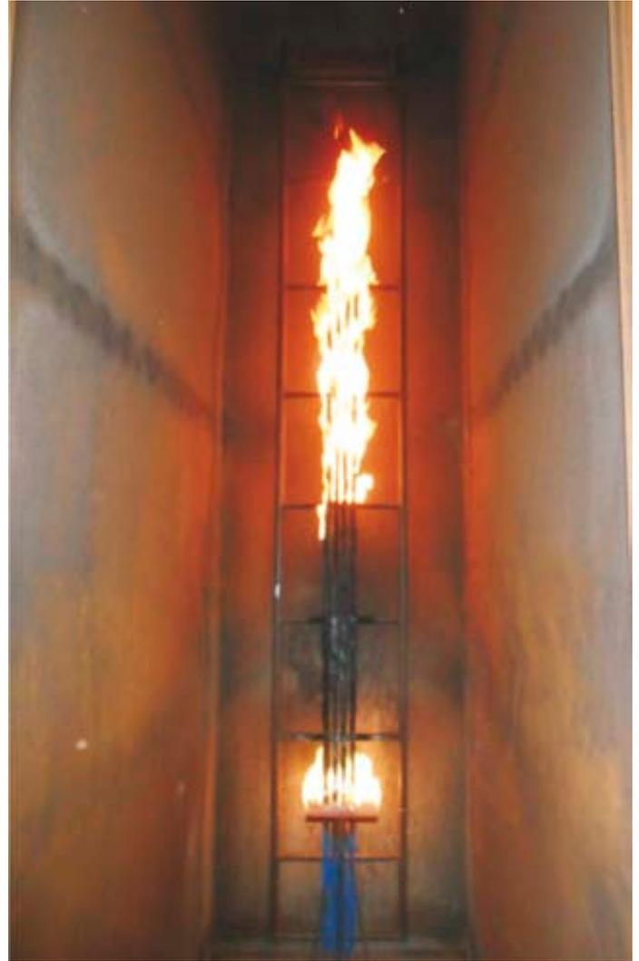
**Test der halogenfreien MEGAFLEX 500-C in einer Brennkammer gem. VDE 0482-332-3/ IEC 60332-3**
