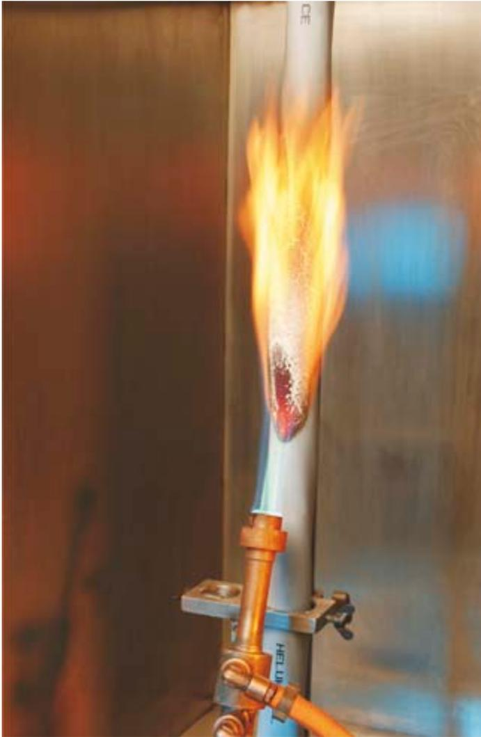
**Brandprüfung gem. DIN VDE 0482-332-1-2 / IEC 0332-1 bei Helukabel im Werk Windsbach: Im Bunsenbrennertest wird eine JZ-HF Datenleitung für den Schleppketteneinsatz getestet.**
