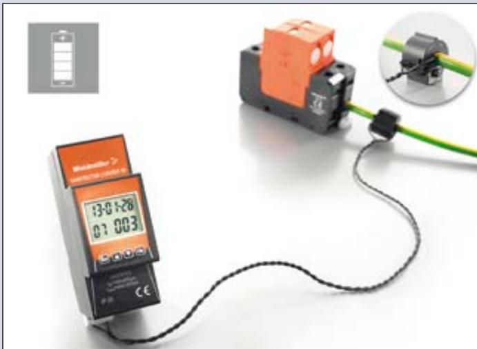
**Plug&Play-Gerät registriert und dokumentiert erhöhte Stromimpulse. Für eine vereinfachte Ursachenermittlung werden die Ereignisse gezählt und mit Datum und Uhrzeit dokumentiert. Detail: Ein Sensor mit Ferrit-Toroid detektiert die Stromspitzen auf dem PE-Leiter.**
