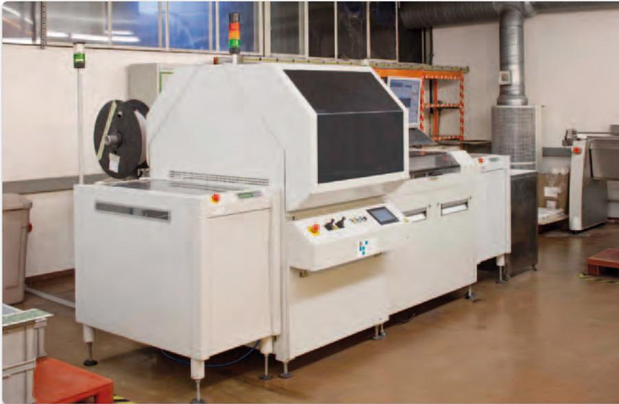
**Bild 1: Zukunftsfähige Lösung: „Standalone“-Platinenbestückung mit Heatsink-Wärmeleitpads ist auf Flexibilität und Einbindung in die Fertigung ausgelegt. (Bilder ASS)**
