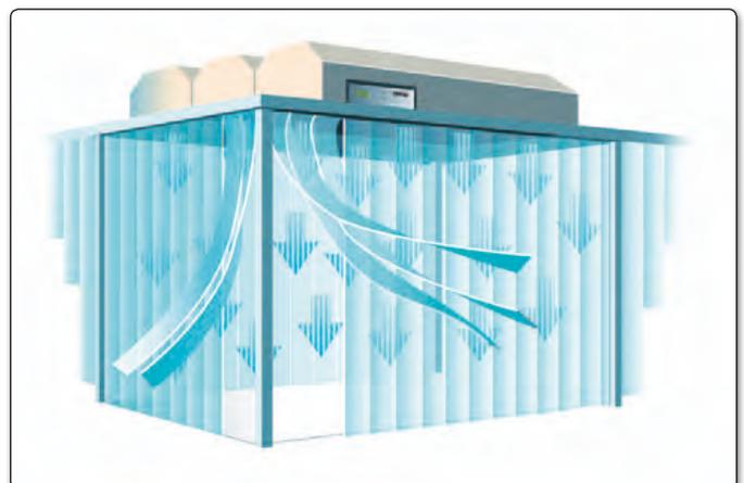
**Bild 2: Reinraumzelle mit drei Modulen**
