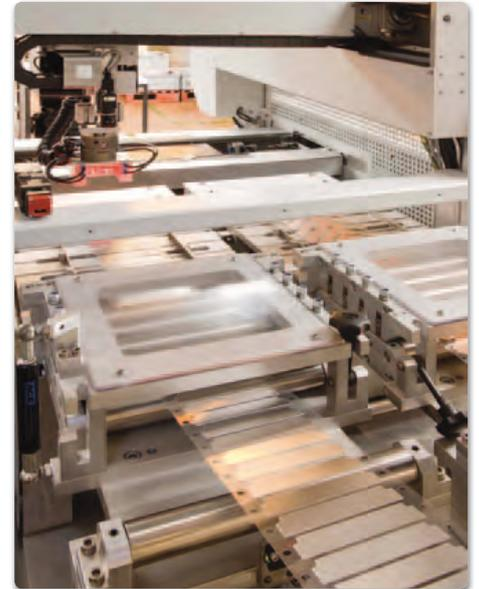
**Bild 2: Die bestückten Folienträger laufen über eine LED-Durchlichtbeleuchtung zur Abzugskante und werden dort einzeln und lagerichtig vom Greifsystem aufgenommen.**
