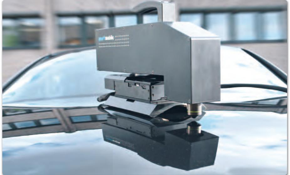
**Bild 2:** Optische 3D-Oberflächeninspektion eignet sich für den Labor- und Industrieinsatz, z.B. in der Automobilindustrie zur Kontrolle des Lackerscheinungsbilds.
