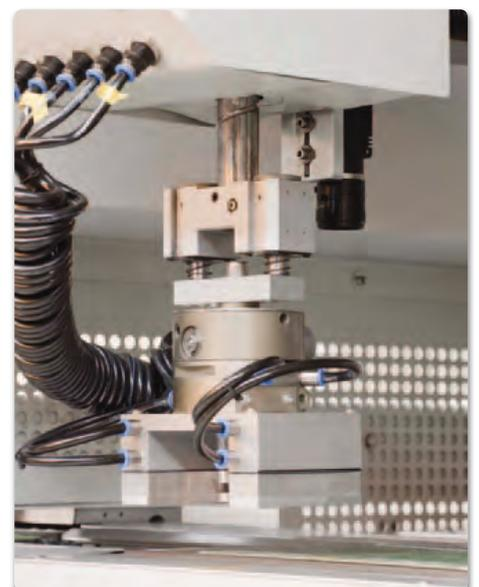
**Bild 3: Der austauschbare modulare Greifer sitzt zusammen mit der Kamera am Greifarm.**
