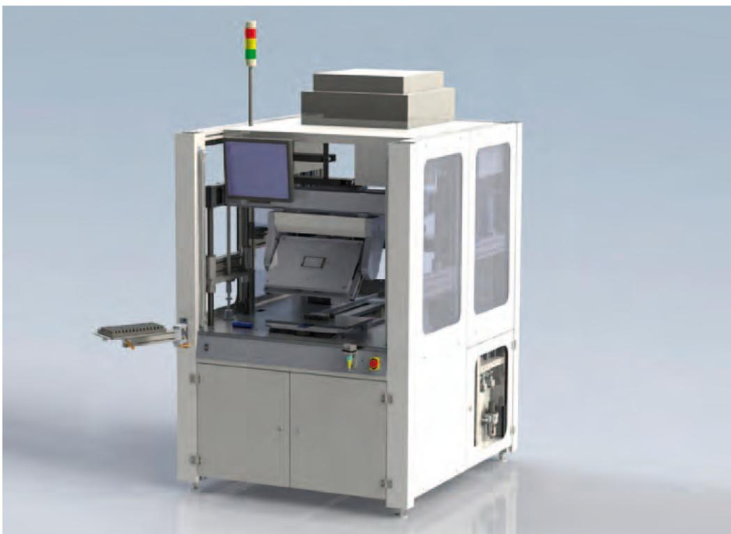
Alle 4 Achsen sind ausgerüstet mit einem Optischen Encoder für einen Closed-loop Prozess. Die Montage des Frontglases erfolgt berührungslos. Das System kann Displaygrößen bis zu 17“ bei 16:9 problemlos aufnehmen.
