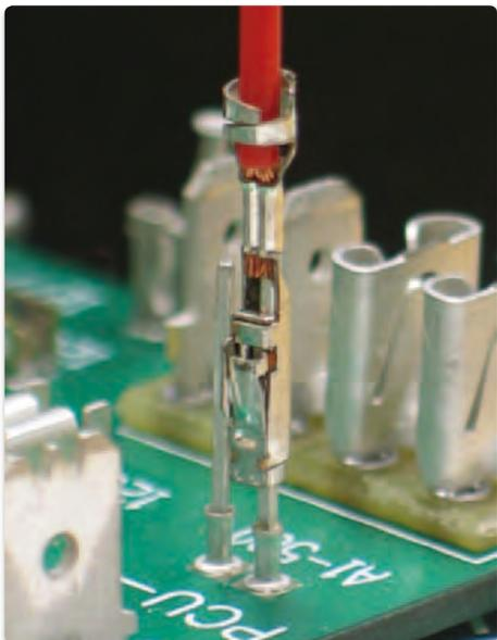
zwischen dem Stift und dem Anschlussstecker. Und die dritte ist die Kontaktfläche zwischen den Leitungsadern und dem Stift.
