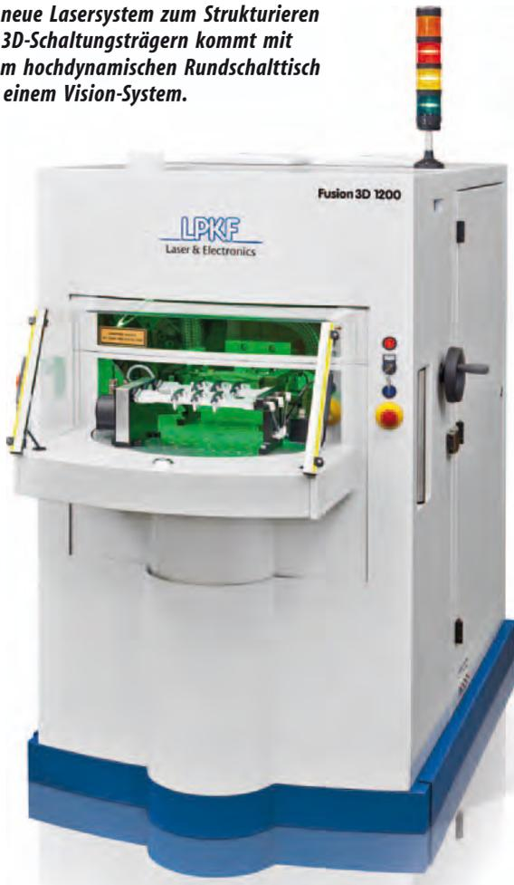
Mit dem jüngsten Modell der Fusion3D-Baureihe erweitert LPKF sein Programm der Hochleistungs-Lasersysteme für die Laser-Direktstrukturierung (LDS). Dabei legt ein Lasersystem Leiterstrukturen auf allen drei Dimensionen eines Kunststoffkörpers an. Auf diesen Strukturen bilden sich anschließend metallische Leiterbahnen. Dies erlaubt eine wirtschaftliche, raum- und gewichtssparende Produktion von spritzgegossenen 3D-Schaltungsträgern.
