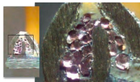
Die Leitung muss vor dem Anschließen nicht abisoliert werden. Die Verbindung wird durch die 2 Kontaktdornen hergestellt, die in die Leitungsadern gepresst werden. Die gebogenen „Crimp-Laschen“ am Anschluss halten die Spitzen in der Leitung und sorgen für eine Zugentlastung des Leiters. Dieses Schneidcrimpverfahren erfordert deutlich weniger Kraft zum Anschließen einer Leitung als konventionelles Crimpen. Daher wird die Stoßbeanspruchung der Platinen-
