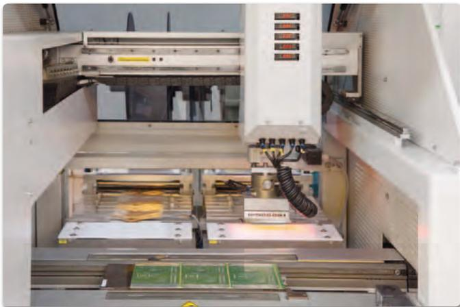
**Bild 4:** Je Zyklus werden bis zu drei Platinen für die Bestückung bereitgestellt.
