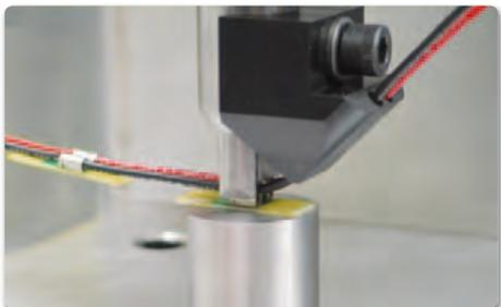
Während der Produktion ist kein separater Schritt erforderlich, um die Leitung in den Anschluss einzulegen. Vielmehr drückt die Anschlusspresse die Leitung automatisch im Anschluss fest.
