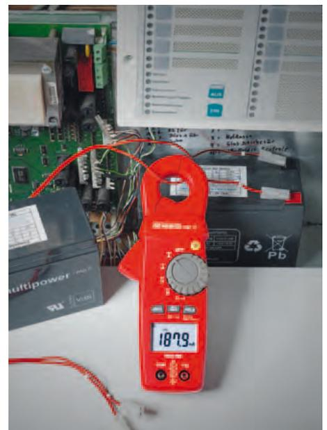
Widerstandsmessung (0,1 Ohm bis 600 kOhm) und die akustische Durchgangsprüfung machen die Mitnahme eines weiteren Digitalmultimeters überflüssig. Praktische Zusatzfunktionen wie Hold-, Min/Max-Speicherung, Zero (Nullabgleich) und eine zuschaltbare Display-Beleuchtung vervollständigen den Funktionsumfang.
