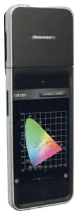
50.000 lux ausmessen. Für verlässliche Farbwerte benötigt das Gerät eine Beleuchtungsstärke von 50 bis 50.000 lux. Die optische Auflösung beträgt 8 nm.
