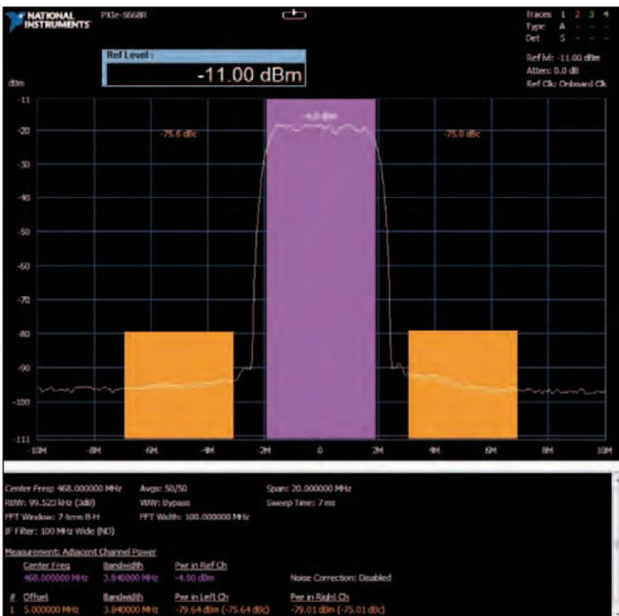
**Bild 16: PXIe 5668R bei der Messung des ASCPR eines WCDMA-Signals mit 100 MHz breitem IF-Filter und ausgeschalteter Rauschkorrektur**
