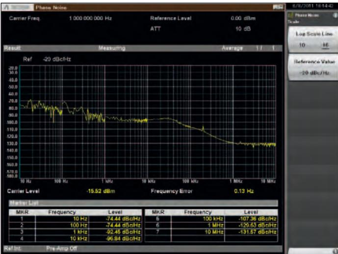
Bild 5: Phasenrauschen im Frequenzabweichungsbereich 10 Hz bis 10 MHz.
