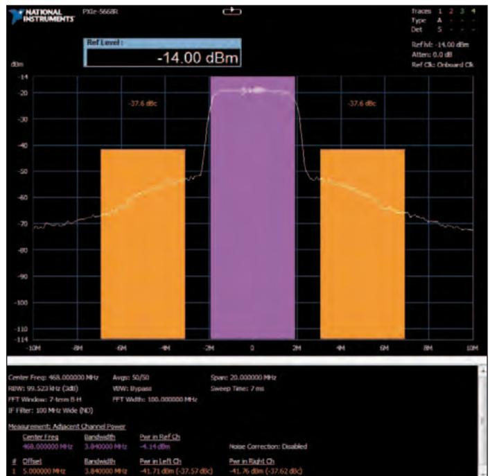
**Bild 17: WCDMA-ACPR-Messung mit dem PXIe 5668R, bei der ADC-Verzerrungen zu sehen sind.**
