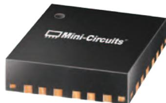
Der Splitter/Combiner EP2K1+ von Mini-Circuits in 50-Ohm-Technik wurde für den Frequenzbereich von 2 bis 26,5 GHz vorgesehen. Er kann bis zu 2,5 W aufteilen bzw. zwei Leistungen bis zu dieser Leistung zusammenführen. Die Mitführung eines Gleichstroms bis 1,2 A (bis 25 °C) ist möglich.
