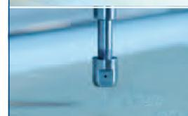
Zuschnitt mittels Wasserstrahltechnik
