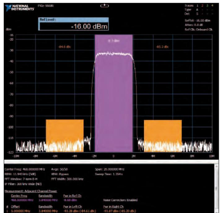
**Bild 18: WDCMA-ACPR-Messung mit dem PXIe 5668 R; verwendet wird ein 300 kHz breites ZF-Filter, die Rauschkorrektur ist abgeschaltet**
