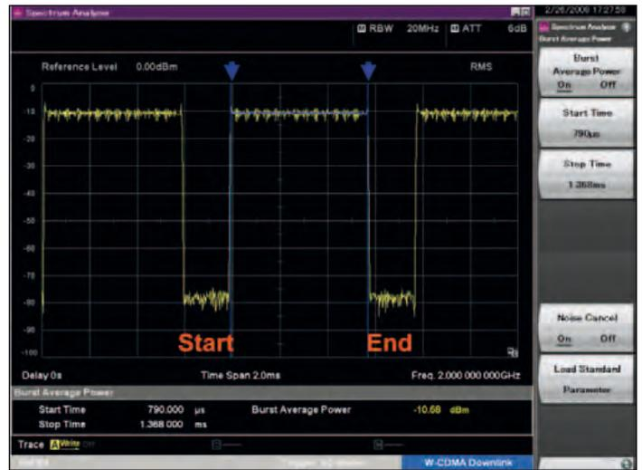
Bild 6: Average In-Burst Power Messung eines Radarpulses
