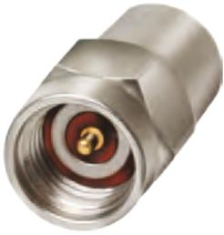
Der Terminationswiderstand ANNE-50K+ von Mini-Circuits lässt sich in einem weiten Frequenzbereich (DC bis 40 GHz) einsetzen. Die Impedanz beträgt 50 Ohm, die Form ähnelt einem 2,92-mm-Stecker. Dieser ist an die Buchsentypen SMA, K und 3,5 mm anschließbar. Bei 4 (40) GHz wird die Rückflussdämpfung mit typisch 35 (20) dB angegeben. Die höchstmögliche HF-Leistung beträgt 1 W. Anwendungen finden sich in den Bereichen Zellularfunk, Satellitenkommunikation, Wehrtechnik sowie Testaufbauten.
