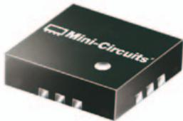
Das neue Tiefpassfilter XLF-151+ von Mini-Circuits bietet durch seine neuartige Halbleitertechnologie auch über der Cut-off-Frequenz 150 MHz eine ohmsche Impedanz (50 Ohm) und reflektiert daher im Stopband theoretisch nicht. Es besitzt ein SMT-Gehäuse mit 3 x 3 mm Grundfläche und weist eine ausgezeichnete Wärmeabfuhr auf. Die Daten sind praktisch temperaturstabil bis 105 °C.
