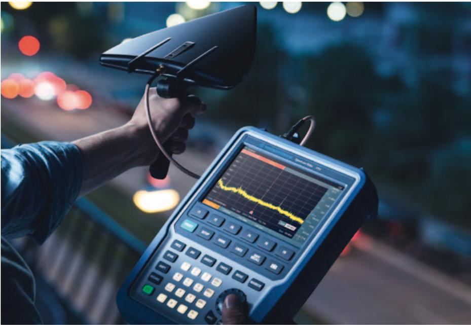
**Der Handheld-Spektrumanalysator R&S Spectrum Rider FPH beim Einsatz im Feld (oben) und im Labor (unten)**
