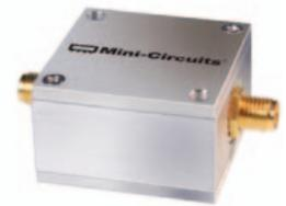
Der neue Begrenzer ZFLM-43-5W+ von Mini-Circuits ist ein 50-Ohm-Baustein für den Bereich 0,02 bis 4 GHz und zeichnet sich durch einen Begrenzungsbereich zwischen 10 und 37 dBm sowie eine Recovery Time von typisch 33 ns aus. Der lineare Bereich (bis 0,1 dB Kompression) wird mit typisch 5 dBm angegeben.
