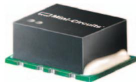
Der Zweiweg-Splitter/Combiner SYPS-2-33+ von Mini-Circuits in 50-Ohm-Technik wurde für den Frequenzbereich von 400 MHz bis 4 GHz vorgesehen und kann vielseitig z.B. für symmetrisch aufgebaute Verstärker oder IQ-Modulatoren, aber auch für GPS, PCS oder CATV eingesetzt werden. Die Gehäusegröße ist 0,38 x 0,5 x 0,25 inch.
