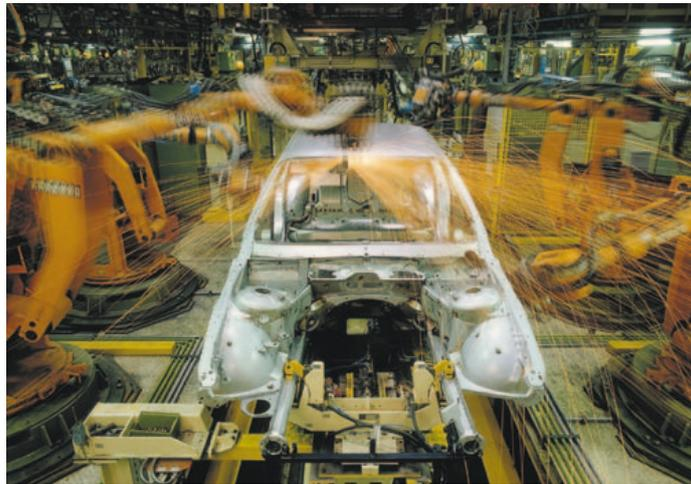
**Bild 1: Roboterschweißgeräte**
