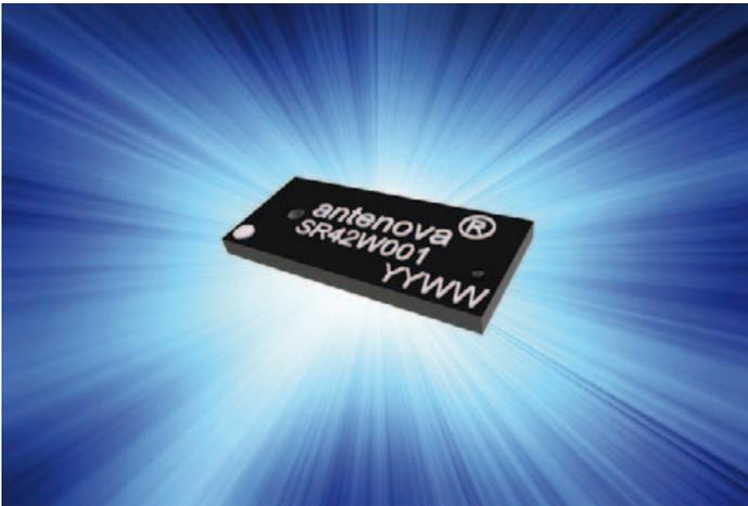
Atlantik Elektronik präsentierte mit der Mutica SR42W001 von Antenna eine WiFi-Antenne für die Frequenzbereiche 2,4...2,5 und 4,9...5,9 GHz. Damit kann die Mutica in kompakten, leistungsstarken WiFi-Applikationen, wie Sicherheits- und Videokameras, Settop-Boxen oder Spielekonsolen, sowie tragbaren Geräten eingesetzt werden.
