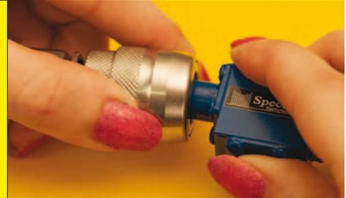
3. Setzen Sie den Adapter auf die Buchse des Gegenstücks auf und bewegen Sie die Schiebemutter ganz nach vorne. Die Feststellmutter muss dabei gelöst sein.
