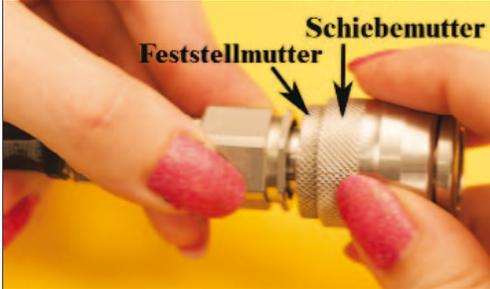
1. Verwandeln Sie ihr Standard-Kabel mit N-Stecker in ein "Push-On"-Kabel mit Hilfe des "Push-On"-Adapters.
