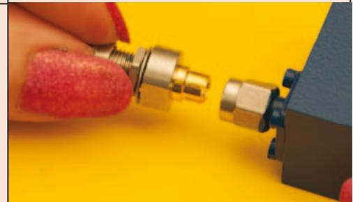
4. Um die Verbindung zu lösen, ziehen Sie die Schnellverbindungs-Buchse einfach ab.
