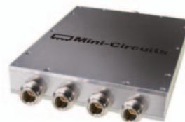
Der neue Splitter/Combiner ZB4PD-462W+ von Mini-Circuits ist für den Frequenzbereich von 380 MHz bis 4,6 GHz vorgesehen und kann bis zu 30 W auf vier Ausgänge aufteilen bzw. von dort zusammenführen. Dabei besteht ein DC-Pass 1 A bzw. 250 mA/Port. Die Port-to-Port Isolation des robusten 50-Ohm-Bausteins wird mit typisch 23 dB angegeben, die Amplituden- wie die Phasen-Unsymmetrie sind gering.
