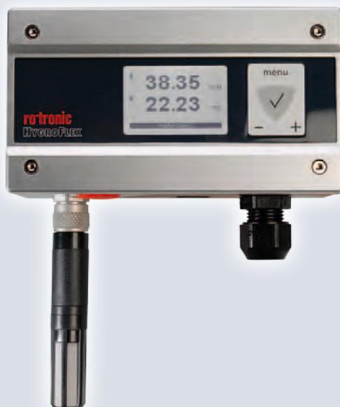
sortechnologie auf die Spitze getrieben: Die HS5-Messumformer bieten eine Reproduzierbarkeit von <0,02 %rF und mit dem HC2-S eine garantierte Systemgenauigkeit von 0,8 %rF und 0,1 K.
