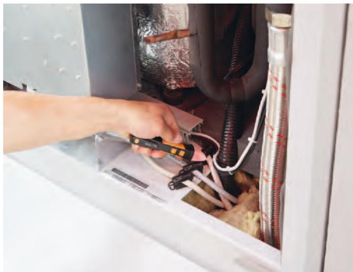
**Bild 2: testo 745 - kontaktloser Spannungsprüfer mit Tiefpassfilter**
