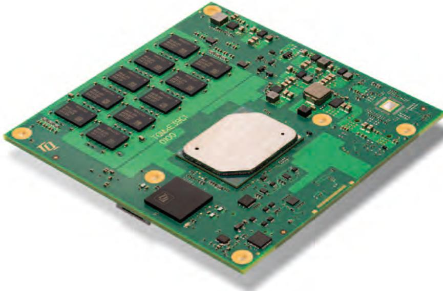
Das neue COM Express Compact Modul TQMxE39C1 von TQ ist mit Intel Atom Prozessoren der neuesten Generation (Codename „Apollo Lake“) erhältlich und besticht durch technische Eigenschaften, die für Harsh- und Rugged-Anwendungen optimiert sind. Die Kombination aus gelötetem Arbeitsspeicher von 4/8 GB Dual Channel DDR3L, ECC, der Spezifika-
