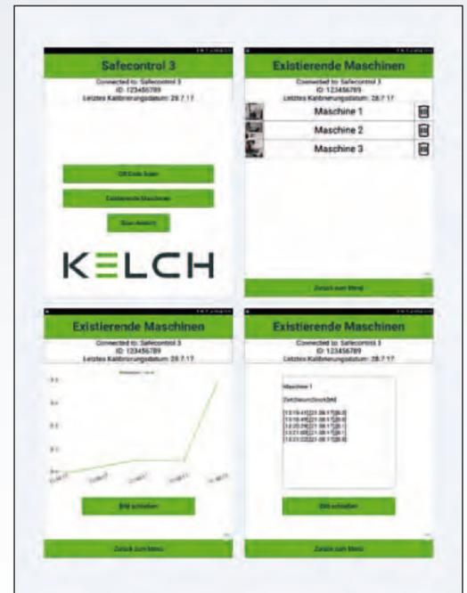
**Bild 3:** Die zu messenden Spindeln werden mittels QR-Code eindeutig identifiziert
