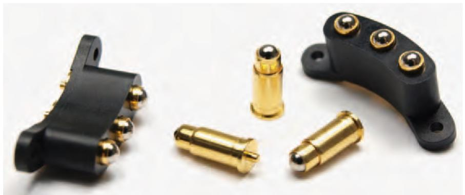
tet. Je nach Material und innerem Aufbau des Federkontaktstiftes sind Ströme bis zu 3 A pro Pin möglich, der Kontaktwiderstand liegt bei <100 mOhm. Mit einer Lebensdauer von über 200.000 Zyklen sind die Federkontakte sehr langlebig und zuverlässig. Der Rolling Pin ist bisher in 3 Standardausführungen mit einer
