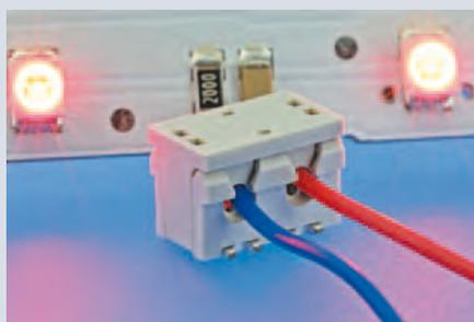
lötprozesses. Der neue Verbinder von W+P ist bestens geeignet, um LED-Platinen in flexiblen Längen und Winkeln zu verbinden. Sehr interessant ist dies in Anwendungsbereichen, in denen nicht im voraus festgelegt werden kann, welche Länge genau benötigt wird.
