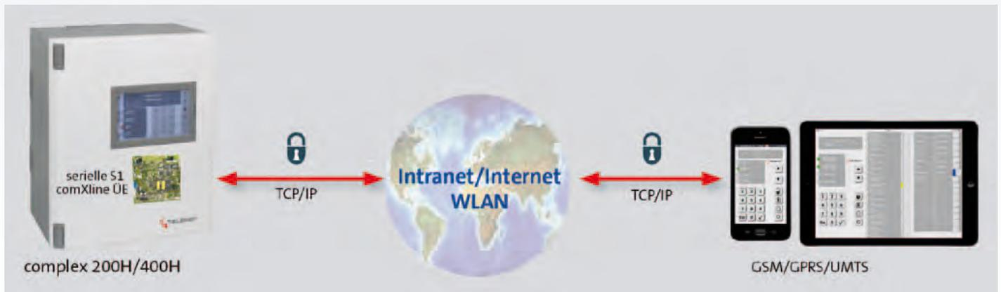
**Funktionsprinzip der Alarmanlagen-App BuildSec via TCP/IP (Alle Bilder: Telenot)**
