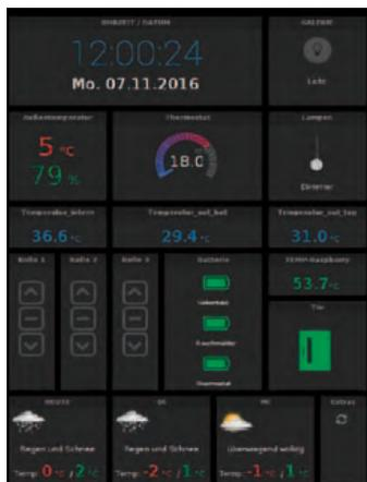
**Dieser Screenshot zeigt beispielhaft, wie sich Funk-Produkte von Selve in andere Systeme einbinden lassen. Bei der mit FHEM erstellten Oberfläche sind drei iveo-Rolladenantriebe von Selve integriert worden**
