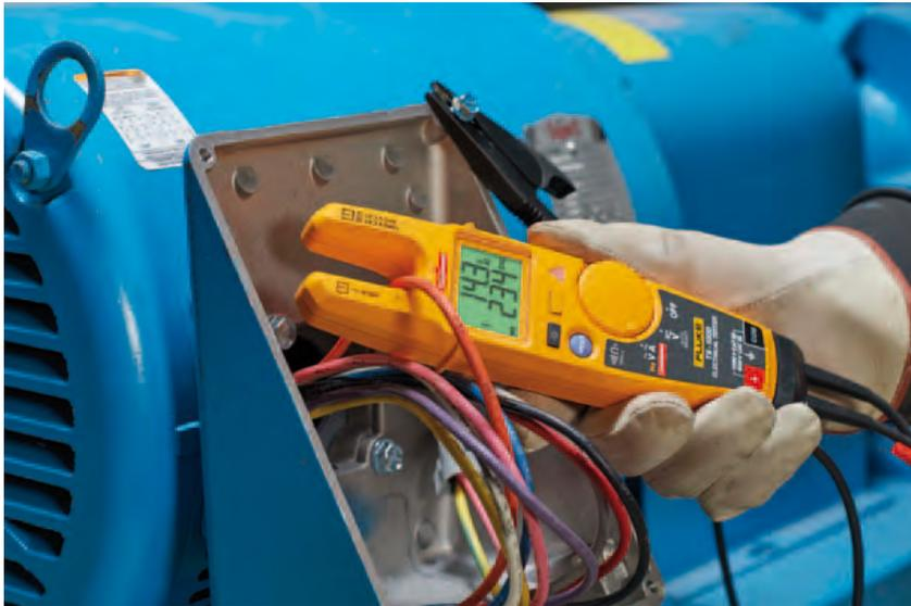
len kontaktiert werden müssen. Anwender führen einfach den Leiter in die Gabelöffnung und können den Spannungswert messen. Anders als ein normales Spannungsmessgerät können diese neuen Elektrotester zuverlässige Spannungs- und Strommesswerte liefern – ohne Messleitungen und ohne Kontakt mit einem blanken elektrischen Leiter.
