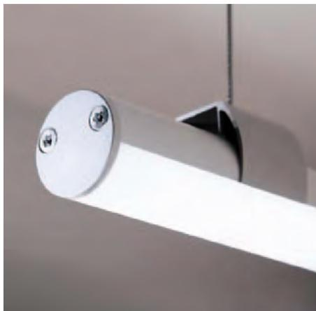
*Lyra mit einem runden, filigranen Aluminiumprofil besitzt einen Durchmesser von 20 mm und ermöglicht den Einsatz von drei runden Abdeckungen in Klar, Diffus und Opal für weiche Lichtlinien und drei Linearlinsen in 10°, 30° und 60° für präzise Lichtlenkung*
