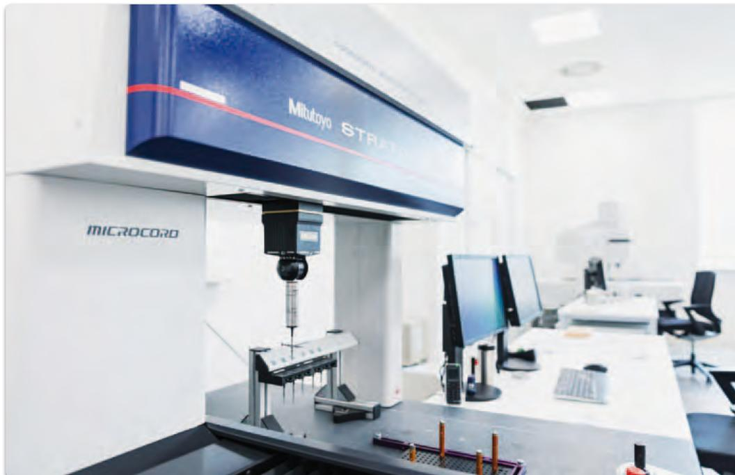
**Die Halle beherbergt unter anderem auch einen 70 m<sup>2</sup> großen Messraum, in dem zum Beispiel Messungen von lasergebohrten Löchern mit einer Wiederholbarkeit von 0,3 µm erfolgen**
