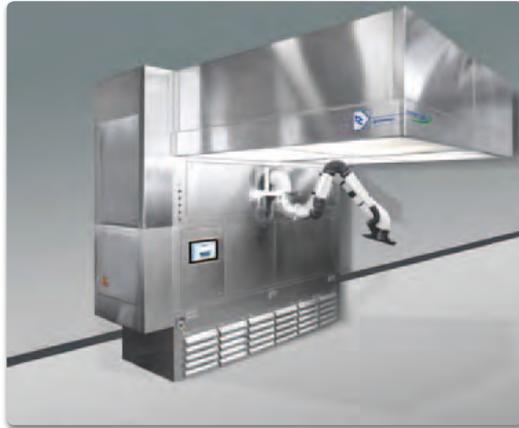
Bei den Wiegekabinen lassen sich durch die abwärts gerichtete Reinstluftströmung im Inneren manuelle Umfüllprozesse von pulverförmigen Einsatzstoffen in einer mikrobiologisch kontrollierten Produktionsumgebung durchführen. Bilder: bc-technology
