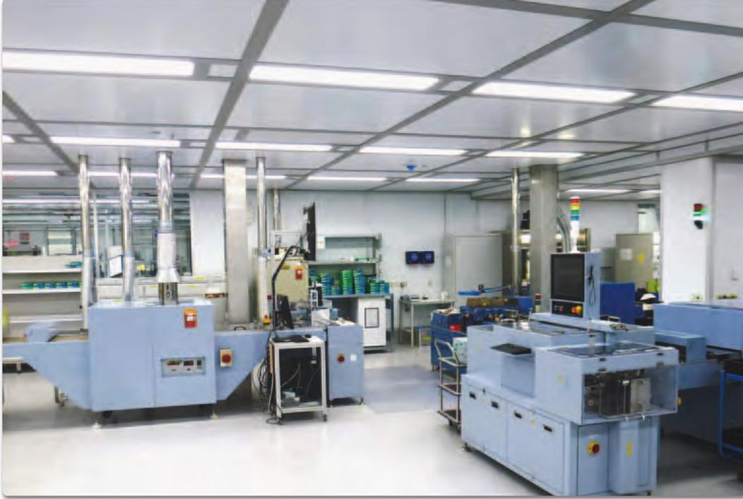
Herstellung von hochstabilen Widerständen in der neuen Reinraumanlage von Vishay in Selb
