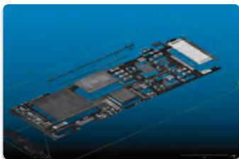
Auf der China International Machine Vision Exhibit in Shanghai präsentiert VRmagic Imaging vom 14. bis 16. März 2018 seinen 3D-Sensor LineScan3D mit einem Messfeld von 74 mm Breite und 76 mm Höhe bei einer Subpixelauflösung im Bereich von 1,5 µm. Damit ist der GigE-Vision-kompatible 3D-Scanner besonders geeignet für die automatische optische Inspektion (3D AOI) von bestückten Leiterplatten.
