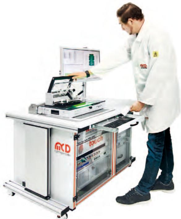
**Bild 1: Der VTS 2030 Tester: Vielseitig durch leicht zu wechselnde Prüfadapter, anwenderfreundlich durch Höhenverstellung, sicher durch automatisches Berechtigungsmanagement über RFID-Karten**
