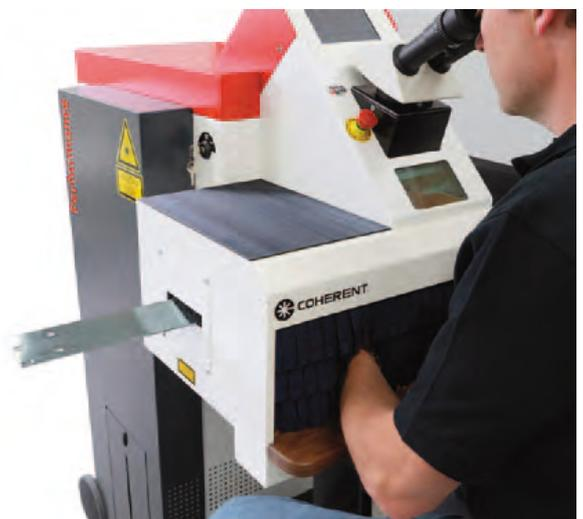
**Bild 2: Handschweißlaser mit durchdachten Detaillösungen wie einer ergonomischen Handauflage, seitliche Werkstückzuführung etc.**
