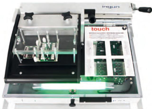
**Bild 2: Prüfadapter für einen Platinentest. Rechts die Baugruppen des MCD Modul-Messsystems 2030. Der grüne Leuchtbalken signalisiert: Prüfling o.k.**
