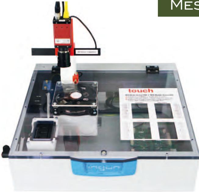
**Bild 4: Dieser Prüfadapter ist für den zusätzlichen optischen Test von Lüftern auch mit einer Kamera ausgestattet**
