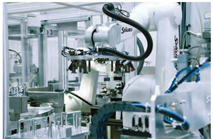
**In der kompletten Anlage für die Montage von Gangstellern kommen ausschließlich Roboter in ESD-Ausführung gegen elektrostatische Aufladung zum Einsatz**
