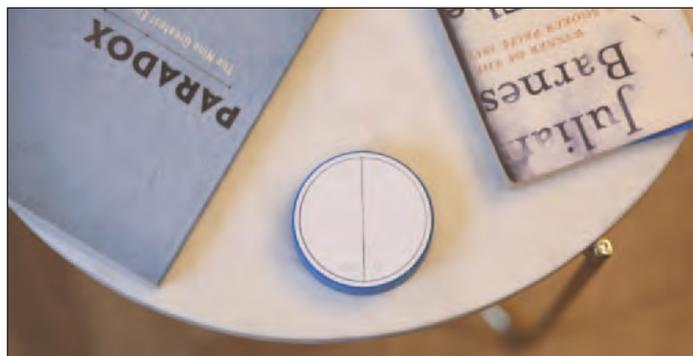
Der kabellose Beyon-Taster ist eine batterie lose Fernbedienung mit zwei oder vier Kanälen
