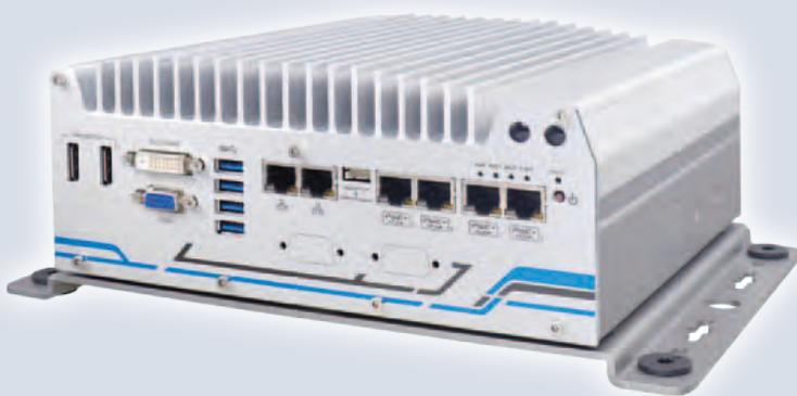
Nuvo-5608VR ist ein neues mobiles Überwachungssystem für Echtzeit-Videoanalyse und Streaming. Es beinhaltet die 6. Generation Core i CPU, IP-Kamera-Konnektivität und mas-
