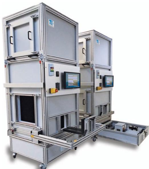
Viele Unternehmen, die elektronische Komponenten und Systeme entwickeln, nutzen mobile Messkammern zur Optimierung ihrer Produkte. Hierbei kann bereits im Rahmen der entwicklungsbegleitenden Prüfung der EMV-Konformität (EMV-Pre-Compliance-Test) festgestellt werden, ob die vorgegebenen Grenzwerte hinsichtlich Störemissionen und Störfestigkeit entsprechend eingehalten werden.
