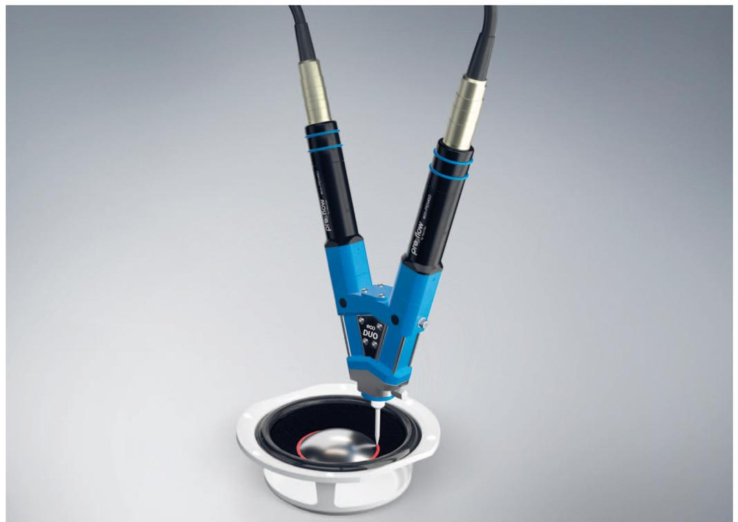
**Bild 3: Bonding Anwendung: preeflow eco-DUO 2K Dispenser bei der Lautsprecherklebung**
