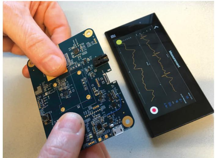
Zur Blutsauerstoffgehaltbestimmung dient die Absorptionsrate des Hämoglobins von rotem- und nah-infrarotem Licht.
