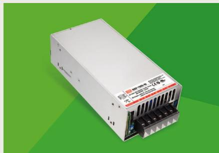
600-Watt-Serie MSP-600 zu haben. So kann ein Austausch problemlos stattfinden, ohne den Systemplatz anpassen zu müssen. Wenn noch mehr Leistung benötigt wird, können bis zu vier Netzteile parallel angeschlossen werden. Dank eingebauter Current-Sharing-Funktion wird die Last gleichmäßig auf die einzelnen Netzteile verteilt.
