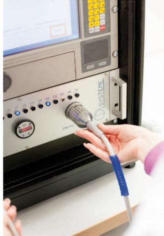
**End-of-Line-Prüfsystem für Instrumentenschläuche**
