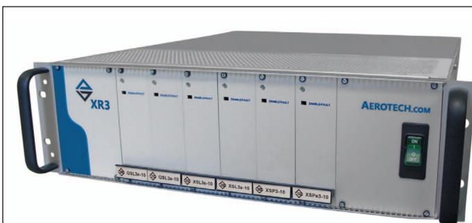
**Bild 3: Das XR3-Rack verfügt über sechs Achsen mit vor Ort austauschbaren, frontseitigen 3U-Plug-In-Verstärkern. Die Aerotech-Entwicklung unterstützt sowohl lineare als auch PWM-Topologien**
