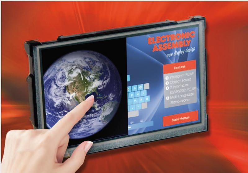
Das kompakte TFT-Farbdisplay EA uniTFT050 wurde speziell für den Einsatz in kompakten, medizintechnischen Geräten entwickelt. Dank integriertem Befehlssatz und objektbasierter Layoutsoftware gelingt das Erstellen moderner Benutzeroberflächen auch ohne Expertenwissen komfortabel per Drag-and-Drop.
