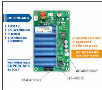
**Bild 7: Das SuperCap-DC-USV-Modul UPSIC kann zur Absicherung von Aktoren, Sensoren oder kompakter Embedded-Computersysteme direkt in die Applikation integriert werden**
