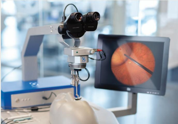
**Der Augenchirurgie-Simulator Eyesi Surgical bietet ein neues, virtuelles Stereomikroskop, das dem Betrachter ein großes dreidimensionales Sichtfeld mit einer detailgenauen Auflösung eröffnet. Der digitale Mikroskopkopf wurde in Kooperation mit Haag-Streit Diagnostics entwickelt. (Copyright VRmagic)**
