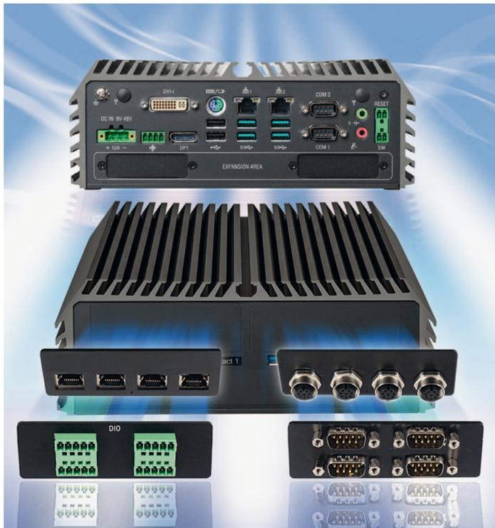
Comp-Mall stellt die neue robuste Embedded-Computer-Serie DS-1200 vor. Das System ist mit dem Intel Q370-Chipsatz ausgestattet und unterstützt die 8. Generation des Intel Core/ Pentium / Celeron 35 W/65 W LGA 1151-Prozessors. Der neue Intel Core-Prozessor der 8. Generation (Coffee Lake) bietet erstmals bis zu 6 Kerne, 12 Threads und höhere Rechenleistung im Vergleich zur vorherigen Generation (Kaby Lake). Der Star ist der bis zu
