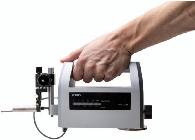
Accretech präsentiert mit der neuen SURFCOM-TOUCH-Baureihe fünf neue kompakte Oberflächenmessgeräte mit einer Auflösung von 0,1 Nanometern, die insbesondere für kleine und mittelständische Unternehmen geeignet sind.
