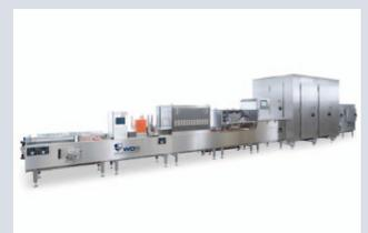
ten Edelstahlgehäuse: ein Schaltkasten mit Touch-Panel-PC und ein direkt über der Transportlinie positioniertes Gehäuse mit einer GigE-Farbkamera, LED-Beleuchtung und Schutzscheibe. Restverschmutzungen bis zu einer Größe von 1 mm<sup>2</sup> werden zuverlässig erkannt.
