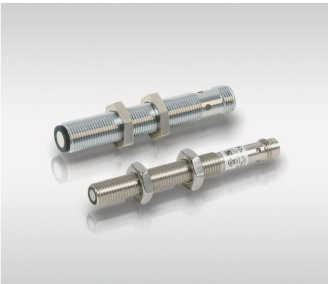
Turck erweitert seine RU-Ultraschall-Familie um zehn Miniatur-Ultraschallsensoren in M8 und M12-Ausführung. Passend zur RU-Familie haben die neuen M12-Sensoren sowohl einen Analog- als auch einen Schaltausgang, dessen Schaltbereich immer den eingestellten Messbereichsgrenzen des Analogausgangs folgt. Durch ihre kompakte IP67-Bauform und ihre schmale Schallkeule eignen sich beide Sensor-Varianten optimal für den Einsatz in kleinen Applikationen mit beengten Platzverhältnissen.
