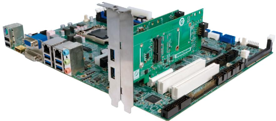
Video-, USB- oder spezielle I/O-Karten einzusetzen. Erweiterungen lassen sich über einen miniPCIe (mSATA), 2x PCI, 2x PCIe x8 sowie 4x PCIe x4 realisieren. Dank dem optionalen iRIS Remote Management Moduls kann der Computer fernüberwacht und gesteuert werden. Mögliche Einsatzgebiete des IMBA-Q170-i2
