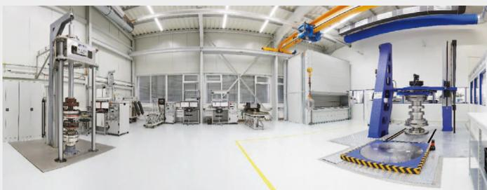
**MANNER Kalibrierlabor mit fünf Prüfständen von 200 Nm bis 500 kNm**
