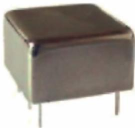
Die Vertreter der OCXO2526C-Serie von Dynamic Engineers können Frequenzen im Bereich 30...300 MHz ausgeben und nutzen dabei einen internen Frequenzmultiplizierer 3x oder 5x. Diese SMD-OCXOs haben ein Phasenrauschen von -135 dBc/Hz bei 1 kHz und eine Stabilität von  $\pm 3$  ppb über
