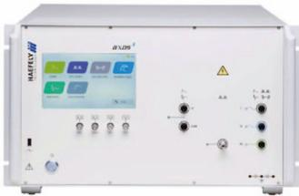
Der Fast-Transient-Burst-Test nach IEC/EN 61000-4-4 simuliert Störungen, die bei Einschaltvorgängen großer Verbraucher oder durch einen schlecht entstörten Elektromotor mit Bürstenfeuer auf Leitungen verursacht werden. Der Surge-Test nach IEC/EN 61000-4-5 simuliert die Auswirkungen von Blitzeinschlägen auf das Stromnetz oder das Abschalten schwerer Lasten. Netzunterbrechungen und Spannungseinbrüche nach IEC/EN 61000-4-11 sind Prüfungen auf Störfestigkeit gegen schwankende Netzqualität.
