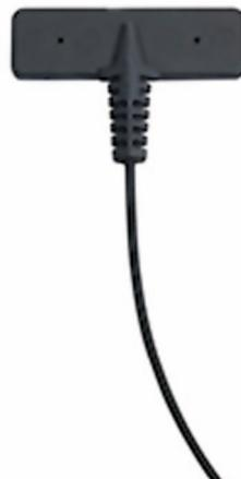
Die WV-COVDB2458 ist eine 2,4/5-GHz-Bluetooth/WiFi-Bandmontage-Antenne (tape mount, mit einem Klebeband zu befestigen). Der Gewinn erreicht bis zu 6 dBi, und bis zu 10 W HF-Leistung werden verkraftet. Diese für Indoor- und Outdoor-Betrieb geeignete Antenne misst 57,1 x 19 x 4,4 mm. Weitere Daten:
