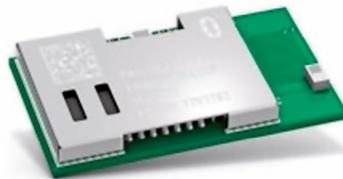
Das PAN1762 von Panasonic ist ein für Bluetooth 5.0 (2402...2480 MHz) geeignetes Low-Energy-HF-Modul, das auf dem Toshiba-Einchip-Controller TC35680 basiert. Der neue Standard Bluetooth 5.0 erlaubt höhere Datenraten bis 2 Mbps. Die hohe Ausgangsleistung bis zu 8 dBm und die herausragende Empfindlichkeit des TC35680 in Kombination mit dem geringen Leistungsverbrauch (gemäß LE coded PHY) machen das Modul sehr attraktiv für Applikationen, bei denen es gilt, eine große Entfernung zu überbrücken.
