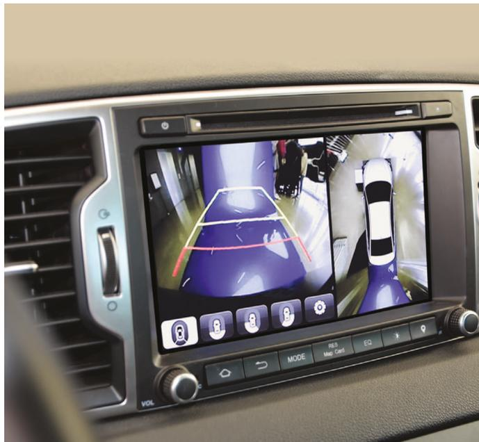
Die neuen Transmitter ADV7990 und ADV7991 sowie die Empfänger ADV7380 und ADV7381 nutzen die Car-Camera-Bus-Technologie (C<sup>2</sup>B) von Analog Devices, welche erhebliche Einsparungen bei Gewicht, Abmessungen und Kosten erzielt und den Verdrahtungsaufwand gegenüber anderen Automotive-
