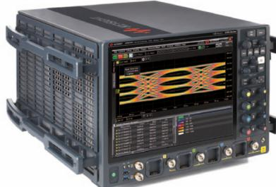
Keysight Technologies hat seine neue Infiniium-UXR-Serie von Oszilloskopen angekündigt, deren Modelle analoge Bandbreiten von 13 bis 110 GHz abdecken und eine bisher unerreichte Signalintegrität bieten. Aufgrund ihrer Skalierbarkeit werden die Oszilloskope heutigen und zukünftigen Anforderungen gerecht und gewährleisten so einen umfassenden Investitionsschutz.
