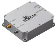
Der M.50008G2144VV von Elite RF ist ein breitbandiger Low-Noise-Verstärker für 0,5 bis 8 GHz. Seine Verstärkung erreicht bis zu 44 dB und sein Rauschmaß beträgt 1,5 dB. Der Verstärker liefert eine Leistung von über 20 dBm an 8 bis 18 V<sub>DC</sub>. Die Abmessungen des Moduls betragen 3,5 x 3 x 1 Inch. Das Class-A-Modul eignet sich optimal für CW/Digital/Pulse-Signale und allgemeine Anwendungen. Dieses Produkt hat eine Garanzzeit von fünf Jahren.
