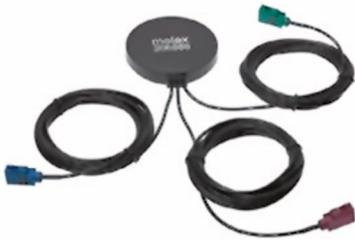
Bei der 206866-3000 von Molex handelt es sich um eine 3-in-1-Antenne für 4G, WiFi und GPS. Sie eignet sich besonders für Telematik, Fernsteuerungs-Monitoring oder Tracking. Dieser vollsymmetrische Dipol ist nach IP66 geschützt und mit einem zylindrischen Gehäuse mit den Maßen 77 mm (Durchmesser) x 15 mm versehen. Es gibt drei Anschlüsse von je 3 m Länge mit FAKRA-Konnektoren, sodass die Antenne vielseitig verwendet werden kann.
