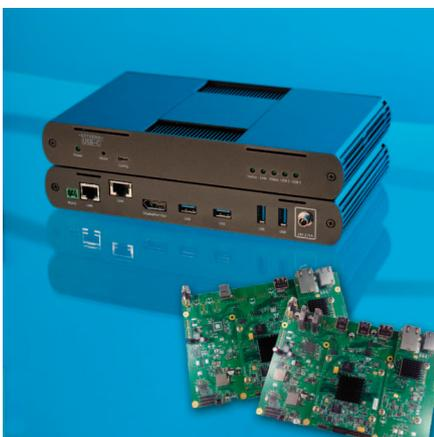
zigen Extender vor, der alle USB-Modi plus DisplayPort über ein einziges CAT6e-Kabel überträgt: Maverick 63104
