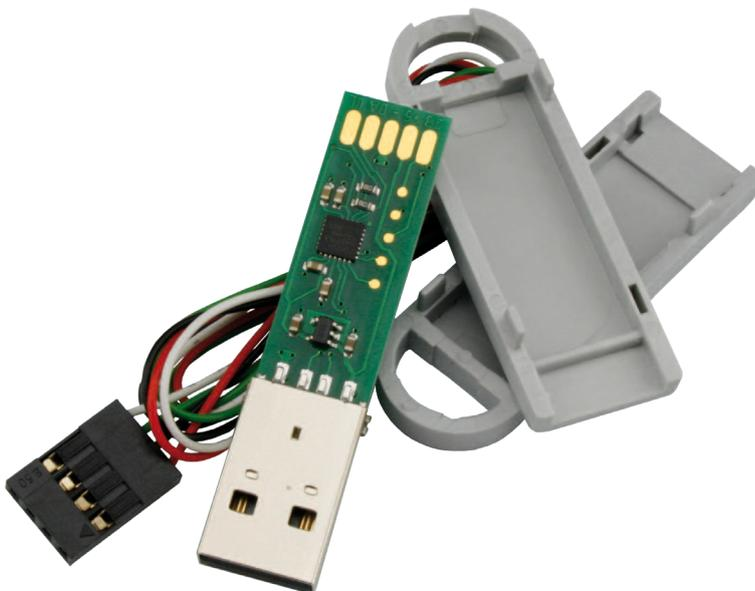
unterstützt. Die Bauform entspricht exakt den maximalen Abmessungen für einen USB-A-Stecker. So können auch mehrere der Dongles verwendet werden, ohne benachbarte USB-Ports zu blockieren.
