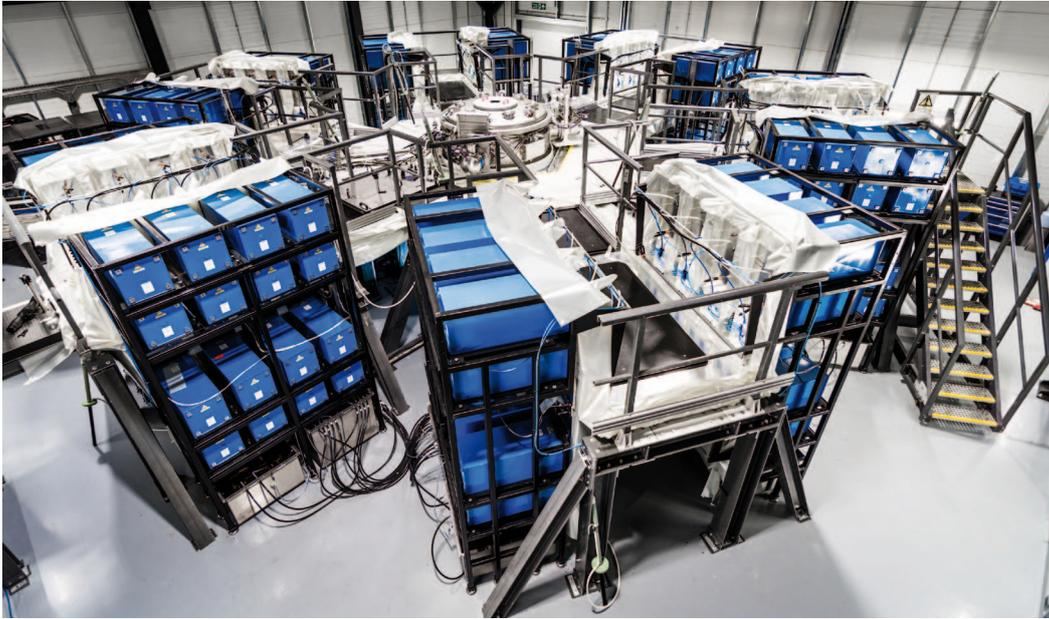
Maschine 3: Die Vakuumkammer, umgeben von 192 Kondensatoren
