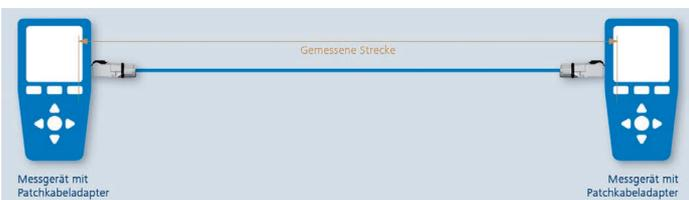
**Beispiel für die korrekte Messung bei Direct Attach Cabling. Quelle: Telegärtner**
