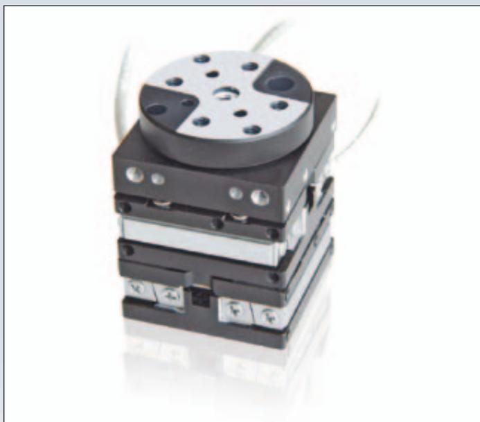
Mit nur 22 mm Breite, Stellwegen bis 26 mm und einer Auflösung bis 1 Nanometer im geregelten Betrieb ist der Lineartisch LPS-22 einer der kleinsten auf dem Markt verfügbaren Präzisionslinearversteller. Dabei erreichen die Lineartische Geschwindigkeiten bis 10 mm/s. Die Rotationsversteller der Serie RPS werden mit einem kleinsten Plattfordurchmesser der Drehscheibe von 14 mm angeboten und bieten Geschwindigkeiten bis 45%/s.
