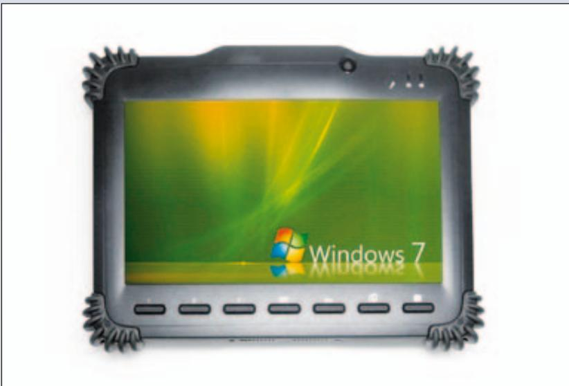
(22,9 cm) große LED-Display besitzt 1024 x 600 (WSVGA) Bildpunkte und gewährleistet sogar bei Sonneneinstrahlung gute Ablesbarkeit. Optional ist ein Sonnenlichtdisplay mit erhöhtem Kontrast und Helligkeit erhältlich. Mit Hilfe des resistiven Touchscreens lässt es sich bequem und schnell per Finger oder Stift bedienen.
