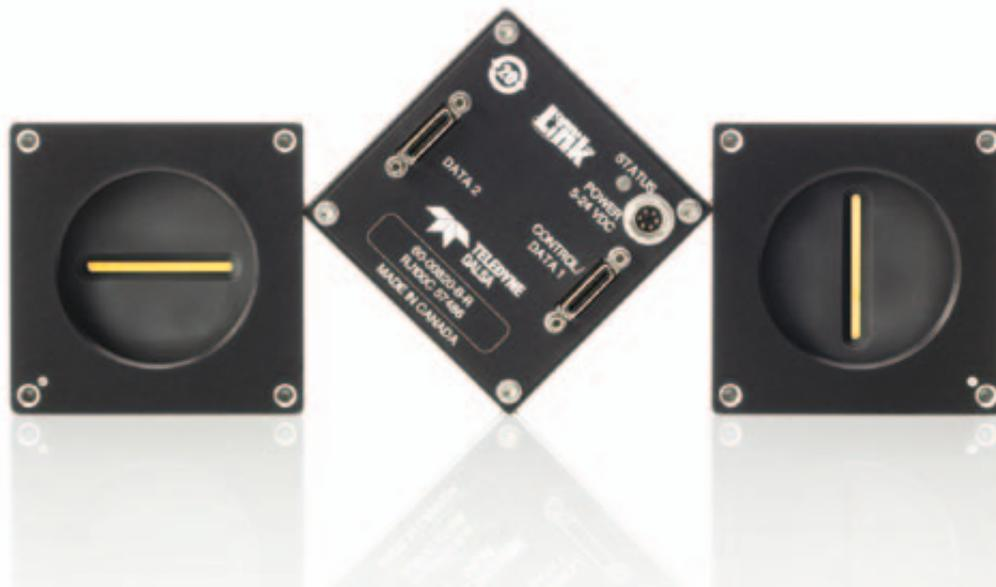
Die Linea ist eine kompakte und robuste Kamera mit geringem Gewicht. Ein M42x1-Schraubgewinde sowie C- und F-Mount-Objektivadapter stehen zur flexiblen Objektiv-Auswahl zur Verfügung. Mit einem Funktionsumfang, den man sonst nur bei den High-End-Zeil-
