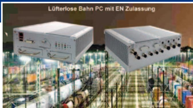
Neu bei NST sind die lüfterlosen BAHN PC ART -3250 und ARTS-3672. Während ARTS-3250 einen Doppelkern ATOM CPU mit 1,86 GHz hat, ist ARTS -3672 mit einer Core i7 CPU 2610UE mit 1,5 GHz
