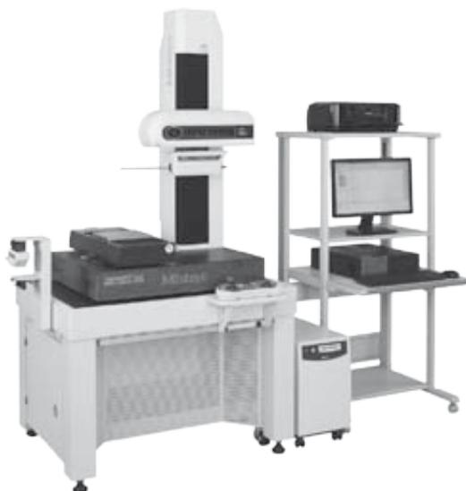
sung. Mit einer Verfahrensgeschwindigkeit von 80 mm/s in der X-Achse sowie 30 mm/s in der Z-Achse gehören die Mitutoyo-Geräte zu den schnellsten Systemen ihrer Art am Markt.
