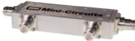
Bei dem Richtkoppler SGBDC20-33HP+ von Mini-Circuits handelt es sich um eine 50-Ohm-SMT-Baugruppe mit nominell 20 dB Koppelfaktor. Der zweiseitige Kopppler ist in einem Frequenzbereich von 300 MHz bis 3 GHz einsetzbar. Korrekt angepasst am Ausgang ist eine Durchgangsleistung bis 250 W möglich, bei offenem oder kurzgeschlossenem Ausgang deutlich weniger.
