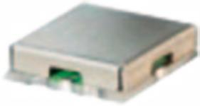
Das Hochpassfilter RHP-700+ von Mini Circuits in 50-Ohm-Technik ist ein SMD mit den Maßen 0,35 x 0,35 x 0,15 Zoll. Der Nennbereich ist 700 MHz bis 3 GHz. Anwendungsbereiche sind beispielsweise die Mobilkommunikation und die Welt- raumforschung (Radioteleskopie).
