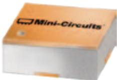
Die festen Dämpfungsglieder der RCAT-Serie von Mini-Circuits sind für 50 Ohm Systemimpedanz und Leistungen bis 2 W ausgelegt. Ihre Einsatzbandbreite reicht bis 20 GHz. Das keramische Gehäuse vom Typ LTCC misst lediglich 2,25 x 2,25 x 1,1 mm<sup>2</sup>.
