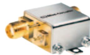
Der rauscharme Breitbandverstärker ZX60-P103LN+ von Mini Circuits hat ein typisches Rauschmaß von 0,5 dB bei 1 GHz. Dies wurde mit E-PHEMT-Technologie erreicht. Der Verstärker ist zwischen 50 MHz und 3 GHz einsetzbar. Geringes Rauschen und Breitbandigkeit schließen einen hohen Dynamikbereich bei relativ geringer DC-Leistungsaufnahme nicht aus. Für 1 GHz wird ein typischer IP3 von 29,9 dBm angegeben.
