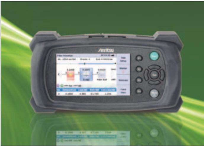
Anritsu führte den Fiber Visualizer für seine Network-Master-Plattform MT9090A ein. Damit wird eine Testlösung für den Außendienst geschaffen, die die Durchführung hochgenauer Messungen an Glasfaserkabeln, Verbindern und Spleißstellen während der Installation bzw. Wartung von High-speed-, FTTH-, CATV-, Access-
