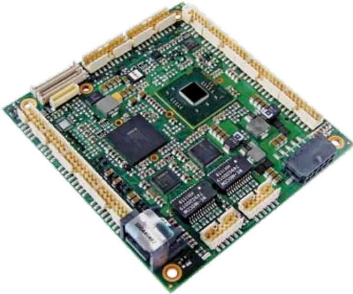
Die CPU-Baugruppe basiert auf dem 1,6 MHz schnellen Intel-Atom-Dual-Core-Prozessor N2600 mit integrierter Grafik und Speicher-Controller-Funktionen sowie auf dem Intel-ICH9M-E- (SFF) Chipsatz. Dieser bietet eine PCIe/104-I/O-Bandbreite von 2,5 GT/s. Der SBC hat eine TDP (Thermal Design Power) von 3,5 Watt und ver-
