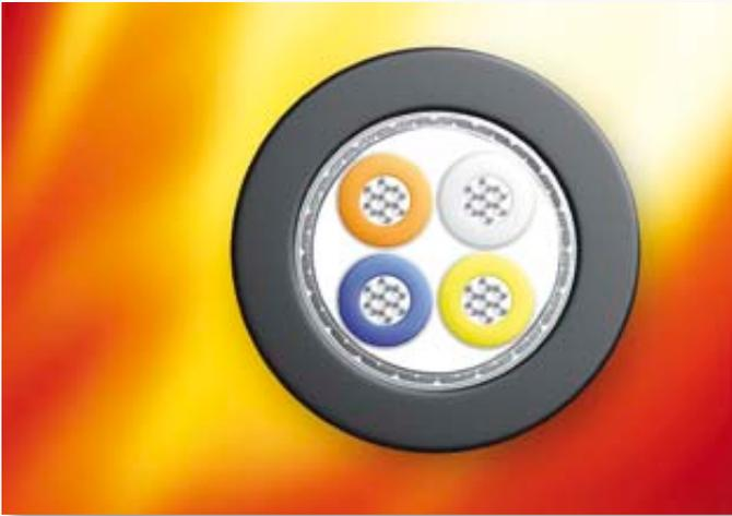
Das neu entwickelte Industrial Ethernet-Cat.5e-Kabel aus der FieldLink Produktfamilie von Leoni zeichnet sich durch seine extreme Feuerfestigkeit aus. Die einzelnen Adern sowie der Schirm des Kabels werden durch eine feuerfeste Folie geschützt, die für hohe Temperaturen ausgelegt ist.
