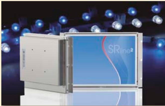
verfügt der Industrie-PC über die üblichen I/O-Ports wie USB (2-fach extern), GBLan (2-fach) und RS-232 seriell
