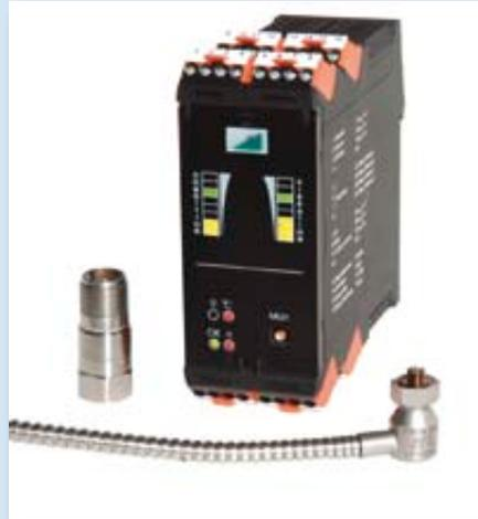
Schwingungssensoren gemessenen Maschinenschwingungen und errechnet hieraus den RMS-Wert der Schwinggeschwindigkeit oder -beschleunigung in drei definierbaren Frequenzbändern. Zusätzlich werden Stoßpegel und Crestfaktor berechnet, so dass auch Veränderungen in einem Lager frühzeitig detektiert werden. Mittels induktiven oder digitalen Drehzahlsensoren lassen sich die Frequenzbereiche für die Pegelanalyse bei Drehzahl-geregelten Maschinen steuern.
