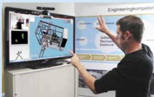
Das öffnet die Tür in Richtung Augmented Reality. Der Bediener kann über die 3D-Visualisierung mit der Anlage interagieren. Sensoren erfassen Gesten und Sprache eines Bedieners und setzen sie in Bedienbefehle um. Unter Verwendung des Kinect-Sensors von Microsoft wurden bereits erste einsatzfähige Gesten- und Sprachsteuerungen erstellt.
