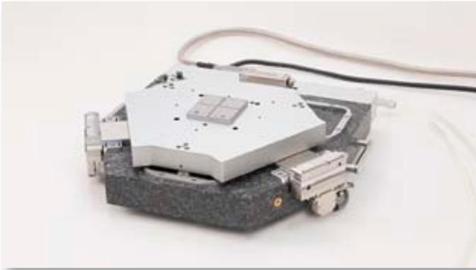
**Neues Positioniersystem, das auf dem magnetischen Schweben (Magnetic Levitation) basiert: Der passive Läufer schwebt auf einem magnetischen Feld und wird durch dieses aktiv geführt. Objekte lassen sich auf diese Weise mit bisher unerreichter Führungsgenauigkeit in der Ebene linear bzw. rotativ bewegen. (Foto: PI)**
