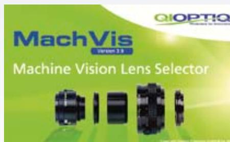
Im Bereich Vision Technology sind die Rahmenbedingungen meist durch die Anforderungen wie mechanische Abstände, Auflösung und Abbildungsmaßstab festgelegt. Ein äußerst hilfreiches Tool, um die Aufgaben in der optischen Messtechnik zu lösen, ist die MachVis Software von Qioptiq. Mit nur vier Parametern können erste Kalkulationen erstellt und komplette Systeme
