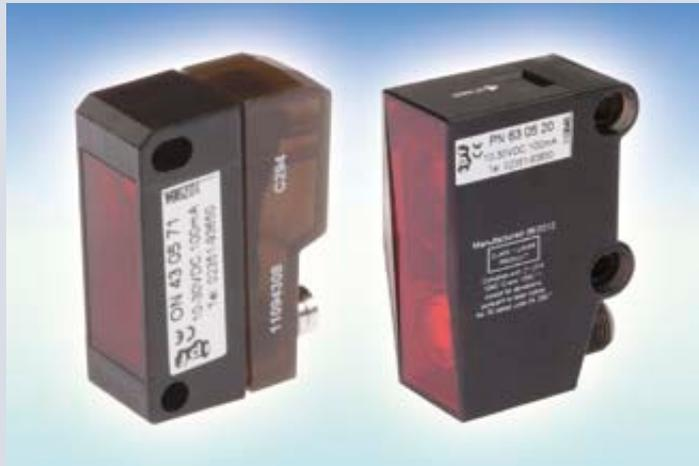
Die Einstellung des Abstands zur Referenzfläche erfolgt durch Teach-In, unterstützt durch eine in den Geräten integrierte LED-Anzeige als Einstellhilfe. Anstatt die Teach-In-Leitung mit der Versorgungsspannung zu verbinden, kann das Teachen des PN63 auch über eine Vertiefung im Gehäuse erfolgen. Die Berührung dieser Vertiefung mit einem beliebigen ferromagnetischen Werkzeug, z.B. einem Schraubendreher, genügt, um den Teach-Vorgang zu star-
