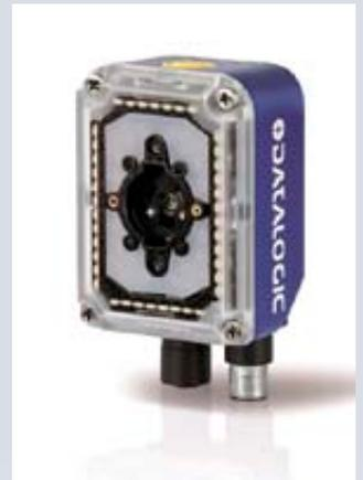
auflösenden Bildsensor mit sehr schneller Bildaufnahme und Bildverarbeitung in einem Gerät: 1,3 Megapixel, 60 Bilder pro Sekunde. Das optische System verfügt über eine Flüssigkeitslinse mit der die Brennweite gesteuert und geregelt wird. Dadurch kann das Lesegerät die Bildschärfe automatisch einstellen, ohne dass mechanische Teile bewegt werden.
