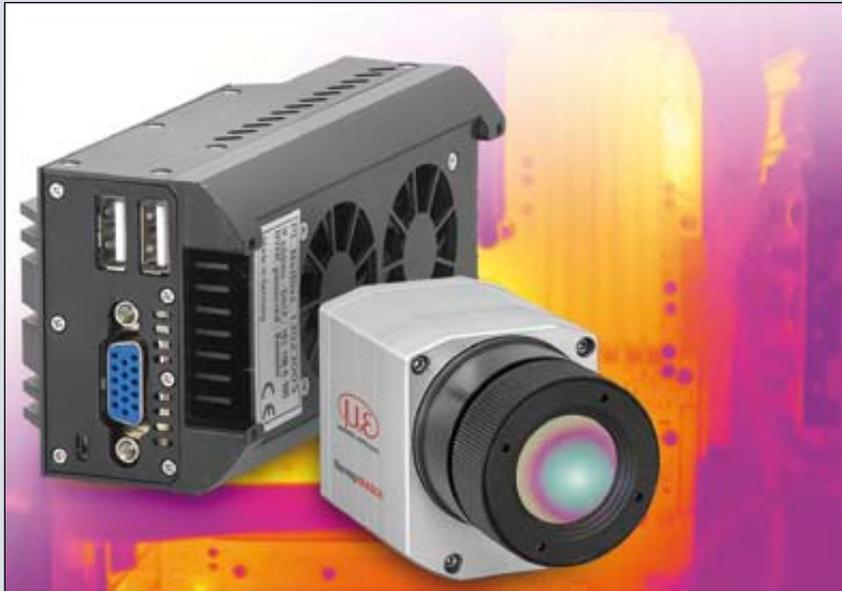
Ein Mini-PC vereinfacht die Integration der Wärmebildkameras der SeriethermoIMAGER TIM in der industriellen Produktion. Micro-Epsilon stellt einen kompakten Industrie-PC für Infrarotkameras der Serie thermoIMAGER TIM vor: Die TIM NetBox ersetzt den Standard-PC/
