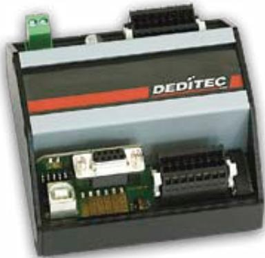
Mit dem BS-SER-O8-R8, der neuen BS-Linie erweitert Deditec die Auswahl an PC gesteuerten Steuer- und Regelungsmodulen. Das BS-SER-O8-R8 bietet dem Anwender acht galvanisch getrennte Optokoppler-Eingänge zur Signalerfassung, sowie acht Einschaltrelais zum Steu-
