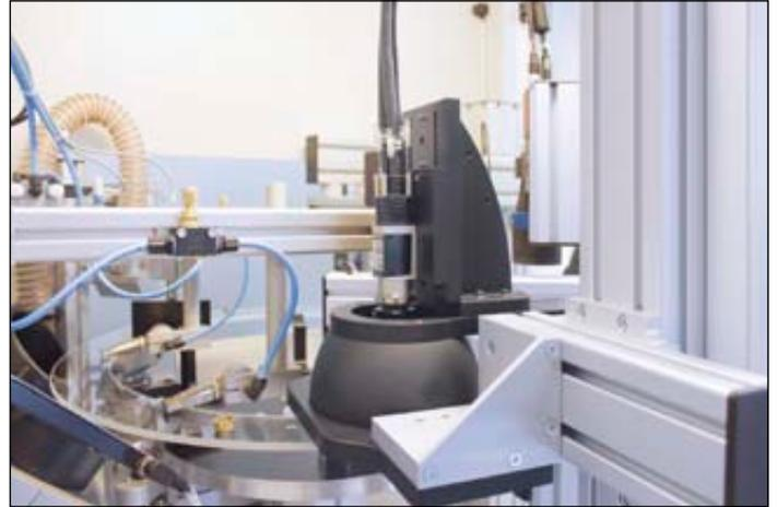
Das patentierte Verfahren trevista erkennt auch auf schwierigen Oberflächen (stark glänzend oder diffus streuend) schnell, zuverlässig und eindeutig Oberflächendefekte und Verschmutzungen bis in den  $\mu\text{m}$ -Bereich. Die erkannten Abweichungen eines Bauteils werden exakt lokalisiert und in 3D-Abbildungen dargestellt. Aus Kontur, Schattierung und Helligkeitswerten werden die Informationen über die Form von Mikrodefekten gewonnen.
