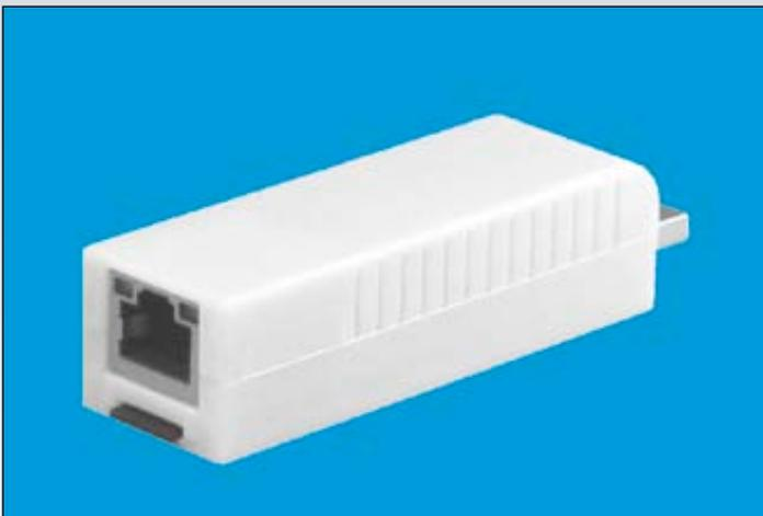
Als Massenspeicher steht eine micro SD-Karte mit bis zu 32 GByte zur Verfügung. Versorgt wird der Rechner über die USB-Buchse. Er kann direkt an einem USB-Netzteil oder einem Steckplatz am Router oder PC betrieben werden. Per 10/100 MBit Ethernet wird der Stick in ein Netzwerk eingebunden. Der Stick kann in den gängigen Sprachen unter Linux programmiert werden. Es wird ein Kernel der Version 3.10 zu Verfügung gestellt.
