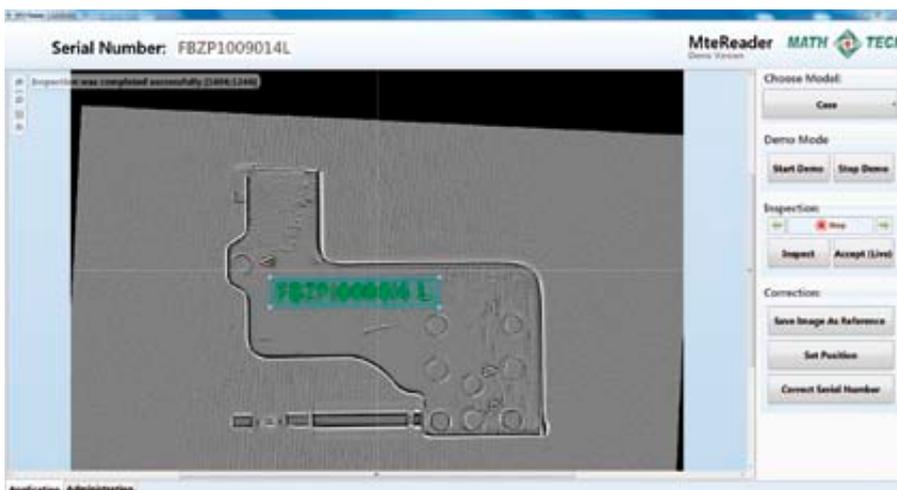
Mit dem MTE Reader von Math&Tech Engineering können Texte, Logos, Barcodes und QR-Codes auf sehr komplexen Oberflächen zuverlässig erkannt und verifiziert werden. Durch die optimale Kombination von Aufnahme- und Beleuchtungstechniken mit dem LASKA-Framework ist der MTE Reader in der Lage nahezu alle Arten von Schriften zu lesen. Dabei
