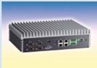
und VGA sind auch ein Displayport sowie isolierte Digitale I/Os integriert.
