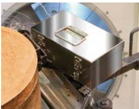
Für eine optimale Prozesskontrolle bei der Rotationsformung bietet DataPaq jetzt das RotoPaq-System, das Temperaturdaten direkt im Ofen, von der Werkzeugoberfläche und selbst innerhalb des Formwerkzeugs aufnehmen kann. Datenlogger, Hitzeschutzbehälter und Thermoelemente werden an der Rotationsform befestigt, um während
