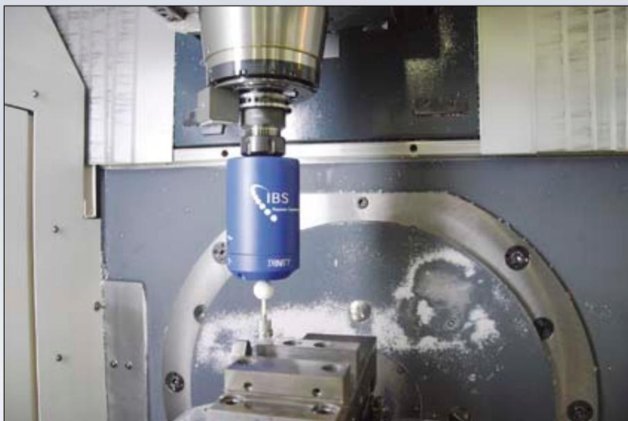
zisionskugel, während die Maschine mit dem Trinity-Messkopf eine Rotation um die Drehachse ausführt. Die Messungen im Trinity-Messkopf berührungslos über drei orthogonal angeordnete Sensoren, welche völlig verschleißfrei und unempfindlich gegenüber Verschmutzungen arbeiten. Die Messdaten werden über WLAN direkt an einen PC übertragen, auf dem die Auswertung unmittelbar ausgeführt und der Zustand der Rundachse angezeigt wird.
