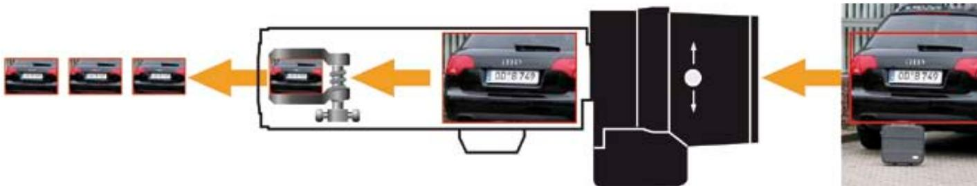
Bild 1: Bilddaten werden direkt in der Netzwerkkamera komprimiert. Der Vorteil: Man benötigt geringe Bandbreite und wenig Speicherplatz.
