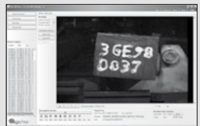
*Bild 2: Das IPA-Framework der LogoTek GmbH mit OCR, Kamera-Steuerung, Kontroll-, Kommunikations- und Archivierungsfunktion*
