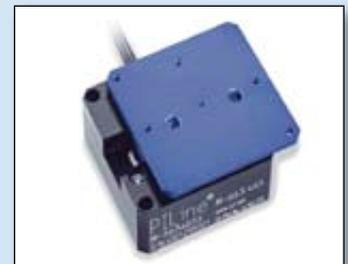
**Bild 2:** Piezobasierte Ultraschallantriebe sind leicht und eignen sich für Verfahrensgeschwindigkeiten bis etwa 600 mm/s und Beschleunigungen bis 20 g.
