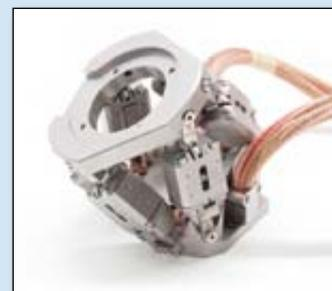
**Bild 6:** Der Mini-Hexapod bewegt Lasten bis ca. 1,5 kg über lineare Stellwege bis zu 1,5 mm und Winkel bis zu 2°. Die eingesetzten Schreittriebe arbeiten auch unter Magnetfeldern zuverlässig.
