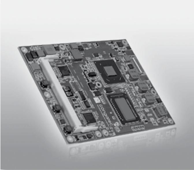
Die congatec AG stellt mit dem conga-TM77 ein neues Modul mit deutlicher Steigerung der Rechenleistung und gleichzeitig verbesserter Energieeffizienz vor. Die entscheidenden Neuerungen der dritten Generation Intel-Core-Prozessoren betreffen die Bauweise mit 3D-Tri-Gate-
