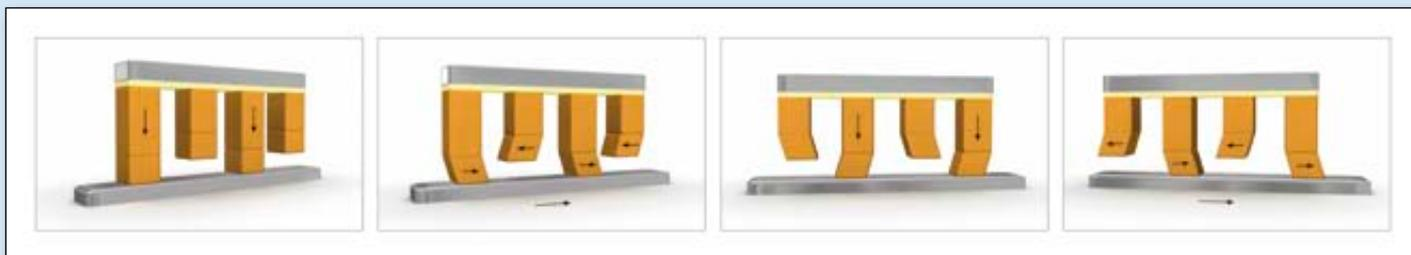
**Bild 4:** Bei so genannten Schreitrieben sind Längs- und Scherpiezos, also Piezoaktoren mit unterschiedlichen Bewegungseigenschaften, miteinander kombiniert. Entsprechend angesteuert sind damit sowohl Klemm- als auch Schubbewegungen realisierbar, die an den Gang eines Vierfüßlers erinnern.
