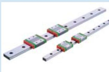
Bei den Miniatur-Profil-schienenführungen der Serie MG von Hiwin sorgt künftig ein neues Umlenkensystem für ein besseres Laufverhalten und minimale Laufgeräusche: Durch den speziellen Aufbau der aus Kunststoff gefertigten Kugelrückführung entsteht zwischen dem Rückführungskanal und den Kugeln keinerlei Metall-auf-Metall-Kontakt. Dank der Schienen, Laufwagen und Kugeln aus leicht zu
