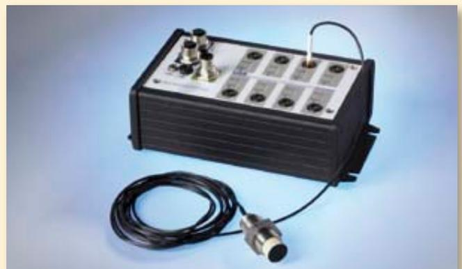
IBS Precision Engineering ist europäischer Vertreter und Vertriebspartner des amerikanischen Unternehmens Lion Precision, welches das neue Wirbelstrom-Mehrkanal-Messsystem ECL 150 zur präzisen berührungsfreien Positions- und Abstandsmessung von leitenden Objekten entwickelt hat. Das komplette Messsystem besteht aus der Treiberelektronik ECL 150 und bis zu acht Hochleistungs-Wirbelstromsensoren, die auf den jeweiligen Kanal kalibriert sind.
