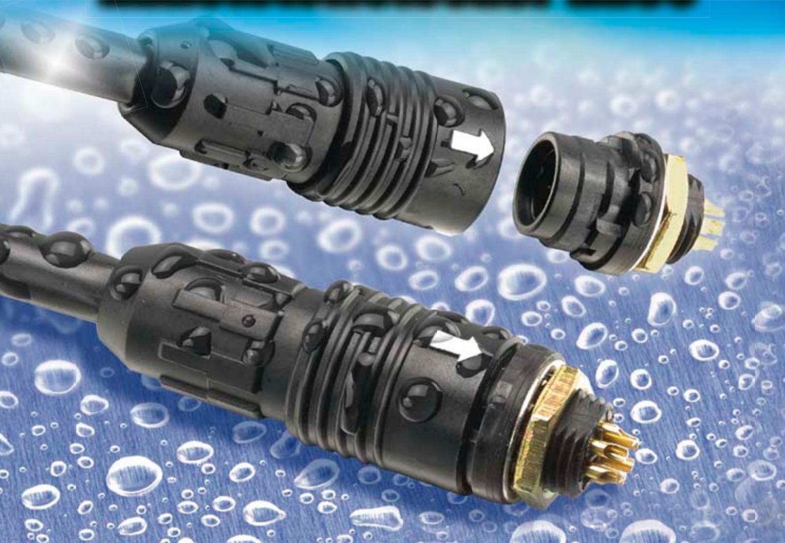
Die Steckverbinder der HR30-Serie (Hersteller Hirose) sind wasserdicht, staubdicht, kompakt und sowohl leicht als auch korrosionsbeständig durch thermoplastisches Gehäusematerial. Ab sofort ist diese leicht handzuhabende Push-pull Steckverbinder-Serie bei HOT ELECTRONIC in Schutzart IP 68 erhältlich: 3, 6, 10, 12 polig, 5 Amp (3 polig) / 2 Amp – 140 VDC/100 VAC
