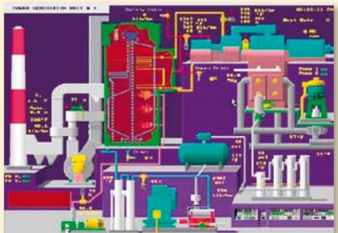
**Bild 2: Leistungsfähige Grafikprogramme verleiten zu immer unübersichtlicheren Prozessbildern. Die Darstellung nicht relevanter Details rückt in den Vordergrund (Foto: M+W / PAS)**
