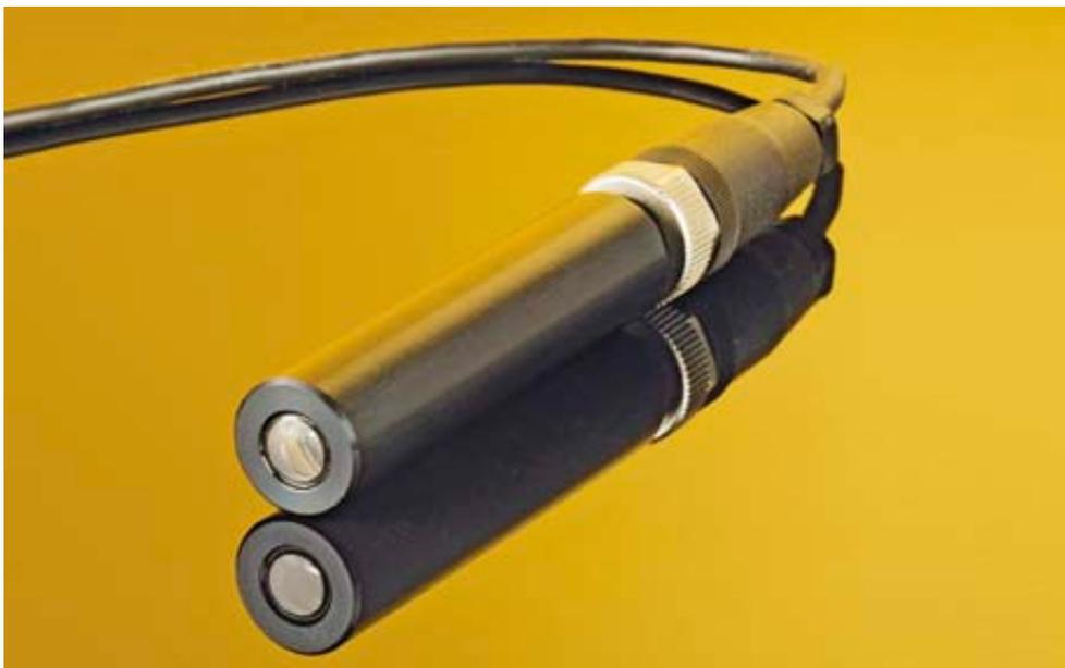
Die in Deutschland entwickelten und gefertigten Linienlaser erzeugen, abhängig vom Arbeitsabstand, Linienbreiten bis unter 5 µm. Dadurch eignen sich diese Flexpoint-Laser besonders für die 3D-Vermessung von sehr kleinen Objekten. Verfügbar sind sie bei den Wellenlängen 405 und 445 nm sowie in
