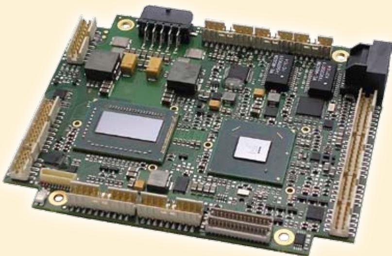
ADL Embedded Solutions kündigt mit dem ADLQM67PC-2715QE seinen ersten PCIe/104-SBC mit Quad-Core-CPU an. Das Board basiert auf einem 2,1 GHz schnellen Intel-Core-i7-2715QE-Prozessor der zweiten Generation sowie auf Intels
