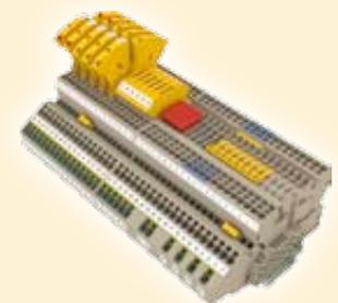
Die neuen Dreileiter-Funktionsklemmen der Serie FDLI 2,5-4 von Conta-Clip bieten bei einer Baubreite von 5,1 mm umfangreiche Funktionen und eignen sich für unterschiedlichste Anwendungen. Das Anschlusssystem ermöglicht die Kontaktierung massiver und flexibler Adern mit Aderendhülsen ohne Betätigungswerkzeug. Die Querverbindungen FQI sind steckbar und isoliert ausgeführt. Verfügbar sind 2- bis 10-polige
