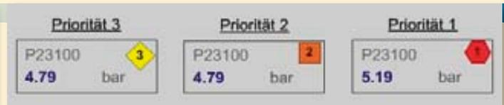
**Bild 3: Bewährte Alarmmeldungen verwenden eine redundante Codierung von Farbe, Form und Text sowie ein spezielles Objekt für den Alarmzustand (Foto: M+W / PAS)**
