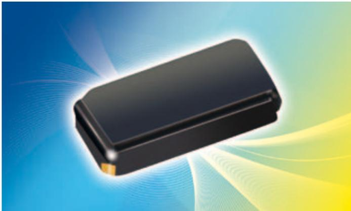
Petermann Technik bietet im 3,2 x 1,5 x 0,8 mm messenden Mini-SMD-Keramikgehäuse der Serie M3215 hochgenaue 32,768-kHz-Quarze mit 10ppm Toleranz an. Lagermengen sind für die am meisten verwendeten Lastkapazitäten 6, 7 und 12,5 pF verfügbar, auf Wunsch sind anderen Werte möglich.
