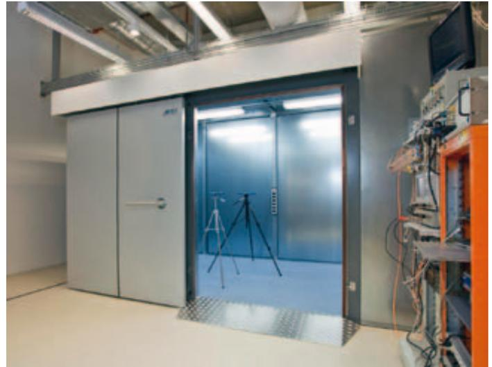
Design EMV-dichter Schiebe- und Doppeltüren. Hier ermöglicht ein ausgeklügelter Parallel-Schwenkmechanismus die Berücksichtigung von möglichen Türbauten, wie z.B. Absorber, beim Öffnungsweg. Unabhängig davon sorgt dieser Doppel-Scharniermechanismus für einen gleichmäßigen Parallel-Schließvorgang. Seit 2013 sind auch die neuen Polystyrol-Absorber für EMV-Hallen und Räume verfügbar. Diese inno-
