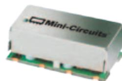
Das Bandpassfilter SXBP-1940+ von Mini-Circuits ist ein 50-Ohm-Baustein für die Oberflächenmontage mit einem schirmenden Gehäuse. Die äußeren Abmessungen des Bausteins betragen 0,44x0,74x0,27 inch. Dennoch können bis zu 8 W durchgeleitet werden. Dieser koaxiale Bandpass wurde mit verlustarmen Kondensatoren und Luftpulen realisiert. Die Durchlasskurve verläuft nur leicht asymmetrisch, wobei die Weitabselektion zu tiefen Frequenzen hin wie üblich größer ist als zu hohen hin.
