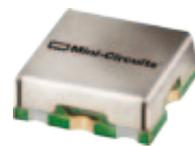
Der SMT-Hochpass-Baustein THP-1225+ von Mini-Circuits ist ein koaxial aufgebauter keramischer Resonator im schirmenden Gehäuse der Größe 0,25x0,25x0,1 inch. Der Nennfrequenzbereich beträgt 1,225 bis 4 GHz, die Impedanz 50 Ohm.
