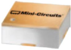
Die neuen Mikrowellen-Präzisionsdämpfungsglieder der RCAT-Serie von Mini-Circuits haben 50 Ohm Impedanz und dämpfen z.B. mit 9 dB wie der Attenuator RCAT-09+ft im Bereich DC bis 20 GHz. Dabei vertragen sie bis zu 2 W Eingangsleistung. Es findet eine Pi-Struktur Anwendung.
