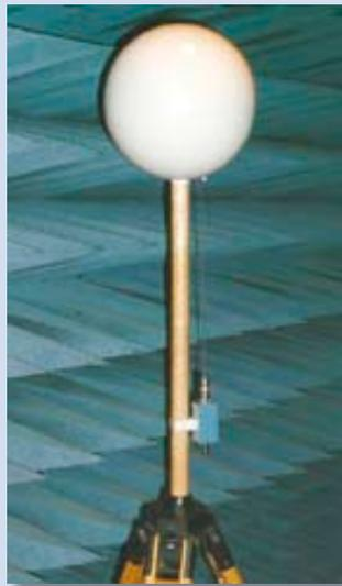
Die „Emission-Suite“ Software übernimmt die nicht ganz triviale Umrechnung der vom Meßempfänger gemessenen Spannungsp~gel in Stromdichten und ermittelt danach auch das Verhältnis der vorhandenen Stromdichten zum Stromdichte-Grenzwert und die Ermittlung des in der Norm definierten Faktors „F“, dessen Größe nicht über 0,75 ansteigen darf = direkte Entscheidung zu Compliance!
