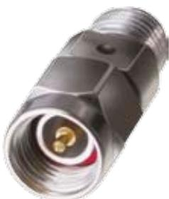
Der koaxiale Adapter SF-35M50+ von Mini-Circuits verbindet einen SMA-Stecker mit einer 3,5-mm-Buchse, bietet also die Anschlüsse SMA-F und 3,5-mm-M (50 Ohm). Das SWR wird mit typisch 1,08 (1,1)
