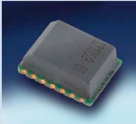
Kalender, Timer, Alarm und Schaltjahre ab. Der Datenausgang erfolgt über einen I<sup>2</sup>C-Bus. Der sehr kompakte und mit anderen Herstellern kompatible Schaltkreis hat Abmessungen von 7,4x10x3,4 mm<sup>3</sup>. Er ist RoHS-konform und wird auf Band und Rollen geliefert. Der RTC kann für Anwendungen wie Smart Metering, Verkaufautomaten, medizinische Geräte, Consumer Elektronik sowie auch Automotive Anwendungen eingesetzt werden.
