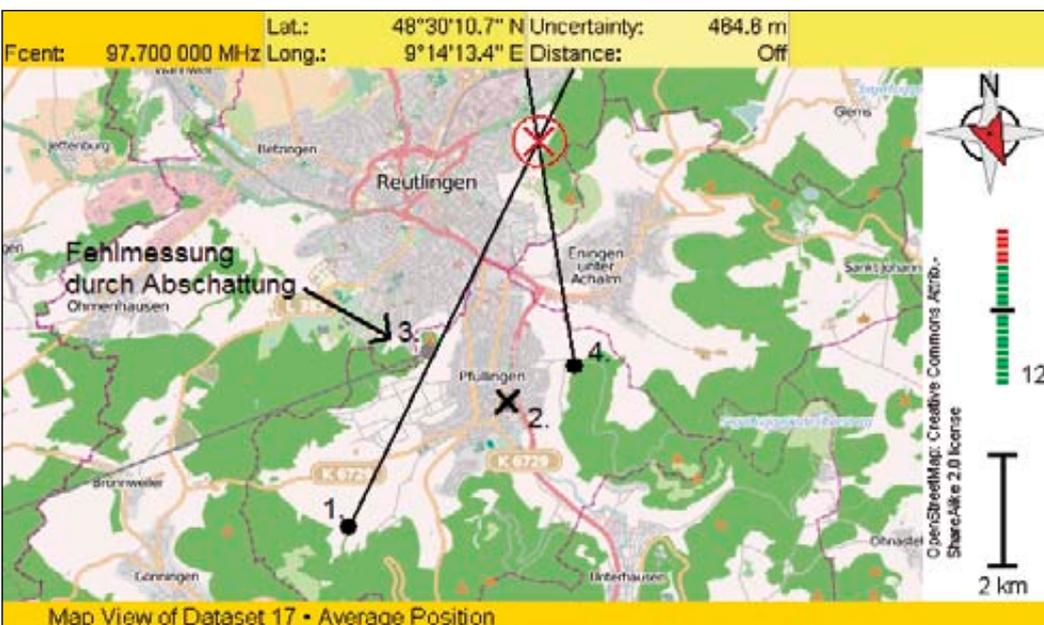
**Bild 8: Das Gerät stellt das Peilergesultat der gespeicherten Horizontal Scans auf der Karte direkt vor Ort dar.** Fehlpeilung 2 wurde verworfen; die Fehlpeilung 3 durch die Abschattung vom Berg zeigt in die falsche Richtung. Die erfolgreichen Peilungen 1 und 4 reichen aus, um den Sender zu lokalisieren.
