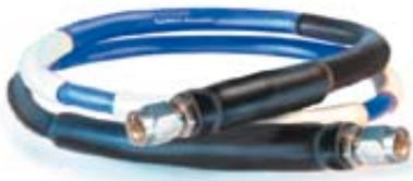
Die 50-Ohm-Koaxialkabel der Serie 50FT von Mini-Circuits sind bis 18 GHz spezifiziert und in erster Linie für großvolumige Produktionstest-Stationen vorgesehen. Daher haben sie eine extra robuste Ausführung mit Stahl-Unterstützung. Die SMA-Anschlüsse (male) sind ebenfalls aus (rostfreiem) Stahl und besitzen vergoldete Kontakte. Das Dielektrikum ist festes PTFE. Die Schirmung erfolgte dreifach für geringstmögliche Sörstrahlung bzw. maximale Unempfindlichkeit auf äußere Felder.
