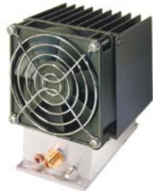
Der High-Power Amplifier ZHL-20W-13SW+ von Mini-Circuits hat zwischen 20 MHz und 1 GHz eine Verstärkung von mindestens 46 dB und typisch 50 dB. Die Gain Flatness beträgt typisch ±1,2 dB und maximal ±1,8 dB. Es werden nominell bis zu 20 W erzeugt.
