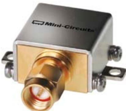
Der Bandpass ZX75BP-1940 + von Mini-Circuits ist ein koaxial aufgebauter keramischer Resonator im schirmenden Gehäuse und mit SMA-Anschlüssen (Input male, Output female). Die Anschlussimpedanz beträgt 50 Ohm.
