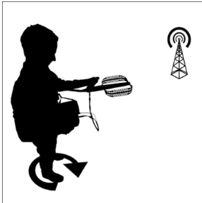
**Bild 1: Vorgehensweise beim Horizontal Scan. Mit der entsprechenden Richtantenne wird der Signalpegel über 360° aufgezeichnet.**
