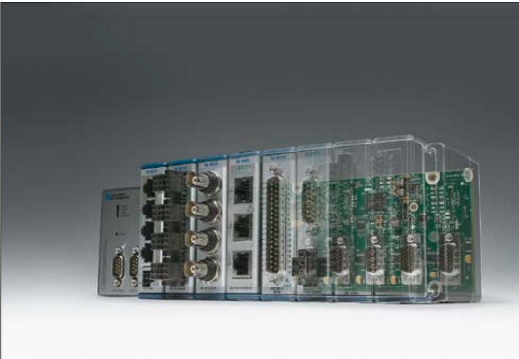
National Instruments stellt den neuen softwaredesigner Controller NI cRIO-9068 vor, in den hochmoderne Technologien integriert sind, beispielsweise die Zynq-7020-All-Programmable-SoC-Technologie von Xilinx, die einen Dual-Core-Prozessor Cortex-A9 von ARM und einen Xilinx-7-FPGA kombiniert.
