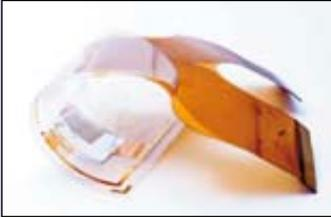
Auf dem IISW 2013 haben imec und Holst Centre ein großformatiges Photodetector-Array, das über ein flexibles Substrat verfügt, vorgestellt 6
