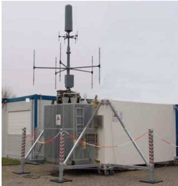
Das Gesamtsystem wird üblicherweise im abgesetzten, unbemannten Betrieb eingesetzt. Es sind verschiedene Remote-Schnittstellen integriert, z.B. GSM, UMTS, Fixed-line-WAN oder INMARSAT BGAN, um für möglichst viele Einsatzszenarien die passende Schnittstelle „on Board“ zu haben.
