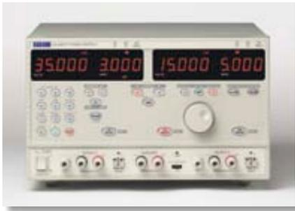
Bewährt und fortschrittlich sind die Labornetzteile der linear geregelten QL-Serie. So ist das QL355TP eine der beim Hersteller meistverkauften Stromversorgungen. Denn zu einem attraktiven Preis bietet das Modell modernste Technik und dank 16-Bit-D/A-Wandler eine Stellgenauigkeit von 1 mV bzw. bis zu 100  $\mu$ A (im 500 mA-Bereich). Die beiden Ausgänge liefern jeweils 35 V und bis zu 5 A.
