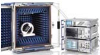
Rohde & Schwarz setzt für die Messung der Störabstrahlung von LTE-Endgeräten auf einen komplett neuen Messansatz. **29**
