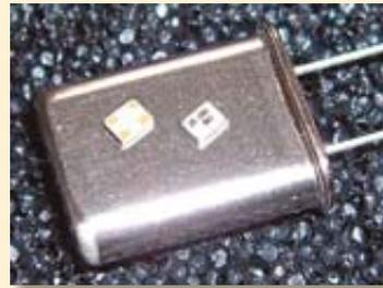
Bei den SMD-Quarzserien HC2016 und HC1612 mit den Abmessungen 2x1,6 sowie 1,6x1,2 mm<sup>2</sup> der Keramikgehäuse handelt es sich um herausragende Miniaturquarze. Die Serie HC2016 bietet einen Frequenzbereich von 26 bis 50 MHz und die Serie HC1612 von 32 bis 52 MHz. Trotz der geringen Abmessungen sind Toleranzen von bis zu 10ppm bei 25 °C möglich. Über -30 bis 85 °C
