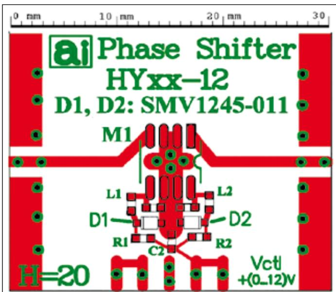
Bild 9: Layout des Phasenschiebers
