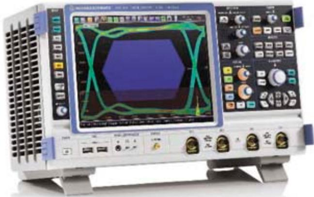
Rohde & Schwarz erweitert mit einem 4-GHz-Modell für seine High-Performance-Familie R&S RTO konsequent sein Oszilloskop-Portfolio. Der R&S RTO1044 bildet zusammen mit dem differenziellen Tastkopf R&S RT-ZD40 (4,5 GHz Bandbreite) eine leistungsstarke Lösung für die Entwicklung von
