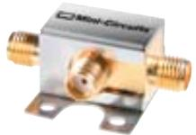
Der ZX75-23+ ist eine für 50 Ohm ausgelegte Tiefpass-/Hochpasskombination. Der Tiefpass-eingang ist für 9,8 bis 10,2 MHz vorgesehen, der Hochpassport für 650 bis 2000 MHz. Dieser Diplexer wird dazu benutzt, um ZF-, Pilotträger- oder Taktsynchronisierungssignale durchzulassen. Er kann auch in verschiedenen anderen Anlagen eingesetzt werden, einschließlich Satellitentechnik, CATV und Mehrbandfunksystemen.
