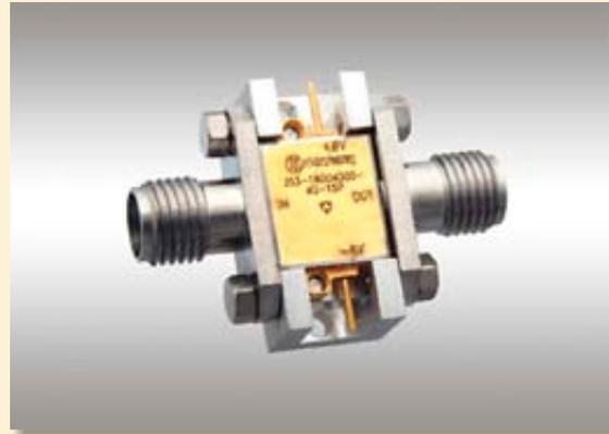
Der neue Mikrowellen-Verstärker von EMCO, das Modell JS3-18004000-40-15P, ist ein rauscharmer Verstärker für 18 - 40 GHz mit einer maximalen Rauschzahl von nur 4 dB und einer Ausgangsleistung von +15 dBm @ P1dB. Dieses Modell zeichnet sich durch eine Verstärkung von min. 32 dB aus.
