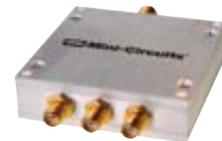
Der ZN3PD-622W+ ist ein 3-Wege-0°-Leistungssteiler, der für 50 Ohm ausgelegt ist und von 1800 bis 6200 MHz eingesetzt werden kann.
