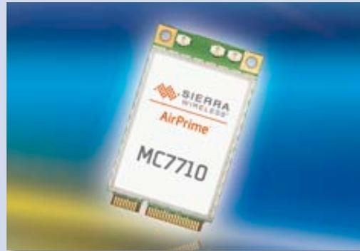
Erste Mobilfunknetze bieten die Möglichkeit, mit der neuen 4G/LTE-Technologie (Long-Term Evolution) zu arbeiten. Bei Sierra Wireless, Vertrieb: HY-Line Communication Products, ist bereits jetzt die neue 4G/LTE-MC77xx-Familie im bekannten Mini-PCI-Express-Formfaktor verfügbar. Im Vergleich zur 3G-Technologie wird die Download- und Upload-Geschwindigkeit um ein Vielfaches erhöht:
