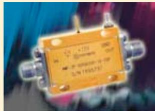
Der neue Verstärker Modell AMF-2F-00100200-16-15P ist ein neues Modell aus der extrem rauscharmen und ultra-kleinen LNA-Verstärkerserie von MITEQ. Dieses Modell überzeugt mit einer Verstärkung von über 30 dB in einem extrem kleinen Gehäuse von nur 1,22“ Länge und 0,88“ Breite (ohne austauschbare SMA-Konnektoren). Das Modell AMF-2F-00100200-16-15P arbeitet mit einer Rauschzahl von max. 1,6 dB im komplet-
