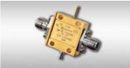
Mit der neuen und sehr kompakten Komponente AMF-6F-17702200-50-17P hat Miteq seine Familie von koaxialen Ka-Band-Verstärkern erweitert. Der LNA hat über 35 dB Verstärkung im Frequenzbereich von 17,7 bis 22 GHz. Damit komplex modulierte Signale ihre Linearität behalten, bietet der neue Miteq-Verstärker eine Welligkeit von maximal nur 3 dB, typisch sind jedoch weniger als 2 dB. Er hat eine maximale Rauschzahl von 5 dB im kompletten Frequenzbereich, der typische Wert liegt bei weniger als 3 dB.
