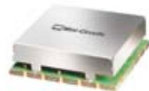
Der TDP-112-75+ ist eine Tiefpass-/Hochpasskombination, die für 75 Ohm ausgelegt ist. Der Tiefpass-eingang ist für DC bis 65 MHz bestimmt, der Hochpassport für 88 bis 1100 MHz. Die Weiche kann u.a. in CATV-Systemen, in Set-top-Boxen, drahtlosen Kommunikationseinrichtungen etc. eingesetzt werden.
