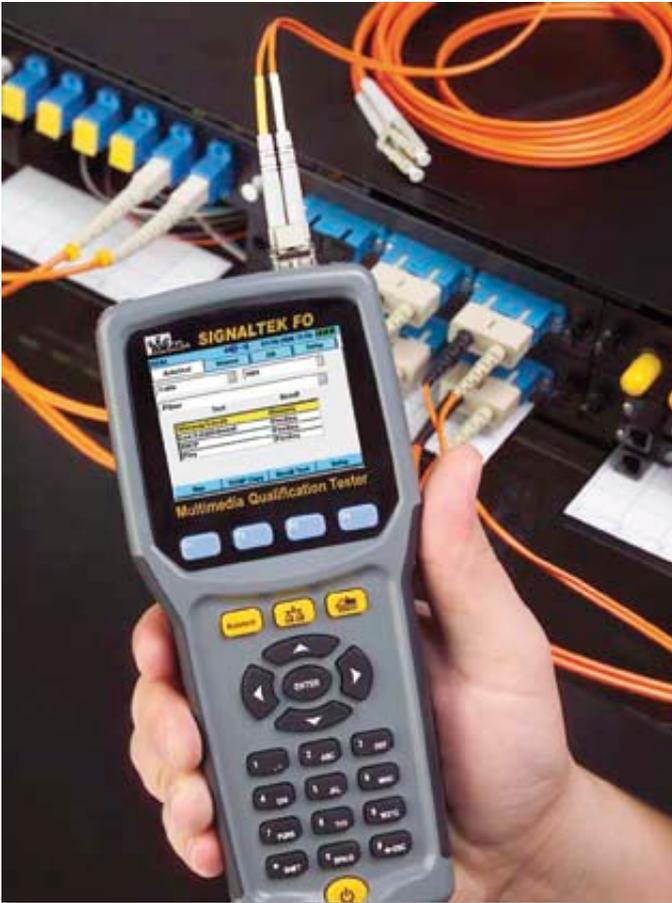
Der handliche, kompakte Signaltek FO ist das erste Prüfgerät, das Qualifizierungsmessungen an Kupfer- und Glasfasernetzen durchführen kann.
