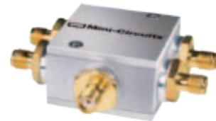
Der SMD-Splitter/Combiner ZFRSC-4-842+ von Mini-Circuits in 50-Ohm-Technik wurde für den Frequenzbereich DC bis 8,4 GHz vorgesehen. Er kann bis zu 160 mW aufteilen bzw. vier gleiche Leistungen bis zu dieser Leistung zusammenführen.
