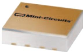
Der neue monolithische Verstärker CMA-545G1+ von Mini-Circuits basiert auf E-PHEMT-Technik in Verbindung mit einem LTCC-Substrat und ist nominell im Bereich 0,4 bis 2,2 GHz vielseitig einsetzbar. Da er geringes Rauschen mit einem hohen IP3 kombiniert, eignet er sich besonders gut für empfindliche Empfänger. Das Rauschmaß beträgt typisch 0,9 dB bei 900 MHz. Der OIP3 wird bei dieser Frequenz mit 36 dBm angegeben.
