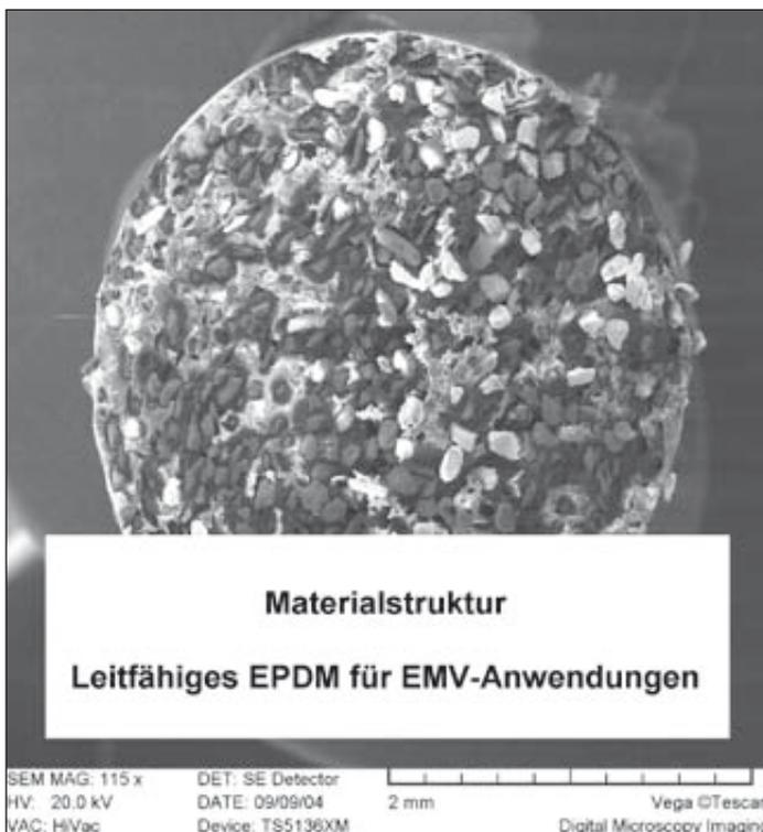
**Bild 4: Rundschnur aus leitfähigem EPDM, Materialstruktur**
