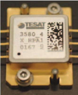
**Neues hermetisches Gehäuse für Galliumnitrid-Powerverstärker des ESA-Satelliten Proba-V entwickelt**
