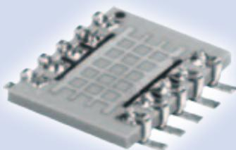
Surface-Mount-Quadratur-Leistungsteiler in LTCC-Technologie bieten gegenüber konventionellen Splitttern herausragende Vorteile. **20**
