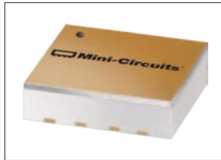
Ein- und Ausgang sind intern auf 50 Ohm angepasst. Die nominelle Betriebsspannung ist 3...4 V. Der Betriebsstrom ist zwischen 25 und 80 mA einstellbar mit Auswirkung auf die Performance. Typisch sind 57 mA. Die Verstärkung ist ebenfalls einstellbar ( $\pm 1,5$  dB).
