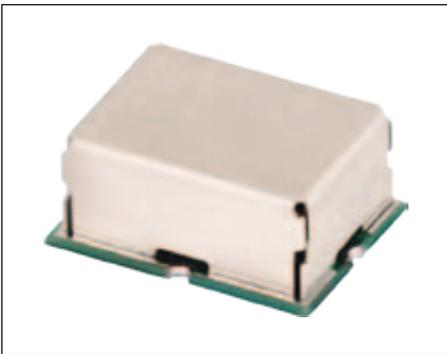
Der HJK-272H+ von Mini-Circuits ist ein passiver Mischer mit vier Feldeffekttransistoren (Rafuse-Mischer). Er hat ein Gehäuse mit den äußeren Abmessungen (einschließlich Platine) von 12,7x9,6x5,8 mm<sup>3</sup>. Der nominelle LO-Pegel ist 17 dBm. Der Kompressionspunkt liegt 3 dB über dem LO-Pegel. Die LO-Frequenz kann, wie die RF, im Bereich 0,6 bis 2,7 GHz liegen. Die IF kann maximal 10 GHz und minimal 10 MHz (wegen der internen Transformatoren) betragen.
