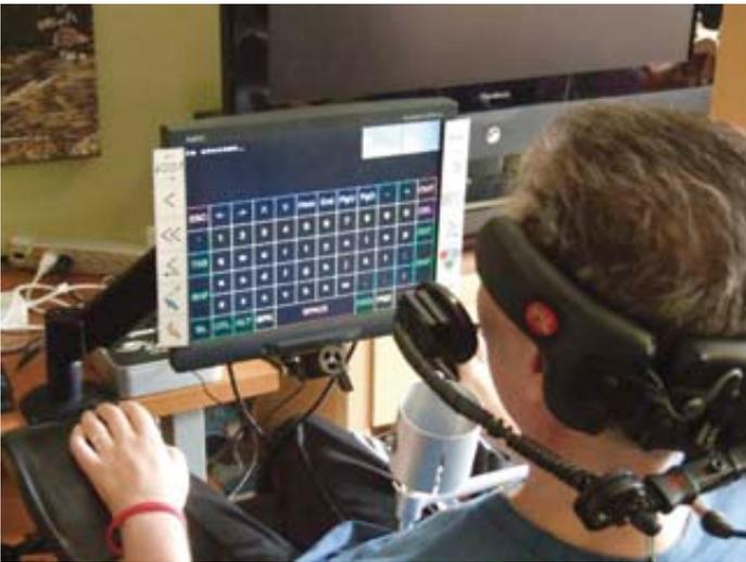
**Bei der Erstinstallation ist lediglich eine 15 Sekunden kurze Kalibrierung nötig. So erlernt das System etwa die Kurve der Hornhaut, um dem Blick präzise folgen.**
