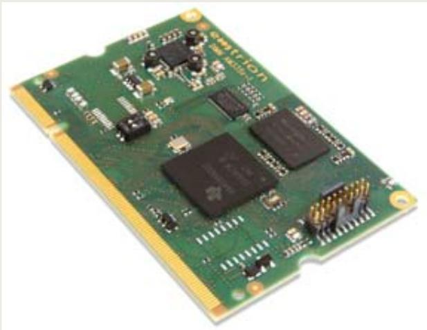
raturbereich von -40 bis +85 °C einsetzbar. Der Hersteller bietet Unterstützung für eine breite Palette von Betriebssystemen in Form von Board-Support-Packages (BSP) oder
