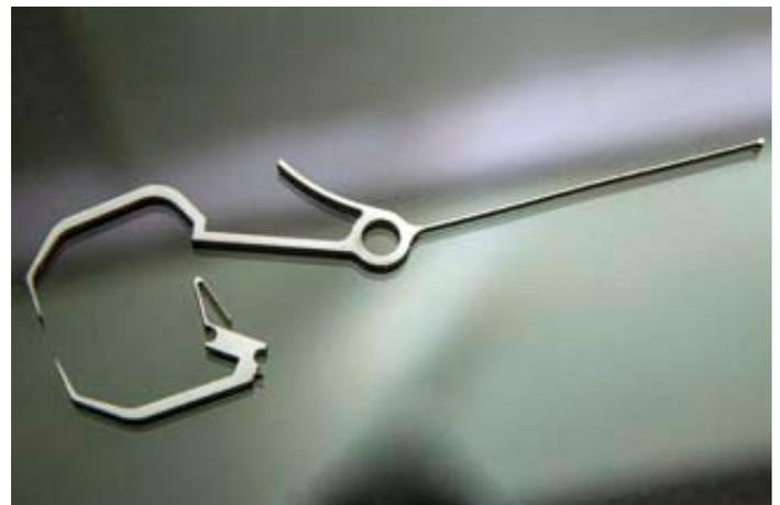
**Filigran und doch stabil: Bei Produkten wie dieser Zeckenzange kann das Mikrowasserstrahlschneiden als „kaltes“ Trennverfahren punkten: Weder Oberfläche noch Materialeigenschaften werden beeinträchtigt.**
