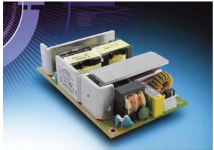
50 °C und Konvektionskühlung liefert das CSS150 bis zu 100 W Ausgangsleistung, bei Zwangsbelüftung bis zu 150 W. Der max. Kriechstrom entspricht mit unter 250 µA bei 264 V AC und 60 Hz ebenfalls den internationalen Medizinanforderungen.
