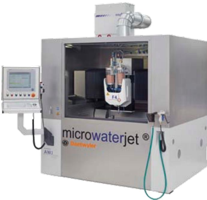
**Das Mikrowasserstrahlschneiden hat die Tür zu drastisch gesteigerter Präzision im  $\mu\text{m}$ -Bereich aufgestoßen. Speziell für Anwendungen in der Medizintechnik wie bei TRINON Titanium kommen die Microwaterjet-Anlagen mit Einhausung zum Einsatz.**
