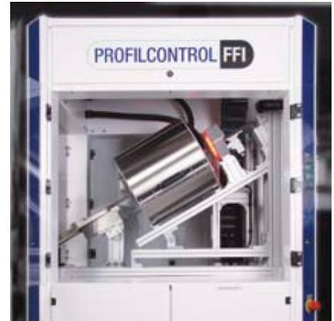
*Die Rohrabschnitte werden von rechts oben automatisch zugeführt und gelangen über eine Rutsche in den Messkopf, danach in die Gut-Schlecht-Sortierung.*
