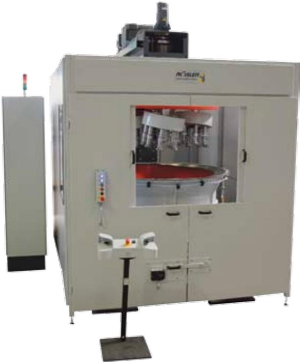
**Das Schleppfinishen ermöglicht die berührungslose Präzisionsbearbeitung empfindlicher Werkstücke und ersetzt damit teure manuelle Schleif- und Polierprozesse beziehungsweise den Einsatz von Robotern.**
