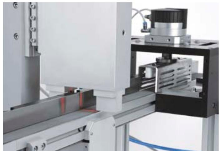
**Zentraler Bestandteil der Zuführeinheit: die Checkbox von Festo. Die integrierte Materialflusssteuerung der Zeilenkamera ermöglicht, Auswurfimpulse proportional zur Bauteillänge zu generieren und damit kurze oder lange Fehlteile sicher aus dem Prozess auszuschleusen. (Foto: IFC)**
