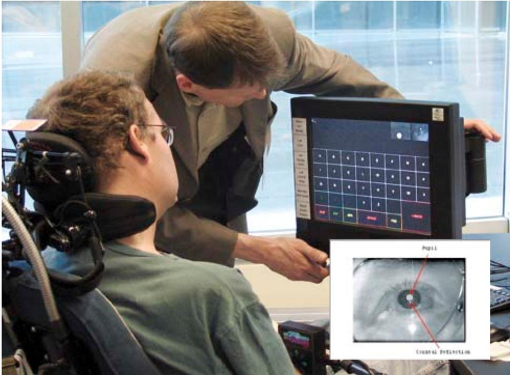
**Eyegaze Edge analysiert die Bewegungen eines einzelnen Auges, ohne dass der Patient bzw. die Patientin mit störenden Geräten am Kopf oder am Auge ausgestattet werden muss.**
