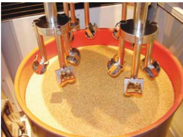
**Je nach Anlagenausführung lassen sich bis zu 32 Werkstücke bearbeiten. Dabei wird innerhalb von 30 bis 90 Minuten reproduzierbar ein optimales Glättungs-/Polierergebnis erzielt.**
