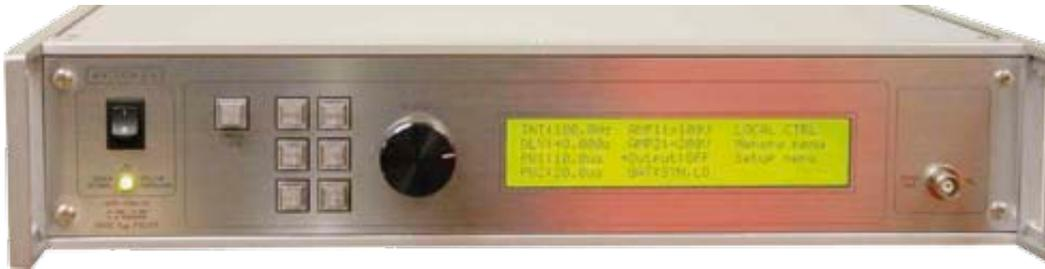
**Bild 1: Der Mainframe AVR-EB steht stellvertretend für eine ganze Serie hochspezialisierter Pulser. Die Bedienung erfolgt entweder manuell über den Einstellknopf an der Frontseite oder über die eingebauten RS-232- oder GPIB-Interfaces. Der Befehlssatz ist SCPI kompatibel.**
