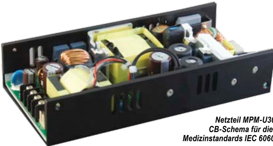
**Das medizinische Netzteil MPM-U30X wurde nach CB-Schema für die 3. Edition des Medizinstandards IEC 60601-1 entwickelt.**
