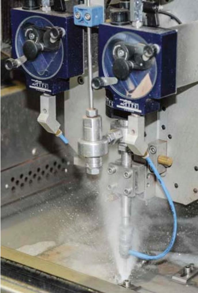
**Extreme Präzision: Wenn beim Schneiden Toleranzen unter 0,1 mm gefordert sind, kommt bei TRINON Titanium die Microwaterjet F4-Anlage zum Einsatz. Bilder: TRINON Titanium / Daetwyler**
