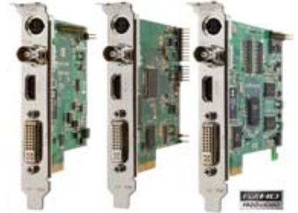
Mit der neuen Pico-HD-Serie präsentiert Euresys Videoaufnahmekarten für PCs mit PCIe-Schnittstelle für höchste Leistungsansprüche. Diese Produktserie ist kompatibel mit SDI, HDMI, DVI und analogen HD-Kameras. Sie erfasst und verarbeitet High-Definition Video-Signale in Farbe, d.h. SDI, HDMI, DVI/A oder YPbPr mit Auflösungen bis zu 1920 x 1080 Pixel, und unterstützt DirectShow Treiber unter Windows.
