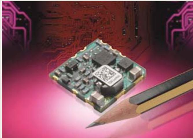
verschiedenen Ausgangsströmen: iCF (3 A/ 16,5 W), iCG (6 A/ 33 W), iBF (12 A/ 66 W) and iAF (20 A/ 110 W). Alle Modelle dieser Reihen haben einen großen Eingangsspannungsbereich von 4,5 bis 14 V<sub>DC</sub> und bieten eine einstellbare Ausgangsspannung zwischen 0,7 V und 5,5 V<sub>DC</sub> bei Wirkungsgraden bis zu 94,5%. Die Abmessungen der zum Teil
