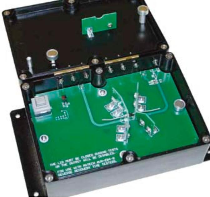
**Bild 4: Test-jig contact für die Aufnahme von Dioden mit geraden axialen Anschlüssen**
