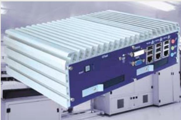
Bildverarbeitung erforderliche hohe Rechenleistung. Die Spitzenmodelle der Serie ECS-5600 sind mit dem leistungsstarken i7-Prozessor von Intel ausgestattet. Daneben stehen i5-, i3- und Celeron-Prozessoren zur Auswahl. Alle Systeme basieren auf dem Chipsatz QM67 von Intel. Die zulässige Umgebungstemperatur
