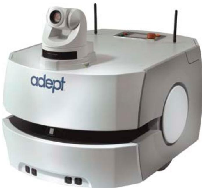
Die Mobilen Roboter von Adept sind intelligente fahrerlose Transportsysteme mit einer Nutzlast von bis zu 60 kg. Durch die integrierte Navigations- und Bewegungssteuerung sowie einer Software, die für die automatische Kartengenerierung und Wegführung sorgt, navigieren die Mobilen Adept-Roboter innerhalb eines definierten Arbeitsbereiches absolut auto-
