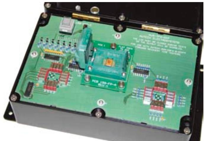
**Bild 3: AVR-TRR-DIPFP: für die Aufnahme von DIP-Packages und Flatpacks nach MIL mit bis zu 16 Anschlüssen. Per Programmierung können die Ein- und Ausgangssignale auf jedes beliebige Anschlusspaar geschaltet werden.**
