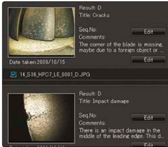
Bilder in Ordnern speichern, die für bestimmte Inspektionsabschnitte des zu untersuchenden Objektes angelegt wurden. Die Navigation von einem zum anderen Inspektionsbereich erfolgt mittels eines einzigen Tastendrucks. Diese einfache Bedienung mit nur einem Klick liefert einen schnellen und effektiven Weg, um Bilder zu verwalten und den Arbeitsablauf zu verbessern. Ein Eingabefeld ermöglicht das bequeme Hinzufügen von Kommentaren und Diagnosen für jedes Bild.
