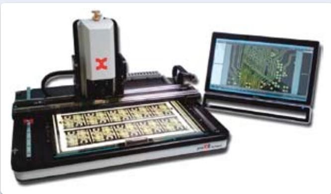
Die Impex Leiterplatten GmbH hat eine Messmaschinenlösung mit dem Namen proX2 entwickelt, wobei der Fokus auf sehr einfache Bedienung gelegt wurde. Trotz dieser simplen Bedienung können hochkomplexe Vermessungen und Konstruktionen in unterschiedlichen Koordinatensystemen durchgeführt werden.
