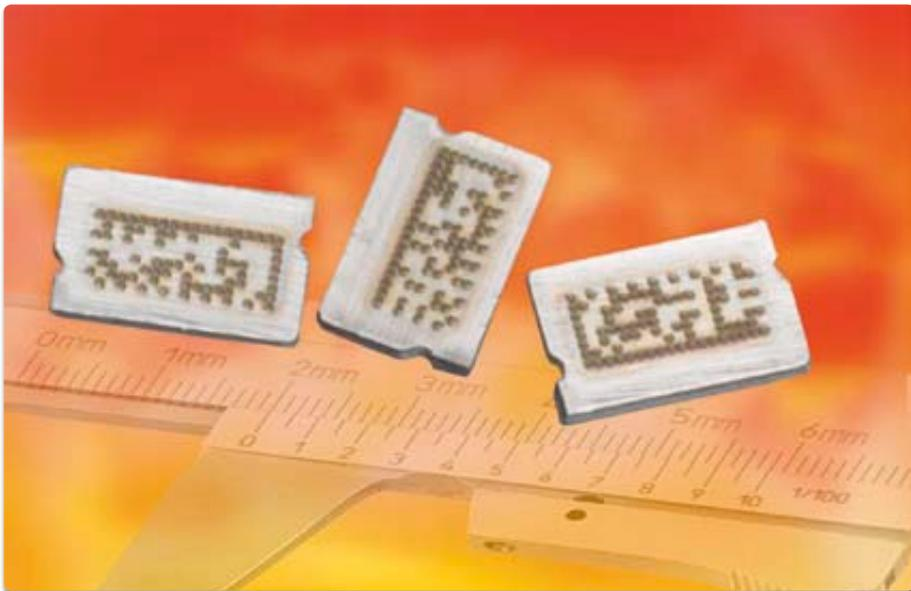
Molex Incorporated stellte sein track-it Traceability Pad vor – ein Miniatur-Identifizierungssystem für Leiterplatten, das eine eindeutige Verfolgung von in der Produktion befindlichen Produkten während des laufenden Fertigungsprozesses in der
