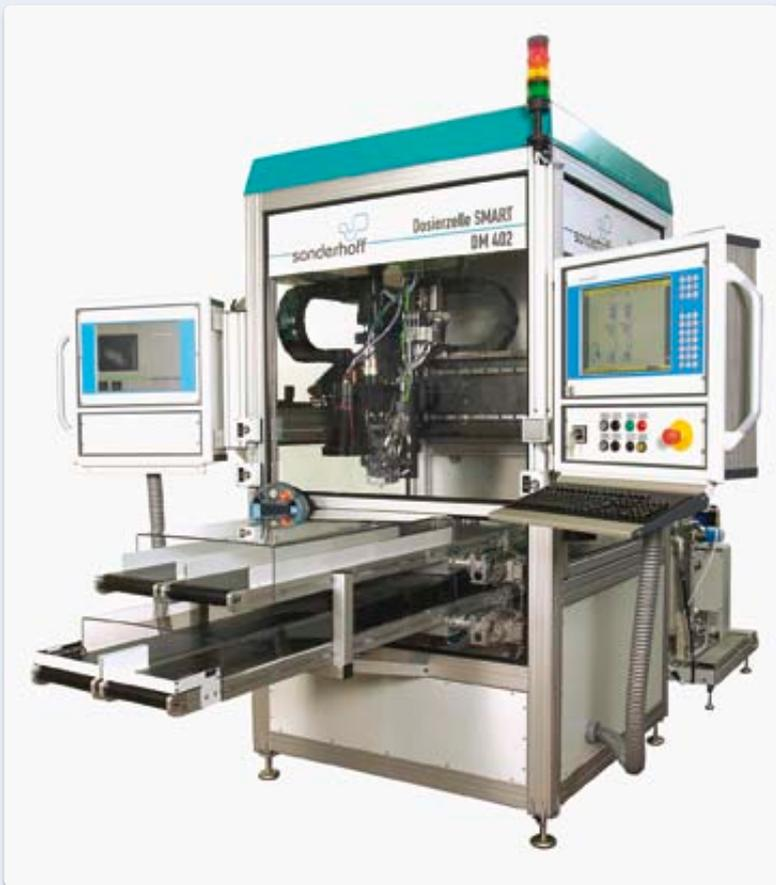
**Die Dosierzelle Smart DM 402, ausgestattet mit einem leistungsfähigen Optiksystem, erkennt automatisch die unterschiedliche Lage und Größe der Bauteile auf dem Transferband auch bei chaotischer Zuführung.**
