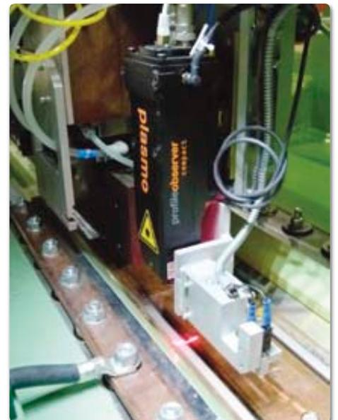
**Bild 2: plasmO profileobserver compact anwendbar bei MIG, MAG Bandschweißanlage**
