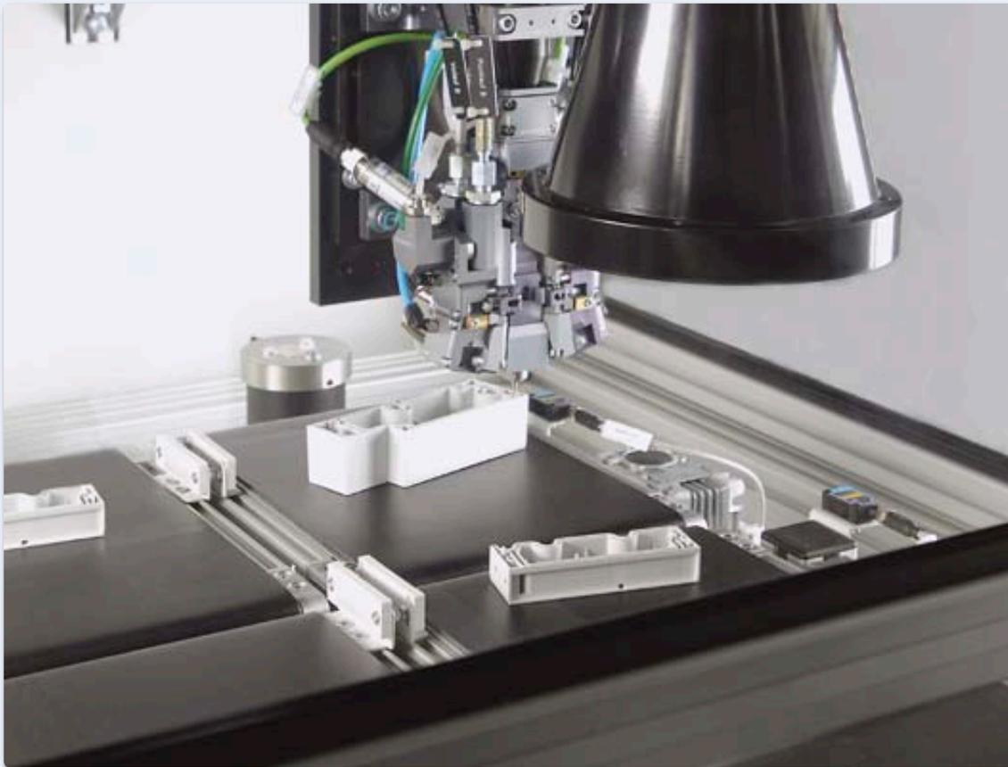
**Über eine fest installierte, leistungsstarke Optik in der Dosierzelle Smart prüft das intelligente Bilderkennungssystem die beliebige Lage der Bauteile auf dem Transferband und erkennt automatisch die unterschiedlichen Bauteilgrößen und Geometrien.**
