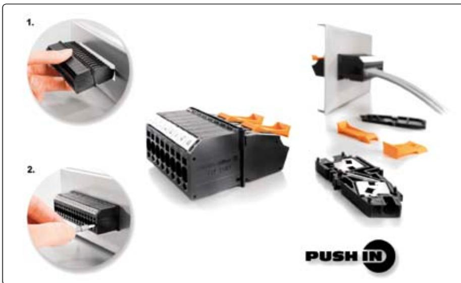
**Bild 1:** Die neue Durchführungsklemmen in Push-in-Anschluss-Technik entsprechen aktuellen Anwenderbedürfnissen hinsichtlich Komfort und Kostenersparnis bei der Montage und beim Leiteranschluss. Detail 1: Hochpolige Klemmenblöcke lassen sich schnell, einfach und platzsparend in die Gehäusewand einrasten. Detail 2: Der Push-in-Anschluss nimmt Leitungen mit Aderendhülsen bis 4,0 mm<sup>2</sup> problemlos auf.
