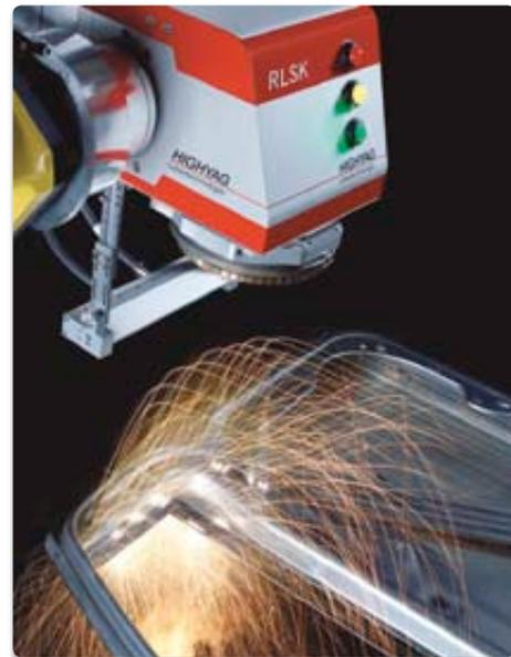
**Bild 4: plasmO processobserver advanced im Einsatz mit Highyag RLSK**
