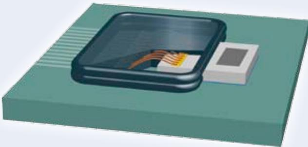
**Bild 4: Beim partiellen Chipverguss ist es besonders wichtig, dass der Klebstoff ohne zu verfließen an der vorgesehenen Position aushärtet.**
