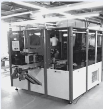
Nach dem Prüfen werden die kontrollierten Teile nach gut und schlecht sortiert. Durch den Einsatz des Prüfautomaten von Sontec hat der Kunde eine hohe Flexibilität bei der Verarbeitung von neuen Teilen, rasche Verfügbarkeit der Anlage wie auch einen hohen Qualitätsstandart. Die typischen Sontec-Zellen für Somflex
