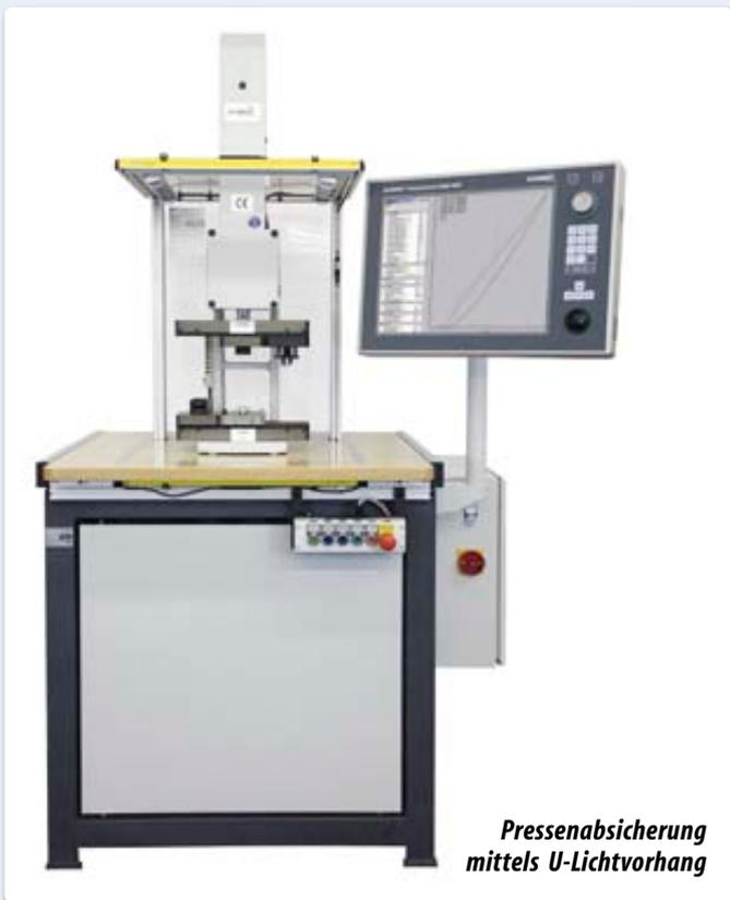
**Pressensicherung mittels U-Lichtvorhang**
