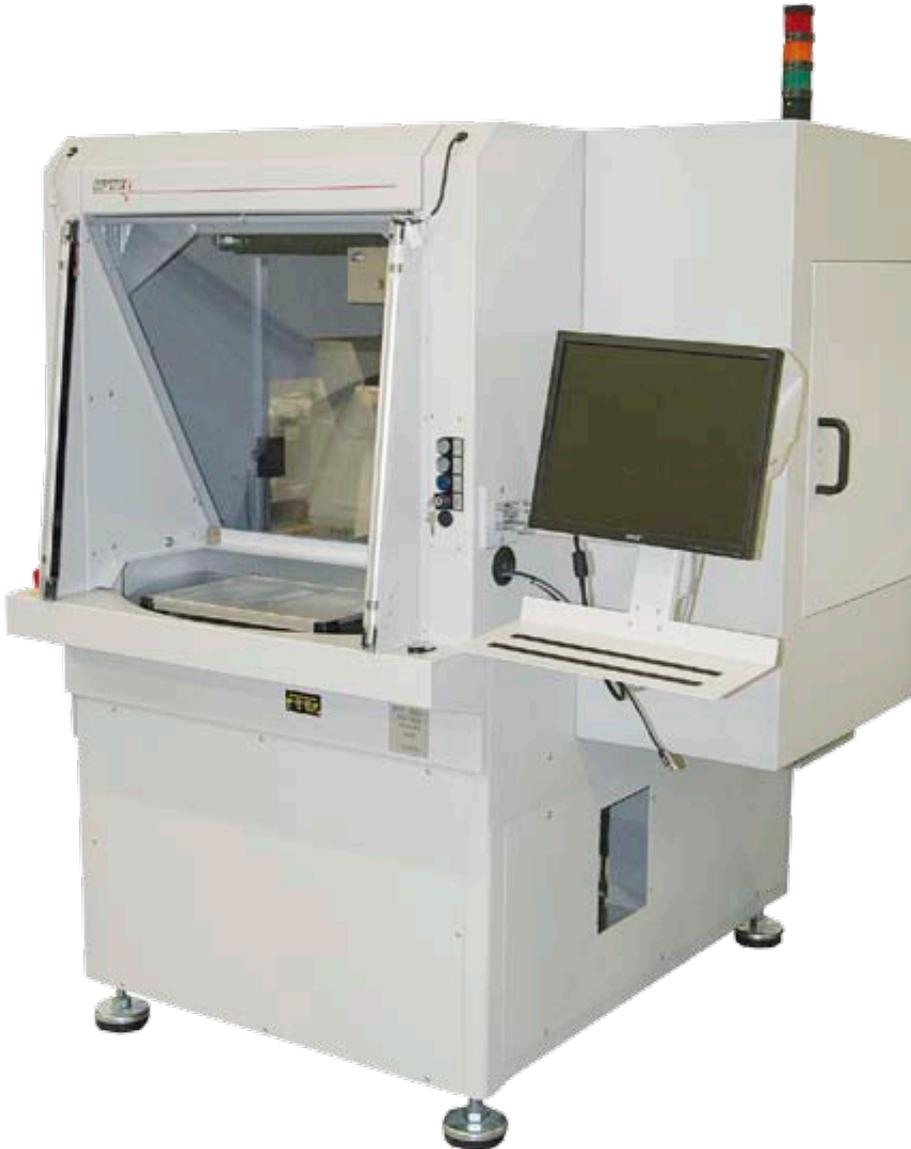
Die Zelle verfügt über ein Linearachsensystem (X/Y) sowie eine Spindelachse (Z). Zur Werkstückaufnahme dient ein Rundschaltteller mit zwei Basisaufnahmen. Dabei ist der manuelle Einlegebereich für die Bedienperson mit einem Lichtgitter abgesichert. Als Maschinensteuerung ist eine PC-Steuerung für die Ablaufprogrammierung enthalten.
