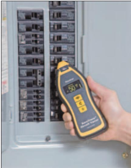
**Ideal Industries stellt mit dem SureTrace einen leistungsstarken, vielseitigen und leicht anwendbaren Leitungssucher vor, der Sicherungen und Schutzschalter auffindet oder Brüche in Leitungen und Erdschlüsse identifiziert.**
