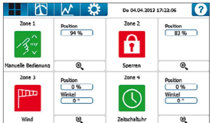
**Bild 3: TouchBucó verfügt über zahlreiche Funktionen, wie Sonnenstandsverfolgung, Windrichtungserkennung und Zeitschaltuhr (Fotos: Somfy GmbH).**
