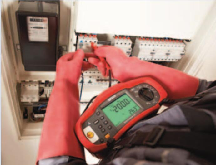
Beha-Amprobe stellte die Multifunktions tester Telaris ProInstall-100-D- und ProInstall-200-D vor. Das sind robuste, leichte Werkzeuge zur Überprüfung von Elektroinstallationen in Wohngebäuden sowie in gewerblichen und industriellen Anwendungen. Mit diesen Multifunktions testern werden Erst- und Wiederholungsprüfungen an orts-
