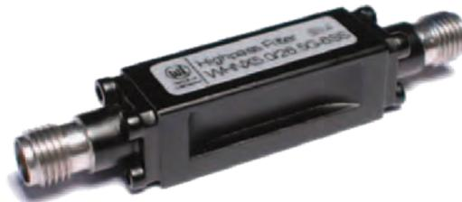
Dieses Filter unterdrückt die von Stromquellen geringer Leistung erzeugten Störsignale, lässt aber die entstandenen Oberwellen bis 26,5 GHz für Messzwecke passieren. Die Serie bietet Filter mit Grenzfrequenzen zwischen 3,5 und 10,0 GHz.
