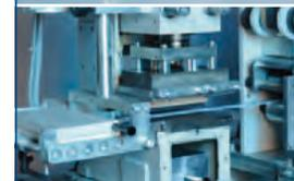
Stanzteilherstellung mittels Hochleistungsstanze
