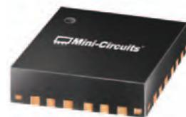
Mini-Circuits' neuer Doppelbalance-Mischer MDB-73H+ arbeitet breitbandig als MMIC: Sowohl der RF- als auch der LO-Frequenz-Bereich betragen 2.200 bis 7.000 MHz, und der IF-Bereich erstreckt sich von DC bis 1.600 MHz.
