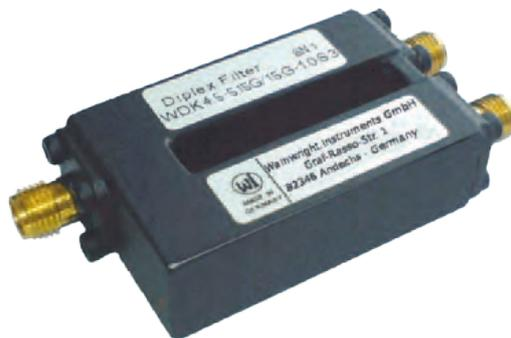
Dieses Mikrowellen Diplex-Filter ist ein Beispiel für mehrere möglichen Kombinationen der von Wainwright produzierten Mikrowellen-Tiefpässe mit Mikrowellen-Hochpässen. Die folgenden Grenzfrequenzen können kombiniert werden.
