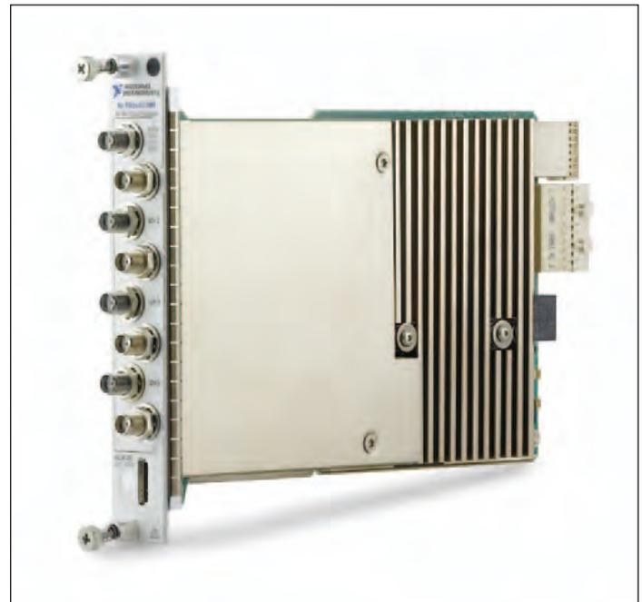
**Bild 2: Rekonfigurierbares Oszilloskop PXIe-5171R mit acht Kanälen, 250 MHz Bandbreite und einer Auflösung von 14 bit**
