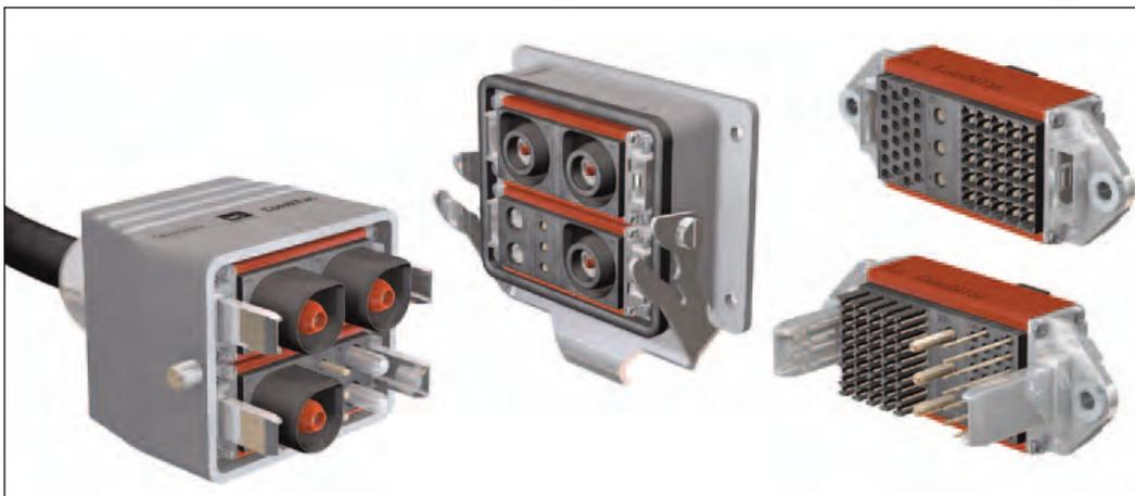
**CombiTac im DIN-Gehäuse für Motortest-Anwendungen bis zu 300 A/1000 V (linke Seite) und CombiTac in der Einbau-Version für Test- und Automatisierungsanwendungen, hier bestückt mit vielpoligen Signal- und Leistungskontakten hoher Dichte (rechte Seite).**
