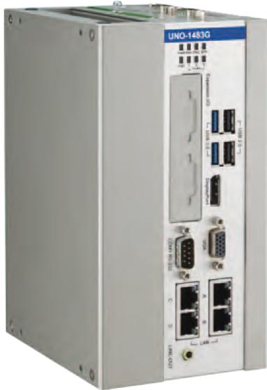
Mit den kompakten VIS-UNO-1483G und VIS-UNO-2483G präsentiert Visam zwei neue, top ausgestattete Box-Computer für den Einsatz im industriellen Umfeld. Sie sind mit aktuellen Intel Core-i-Prozessoren der Haswell-Generation ausgestattet und verfügen über hervorragende Thermale und Anti-Vibrations-Eigenschaften.
