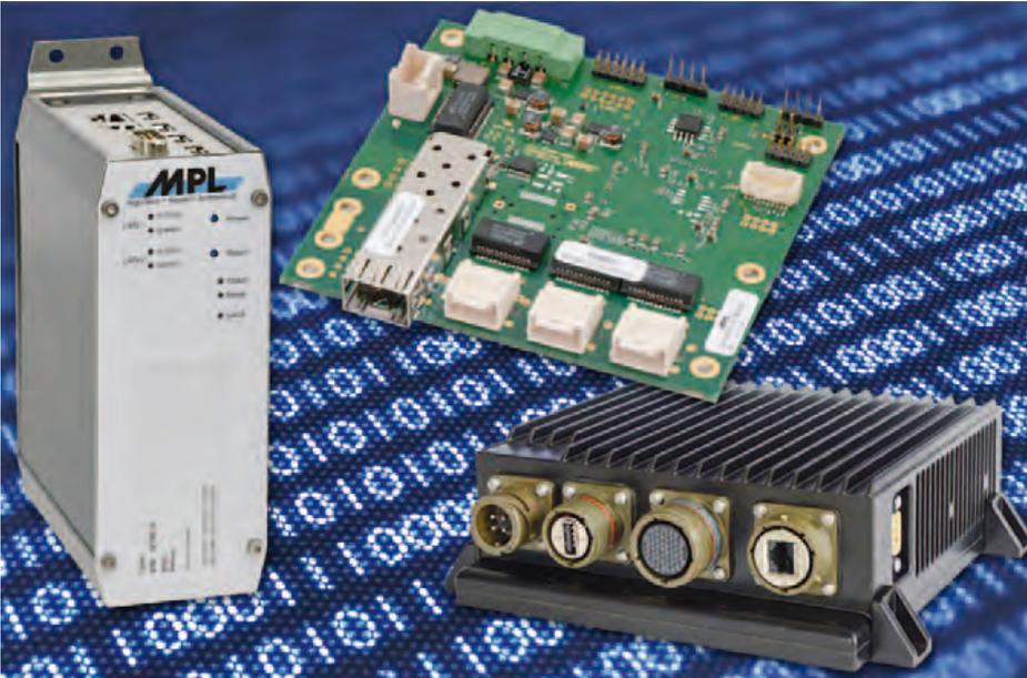
Die neue MAGBES-20 Familie ist in verschiedenen Versionen erhältlich, abgestimmt auf die Anforderungen der jeweiligen Anwendung. Die fünf Ports können mit RJ45-Steckern oder lockable Headers ausgestattet werden, wovon zwei auch als Glasfaser möglich sind.
