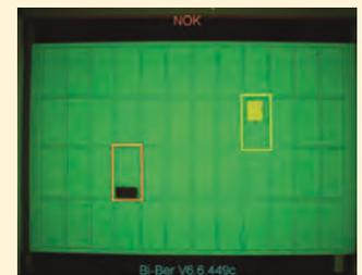
zuvor erkannt werden. Durch den höheren Kontrast zwischen Form und Füllung ist eine Erkennung der Restverschmutzungen bis zu einer Größe von 1 mm<sup>2</sup> möglich.
