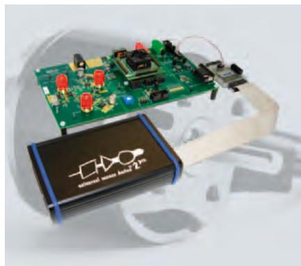
ein Stromsensor, ein „successive approximation“ 10-Bit-ADC, eine Capture-Compare-Einheit (CAPCOM6) für Pulsweitenmodulationssteuerung (PWM) und mehrere 16-Bit-Timer untergebracht. Als Kommunikationsschnittstellen dienen eine Vielzahl von General-Purpose-I/Os (GPIOs) sowie ein zum Standard 2.2 und SAE J2602 kompatibles LIN-Interface.
