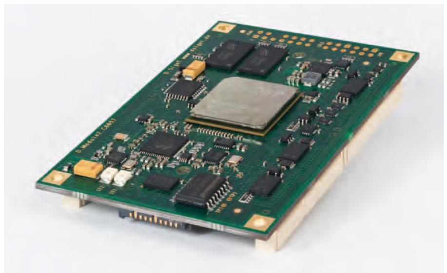
Speicher, 8 MByte NOR Flash und 64 MByte NAND Flash, Real Time Clock, Spannungs- und Temperatur-Überwachung, sowie ein speicherresidentes Tool für Programm- und Parameter-Updates im Feld über USB. Das D.Module2.C6657 misst lediglich 85 x 58 mm und benötigt nur eine 3,3 V Versorgung. Für
