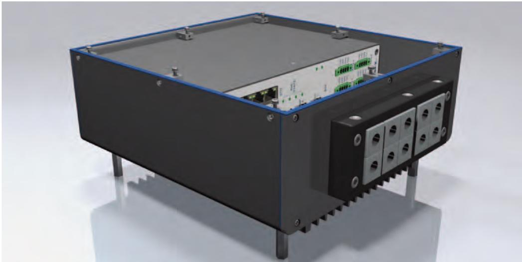
Mit der VisionBox AGE-X TIGRILLO gibt es ein neues Einstiegsmodell in die Welt der VisionBoxen mit Windows. Wie im großen TIGER gibt es Echtzeit-Controller, stromgeregelter LED Controller, digitale I/Os und Kameratrigger. Eine Kameraversorgung mit 12 V ist zusätzlich zur Kameraanbindung über GigE oder USB 3.0 erhältlich. Ein energieeffizienter x86-Prozessor und die Auslegung auf eine Kamera erlauben in den Bereich hochwertiger intelligenter Kameras vorzu-
