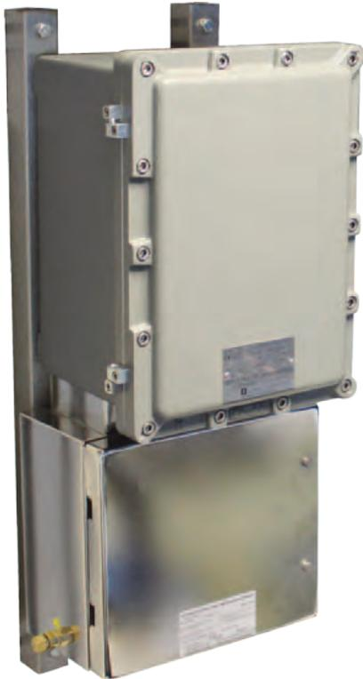
**Bild 1:** Druckfest gekapseltes Gehäuse für Zone 1 Gasgruppe IIB mit Steuer- und Anschlusskasten in Zündschutzart Ex e.
