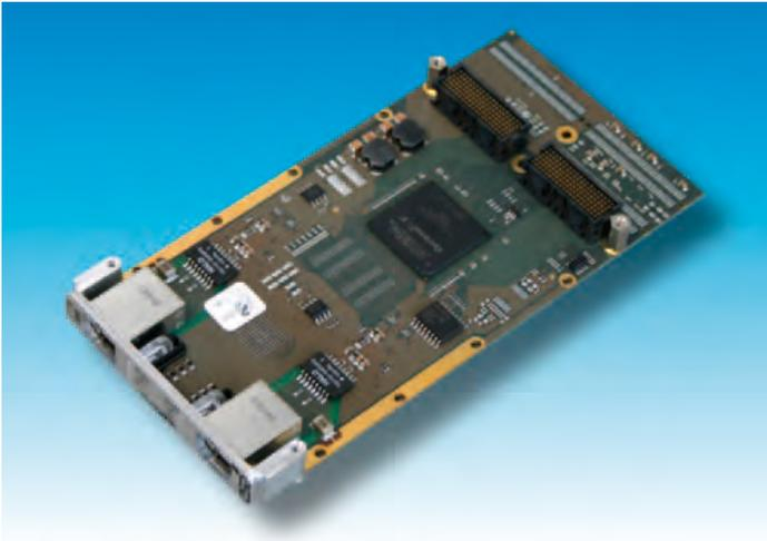
Das EtherCAT Slave-Controller-Board ist mit einem Beckhoff IP-Core ausgestattet. Der Speicherbereich des EtherCAT Slave-Controllers wird direkt im PCI Express-Adressraum abgebildet. Das EtherCAT Slave-Device kann einfach durch den esd EtherCAT Master oder andere Master konfiguriert werden. Eine als Beispiel vorgesehene EtherCAT Slave Information-Datei (ESI file im XML-Format) gehört zum Lieferumfang. Durch die esd EtherCAT Slave-API Bibliothek
