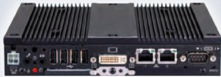
tigen I/O-Schnittstellen eignet sich der kompakte Embedded Box PC für eine Vielzahl von Applikationen. Es gibt vier USB-2.0-Schnittstellen, vier COM-Ports (zwei RS-232C-Ports, ein RS-232C/422/485-Port, ein RS422/485-Port) sowie jeweils zwei LAN-Schnittstellen über RJ45-Stecker, einen Audio-Ausgang und DVI-I-Ports für den Anschluss von bis zu zwei unabhängigen Displays. Der LAN-Controller
