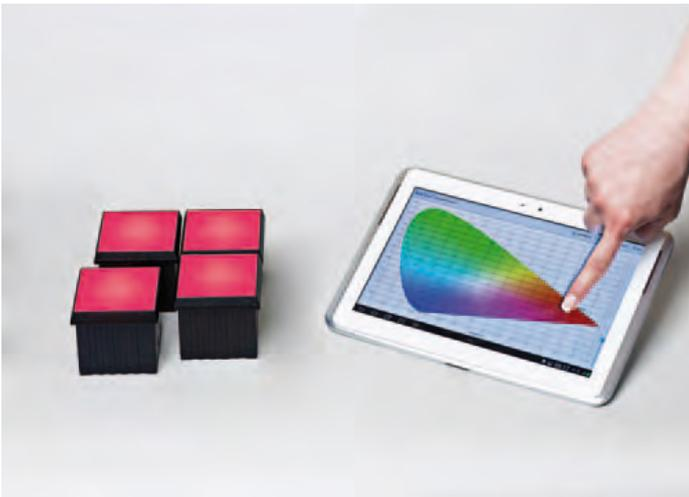
**RGBW-Spotlight Demonstrator - MAZeT regelt drahtlos verschiedene Lichtstimmungen und -farben dauerhaft und über spektral unterschiedliche LEDs hinweg über eine eigens programmierte mobile App**
