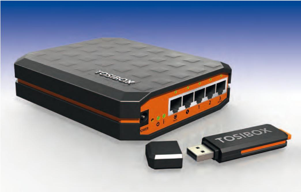
Die laut Hersteller weltweit erste auf Kryptoprozessor-Technologie basierende Hardware-VPN-Lösung geht in die zweite Runde: In Barcelona stellte Tosibox seine aktualisierten Produkte vor. „Das neue Produkt besteht aus dem Netzwerkgerät Tosibox Lock 200 und den für den sofortigen Fernzugriff eingesetzten Tosibox Key. Die Verbindung zwischen Lock und Key sorgt für den gesicherten Fernzugriff auf die an
