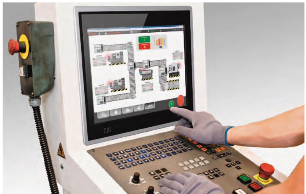
*Die Empfindlichkeit des pCAP Touch rough kann der Anwender in einem weiten Bereich einstellen, so dass sowohl eine Bedienung mit bloßem Finger, als auch mit leichten oder schweren Arbeitshandschuhen möglich ist. Quelle: Picos GmbH*
