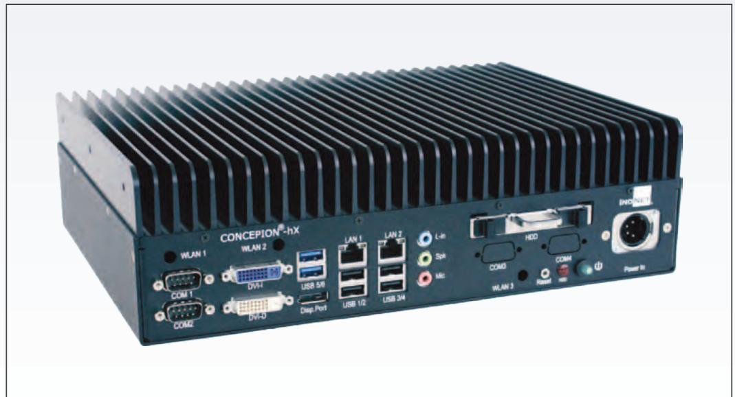
**Conception-hX: Der passiv gekühlte High-Performance Embedded-PC von InoNet ist für den Dauerbetrieb bei Umgebungstemperaturen bis 50 °C ausgelegt.**
