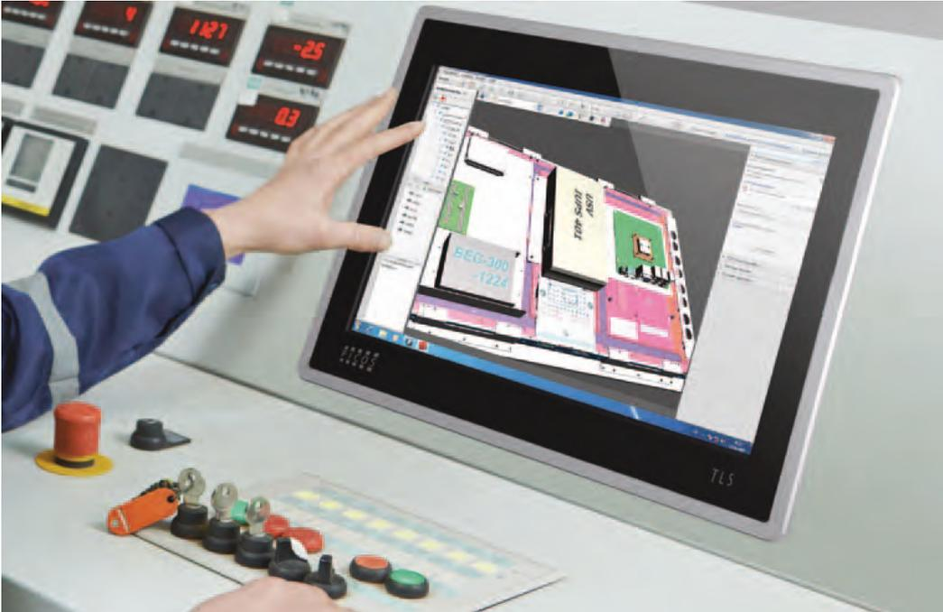
*Mit dem pCAP Touch fine können beispielsweise technische Zeichnungen im PDF-Format oder Bilder direkt an der Maschine betrachtet, über Mehrfinger-Gestensteuerung an eine andere Stelle auf dem Bildschirm gezogen oder in ihrer Größe verändert werden. Quelle: Picos GmbH*
