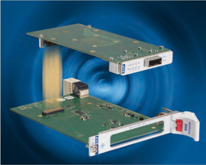
Mit der SK2-Session stellte EKF eine Peripheriekarte für PICMG-CompactPCI-Serial-Systeme vor, die als Träger für ein Mezzanine-Modul nach dem XMC-Standard dient. XMC-Module sind definiert durch die ANSI/VITA-Spezifikation 42 und gelten als Nachfolger der bekannten PMC-Module. Bei identischen Abmessungen verfügen sie jedoch über das moderne PCI Express Interface. Die SK2-Session verfügt über einen 4-Lane/5-Gbps PCI Express Redriver für optimale PCIe-Gen2-Signalintegrität.
