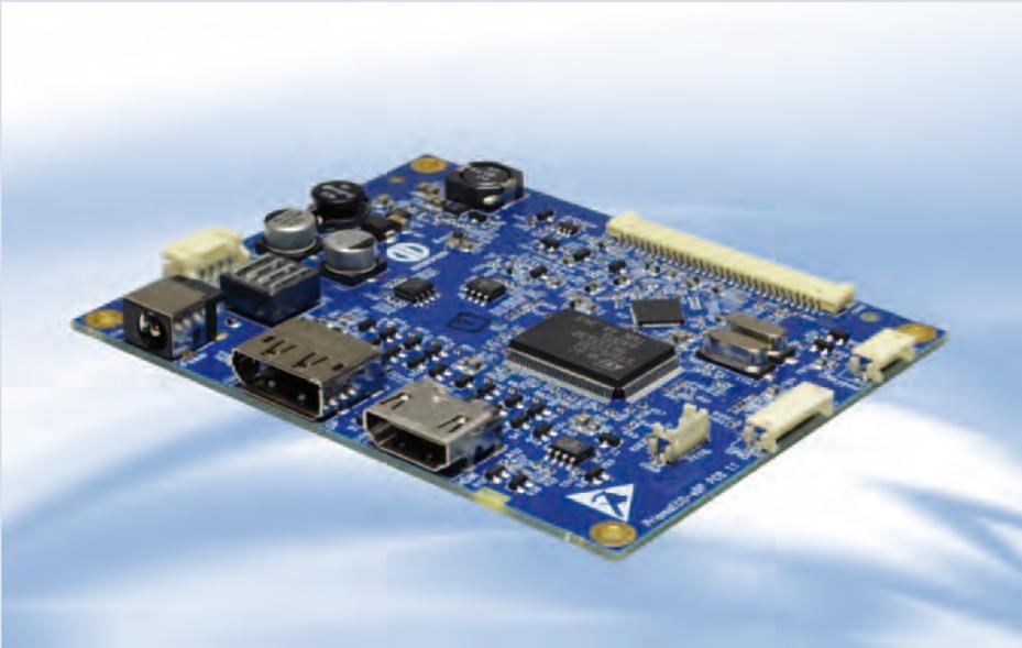
Bei TFT-Displays mit Full-HD-Auflösung setzen die Hersteller inzwischen vermehrt auf den eDP (embedded DisplayPort) als Eingangsschnittstelle, da der eDP-Standard bei optimierter Leistung höhere Datenraten ermöglicht. Außerdem zeigen TFT-Displays mit eDP-Schnittstelle ein besseres EMV-Verhalten als TFTs mit LVDS-Schnittstelle. Um dieser Entwicklung Rechnung
