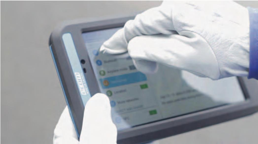
Zum ersten Mal ist der Mitarbeiter in explosionsgefährdeten Bereichen nicht mehr auf gedruckte Dokumente und Klemmbretter angewiesen, wenn Karten oder Diagramme zur Durchführung von Wartungen oder anderen Tätigkeiten notwendig sind. Denn digitale Versionen können mit dem Tab-Ex 01 jederzeit abgerufen und auf dem großen und kontrastreichen Display betrachtet werden, auch bei direkter Sonneneinstrahlung.
