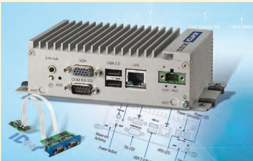
Der UNO-2272G ist ein lüfterloser Box-PC mit iDoor-Schnittstelle, der sich vor allem für die industrielle Nutzung in rauer Umgebung eignet. Das neue Produkt von Advantech hat eine Grundfläche von nur 157 x 88 mm und kommt mit höchstens 12 W Leistung aus, im Normalbetrieb mit um die 8 W. Über das frontseitig angeordnete iDoor-Interface kann der Kleinrechner nach Belieben mit WLAN-, CANOpen-, Serial-, GSM-, GPRS- und weiteren Schnittstellen bestückt werden.
