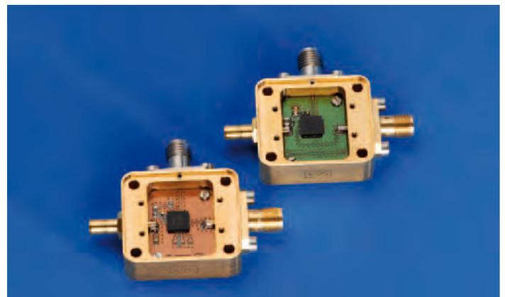
*Für diesen 15-GHz-Treiberchip wurde das optimale Leiterplattenlayout experimentell mit dem LPKF ProtoLaser S ermittelt. Abgebildet sind die Testplatine (links) und das kommerzielle Endprodukt. (Foto: Fraunhofer)*
