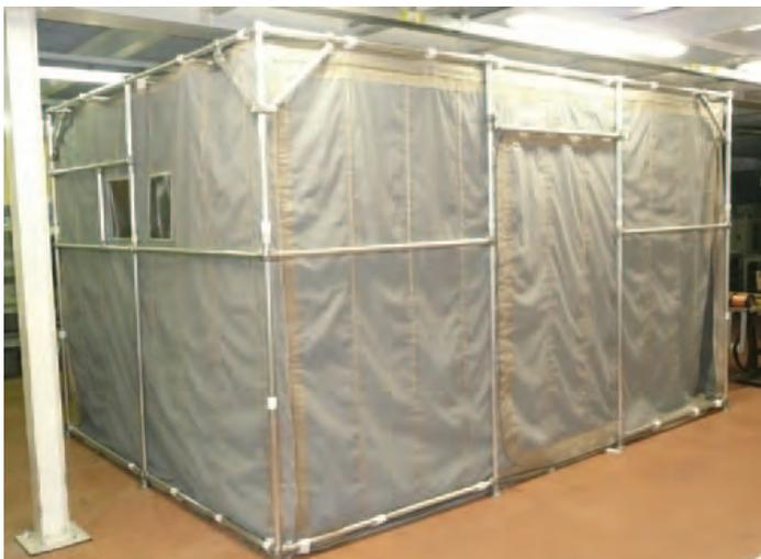
**Bild 5+6: Links das EMV-Zelt mit Rahmenkonstruktion, rechts zum Abhängen mit Bodenplatten**
