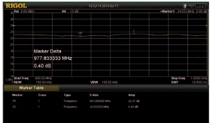
Bild 2 zeigt den Bereich von 900 MHz bis 1 GHz. Die Varianz (Max zu Min) der Verstärkung liegt 0.4dB
