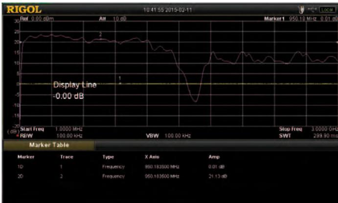
Bild 1 zeigt den gesamten Bereich bis 3 GHz. Bis ca. 1.2 GHz liegt die Verstärkung bei einem Wert größer 20dB
