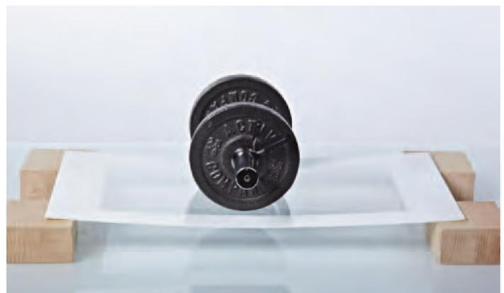
**Bild 5: Das Glas selbst ist relativ flexibel, es lässt sich sogar einige Millimeter durchbiegen.**
