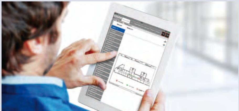
werden, was Zeit und somit Kosten spart. Sobald ein Objekt mit ERA ausgerüstet ist, kann auch die zuständige Feuerwehr einen Zugang zu den bereitgestellten Informationen erhalten. Die Vorteile liegen auf der Hand: Über die Web-Schnittstelle werden die Alarmdaten auf einem mobilen Endgerät visualisiert. Schon auf der Fahrt zum Einsatzort können die Einsatzleiter ermitteln,
