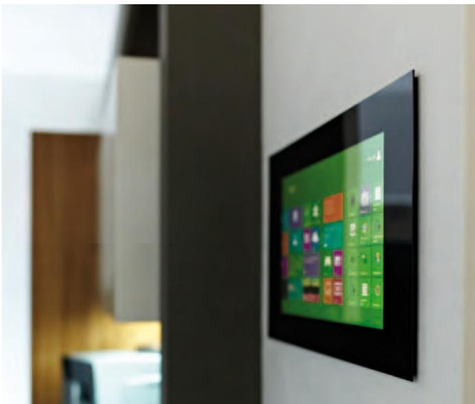
**Bild 4: Die Scheibe ragt nur maximal zwei Millimeter hervor, dadurch ergibt sich eine Optik wie ein flach gerahmtes Bild.**
