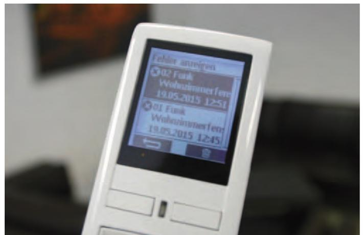
**Einer für alles: Mit dem commeo Multi Send wurde im Neuenrader Testhaus nicht nur alle bidirektionalen Funk-Antriebe eingelernt, sie werden mit diesem Handsender (20 Kanäle mit Zeitschaltuhren) auch komfortabel gesteuert. Das große Display zeigt zudem an, ob die Rollläden wie gewünscht zugefahren sind oder ob und wo genau es etwaige Fehler gab. Hier im Foto zu sehen: eine Fehlermeldung für das Wohnzimmerfenster.**
