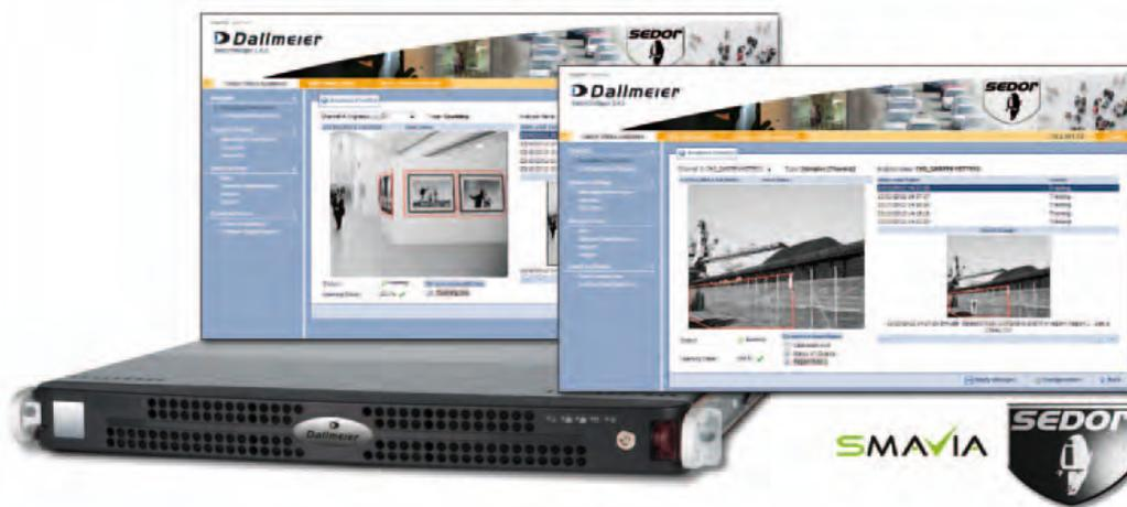
Der DVS 2200 IPS ist eine hochqualifizierte Server Appliance für die Analyse von bis zu zwölf IP-VideoKanälen und die Aufzeichnung von bis zu 24 IP-VideoKanälen. Sowohl die Analysesoftware (DVS Analysis Server) als auch die Aufzeichnungssoftware (Sma via Recording Server) sind bereits ab Werk installiert und können bequem via Ethernet mit einem Browser konfiguriert werden.
