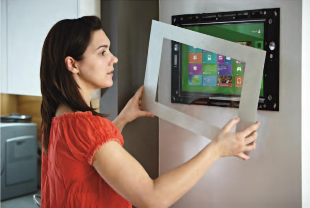
**Bild 1:** Bei Beschädigung oder auch Nichtgefallen kann die Frontscheibe als komplett eigenständige Baugruppe schnell gewechselt werden (Bilder PEAKnx).
