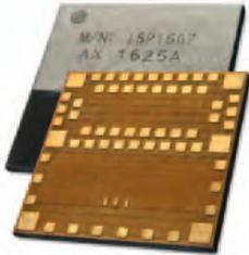
Der Erfolg des Bluetooth-Smart-Moduls ISP130301 veranlasste die Entwickler von tekmoduls Partner InsightSiP dazu, einen großen Schritt weiterzugehen. Mit dem neuen ISP1507 wird die neuste Bluetooth-Technologie in einem ultra-kleinem Package inklusive Antenne, Quarzen und M4-Prozessor angeboten.
