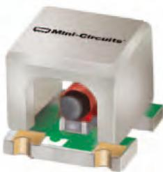
Soll z.B. ein LNA einer Satellitenanlage über das Koaxialkabel versorgt werden, so wird ein DC Bypass oder eine „Kabelweiche“ benötigt. Diese hat zwei Aufgaben: DC-Trennung im Signalpfad und signal-Abblockung gegenüber der Versorgungsquelle. Somit genügen zwei Bauelemente: ein Kondensator und eine Drossel. Diese befinden sich meist in einem schirmenden Gehäuse. Der SMT-Baustein TCBT-123+ von Mini-Circuits ist für 50-Ohm-Systeme im Frequenzbereich 10 MHz bis
