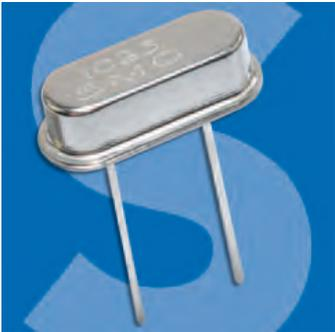
Mit der Serie IC23 von Red Frequency bietet Schukat 29 Typen bedrahteter Quarze in der Gehäusebauform HC-49US an. Sie umfassen alle gängigen Frequenzen von 3,579545 bis zu 32 MHz. Neben einem attraktiven Preis/Leistungs-Verhältnis zeichnen sich die Quarze durch hohe Qualität und beste elektrische Eigenschaften aus. Ausgesuchte Rohstoffe, sorgfältige Fertigungsverfahren und eine strikte Qualitätskontrolle
