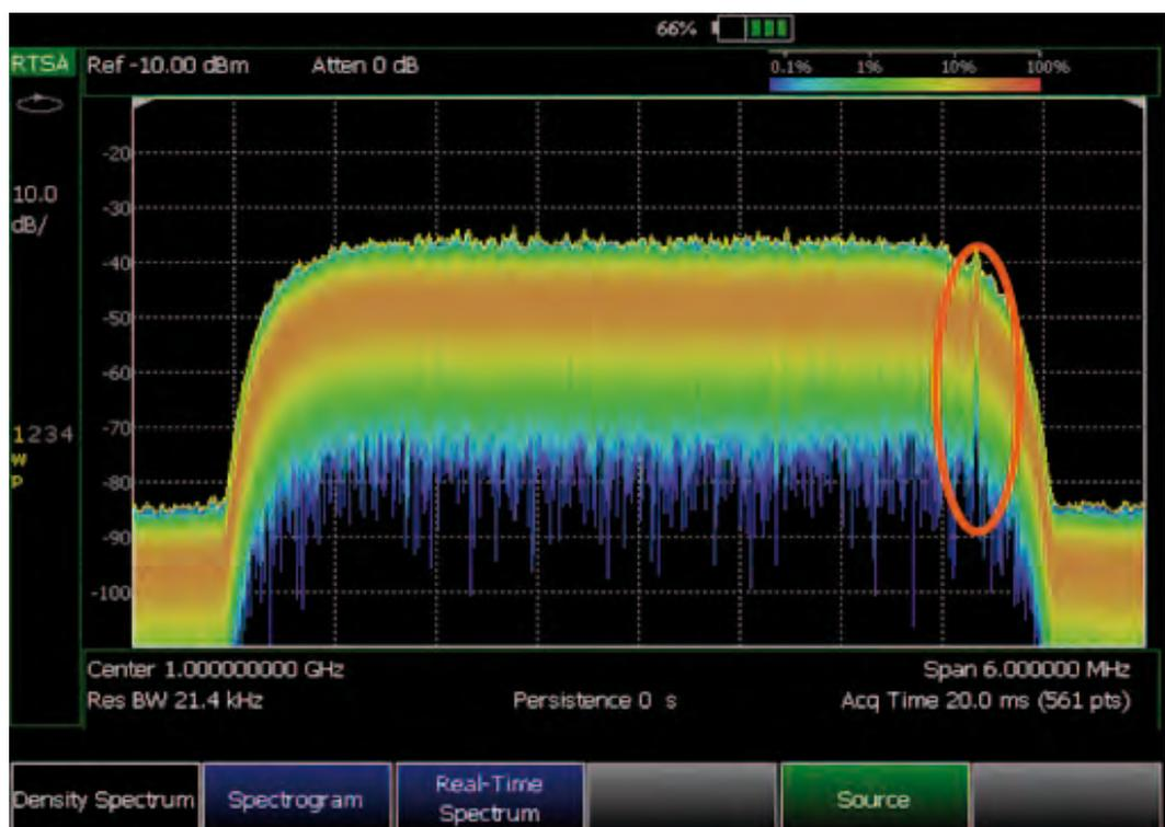
**Bild 4:** Diese Messung macht ein verdächtiges, schmalbandiges HF-Signal sichtbar (rotes Oval), das sich hinter einem W-CSMA-Trägersignal versteckt
